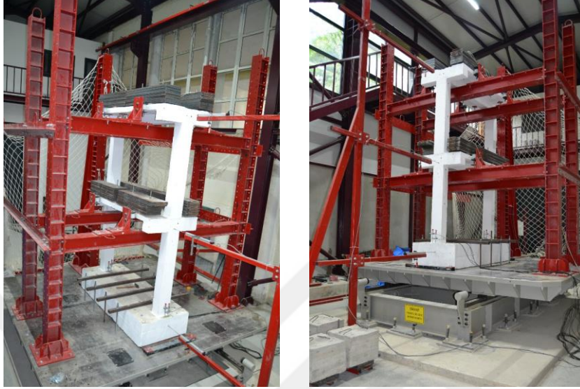
řekil 17. Sunca (2023) tarafından ger ekleřtirilen sarsma masası deneylerine ait g rseller
