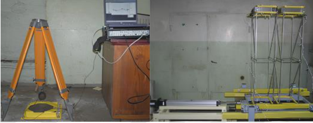
Şekil 12. Jankowski'nin (2010) gerçekleştirdiği serbest düşme ve sarsma masası deneylerine ait düzenekleri
