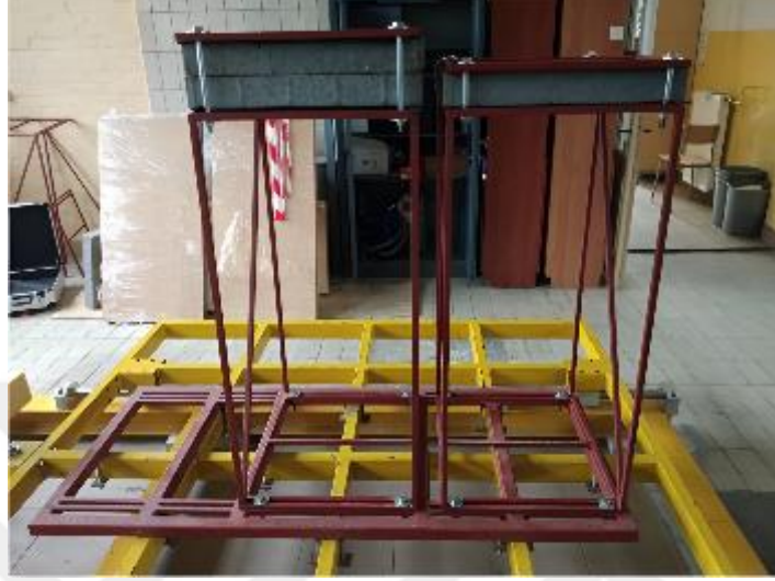
Şekil 16. Miari vd. (2022)'nin çarpışma deneyleri için geliştirdiği deney düzeneği
