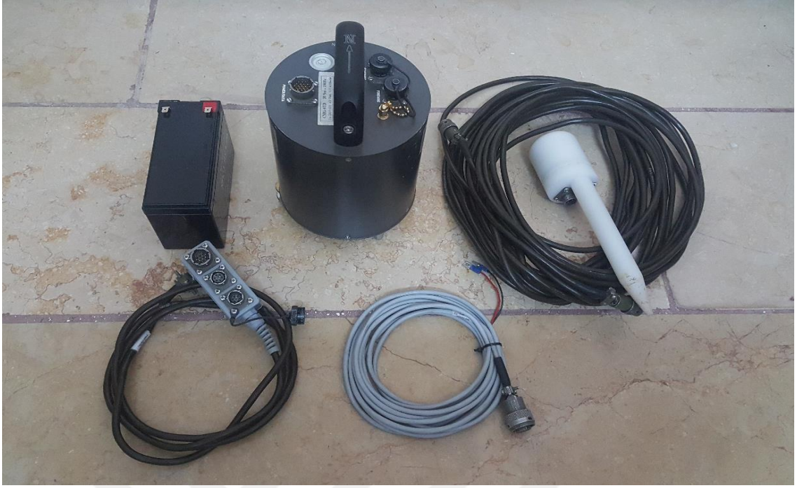
Görsel 5.3. Güralp CMG-6TD hızölçer ve diğer ekipmanlar (Kaplan, 2017)
