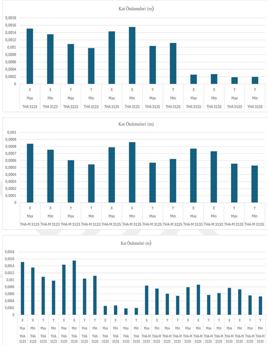
Şekil 6.7. Mevcut durum zemin kat THA3123, THA3125 ve THA3133 deprem kayıtları için FX ve FY doğrultularında maksimum–minimum kat ötelemesi karşılaştırılması, ölçeklendirilmiş kayıtlar, gerçek kayıtlar, gerçek ve ölçeklendirilmiş kayıtların birlikte karşılaştırılması
