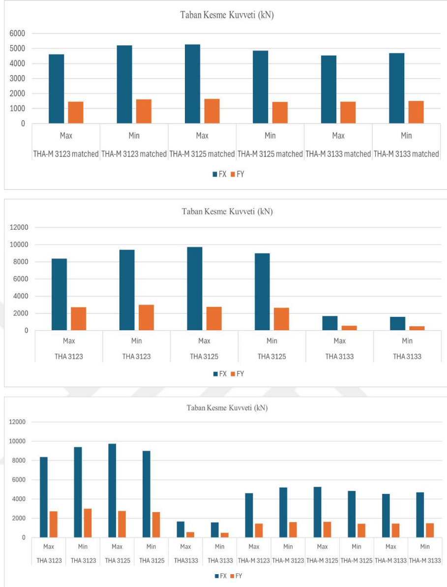
Şekil 6.4. Mevcut durum THA3123, THA3125 ve THA3133 deprem kayıtları için FX ve FY doğrultularında maksimum–minimum taban kesme kuvvetlerinin karşılaştırılması, ölçeklendirilmiş kayıtlar, gerçek kayıtlar, gerçek ve ölçeklendirilmiş kayıtların birlikte karşılaştırılması
