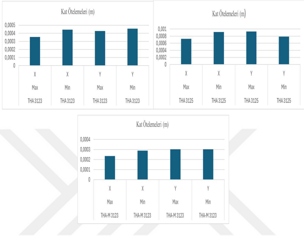
Şekil 6.24. Güçlendirilmiş durum 2.Kat THA3123, THA3125 ve THA3133 deprem kayıtları için X ve Y doğrultularında maksimum–minimum kat ötelemeleri
