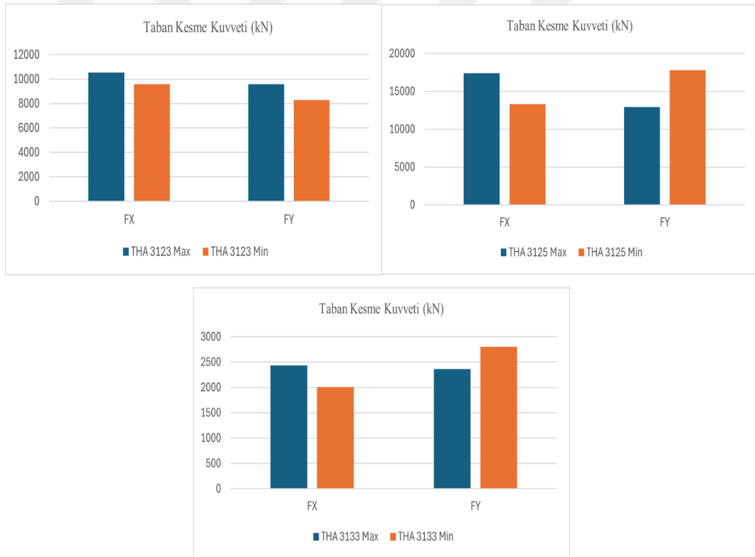
Şekil 6.15. Güçlendirilmiş durum THA3123, THA3125 ve THA3133 deprem kayıtları için Fx ve Fy doğrultusunda maksimum ve minimum taban kesme kuvvetleri
