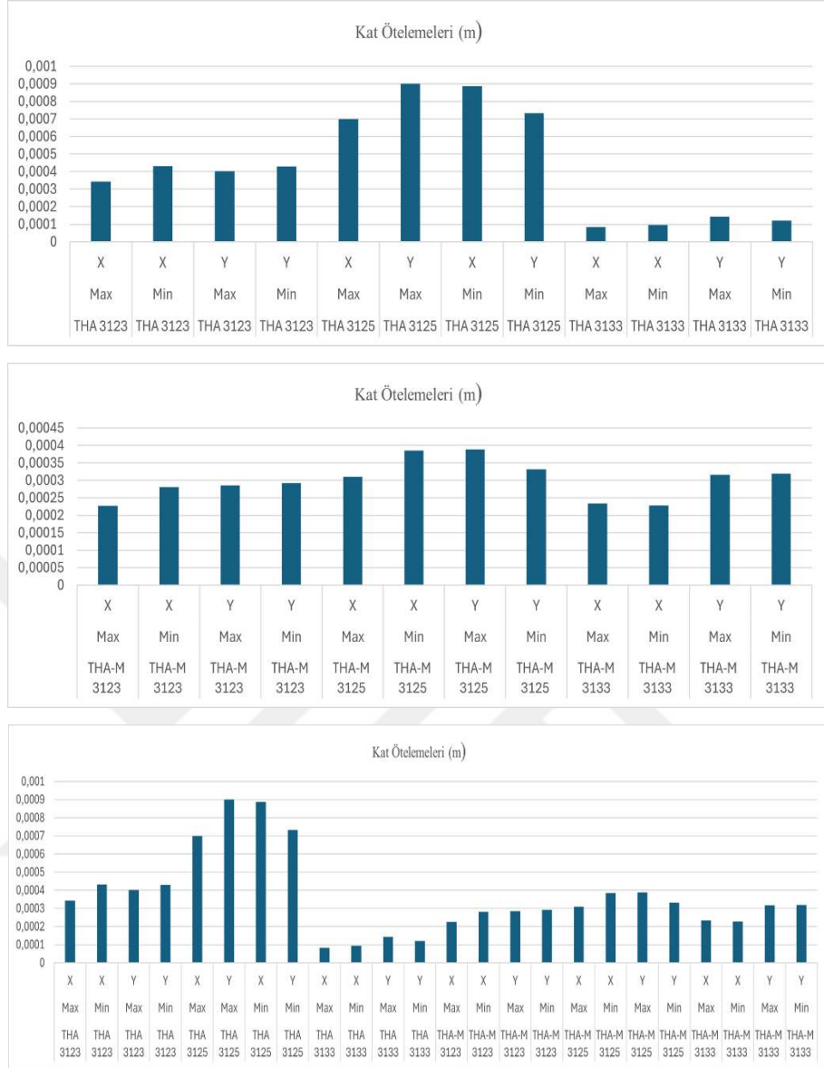
Şekil 6.23. Güçlendirilmiş durum 1.Kat THA3123, THA3125 ve THA3133 deprem kayıtları için FX ve FY doğrultularında maksimum–minimum kat ötelemesi karşılaştırılması, ölçeklendirilmiş kayıtlar, gerçek kayıtlar, gerçek ve ölçeklendirilmiş kayıtların birlikte karşılaştırılması
