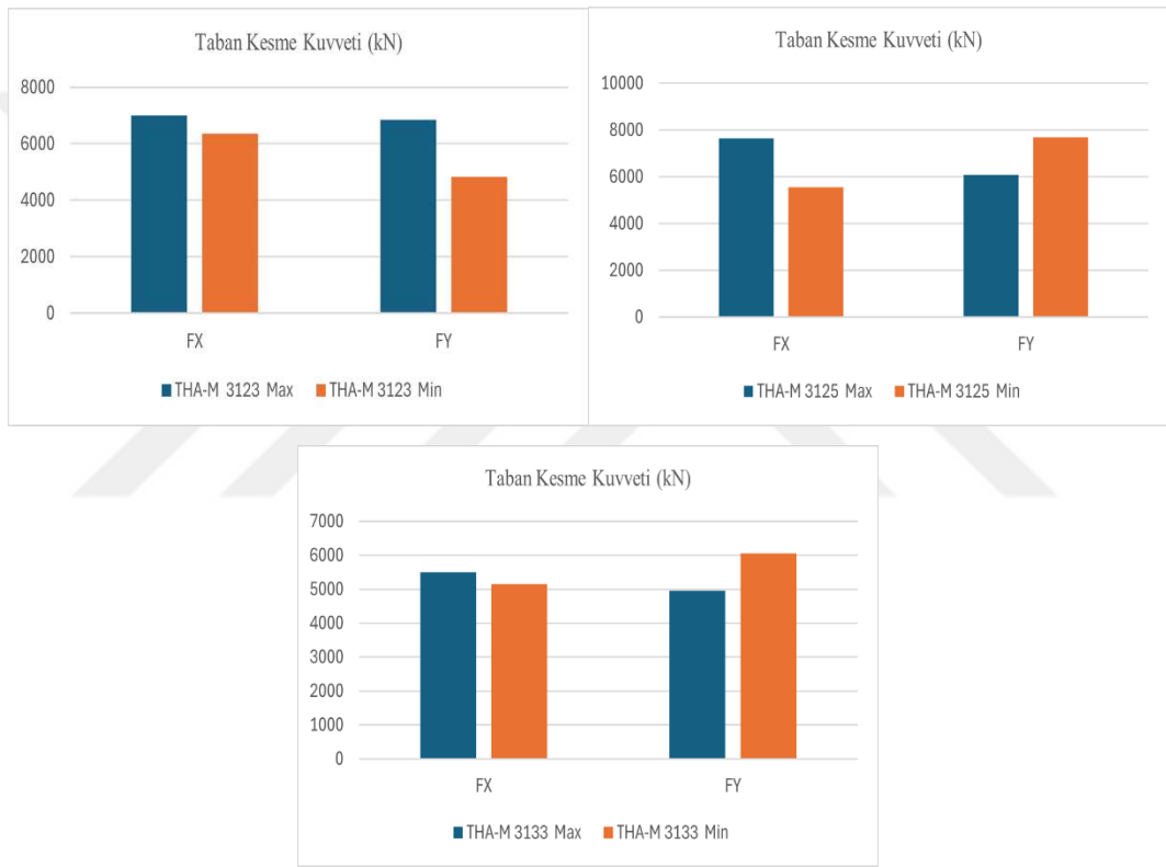
Şekil 6.16. Güçlendirilmiş durum THA-M 3123, THA-M 3125 ve THA-M 3133 deprem kayıtları için Fx ve Fy doğrultusunda maksimum ve minimum ölçeklendirilmiş taban kesme kuvvetleri
