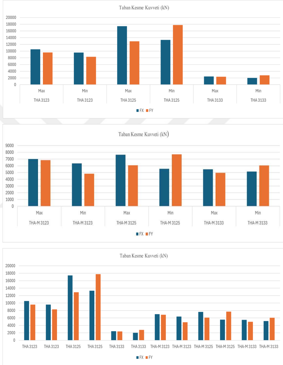
Şekil 6.17. Güçlendirilmiş durum THA3123, THA3125 ve THA3133 deprem kayıtları için FX ve FY doğrultularında maksimum–minimum taban kesme kuvvetlerinin karşılaştırılması, ölçeklendirilmiş kayıtlar, gerçek kayıtlar, gerçek ve ölçeklendirilmiş kayıtların birlikte karşılaştırılması
