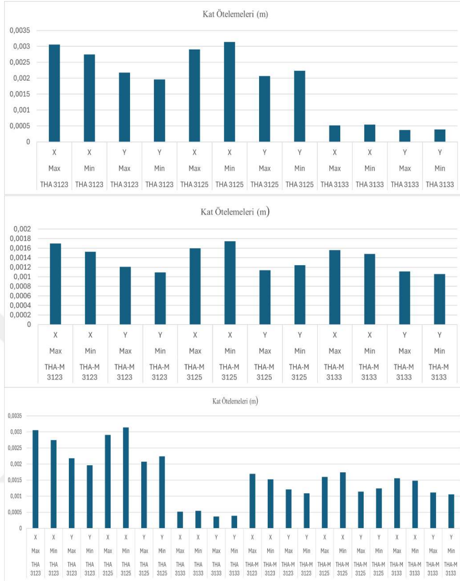
Şekil 6.10. Mevcut durum 1.Kat THA3123, THA3125 ve THA3133 deprem kayıtları için FX ve FY doğrultularında maksimum–minimum kat ötelemesi karşılaştırılması, ölçeklendirilmiş kayıtlar, gerçek kayıtlar, gerçek ve ölçeklendirilmiş kayıtların birlikte karşılaştırılması
