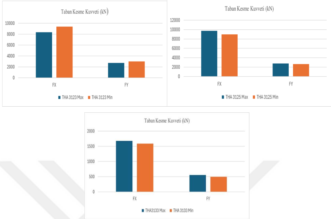
Şekil 6.2. Mevcut durum THA3123, THA3125 ve THA3133 deprem kayıtları için Fx ve Fy doğrultusunda maksimum ve minimum taban kesme kuvvetleri
