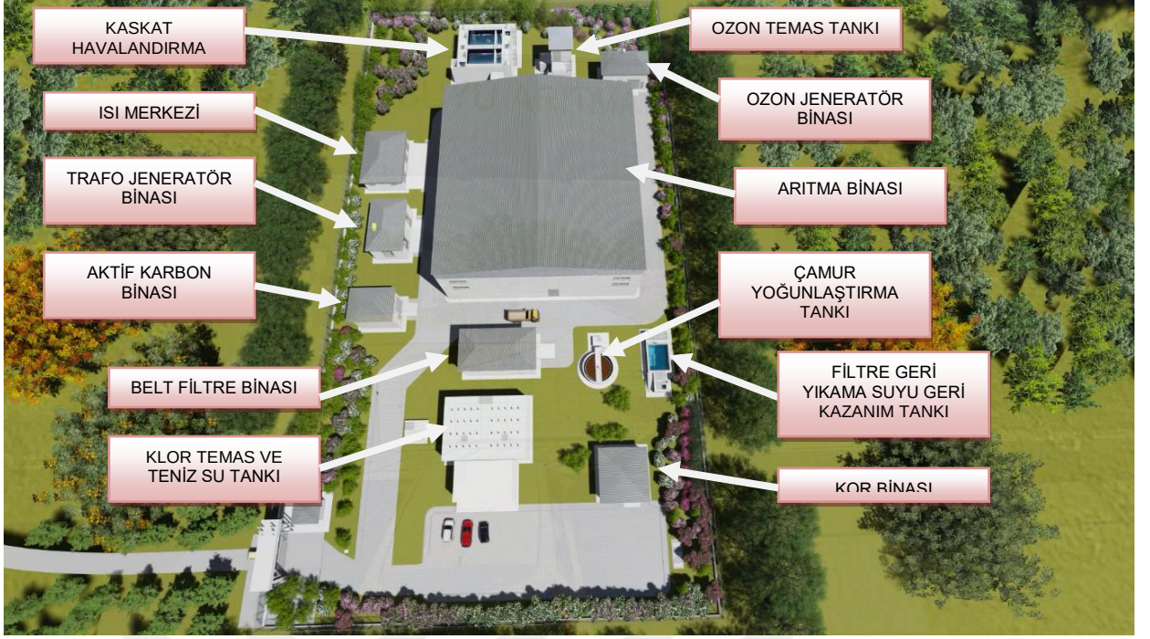
Şekil 14:Çelik Konstrüksiyon İçme suyu Arıtma Tesisi Genel Görünümü
