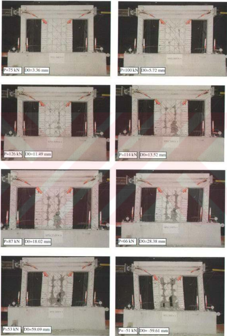
Şekil 5.45. Deney Elemanı 8'in test sırasında fotoğrafları
