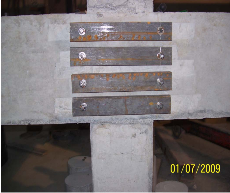
Resim 3.37. C1, C2, F1 ve G2 güçlendirmelerinin dış cepheden görünüşü
