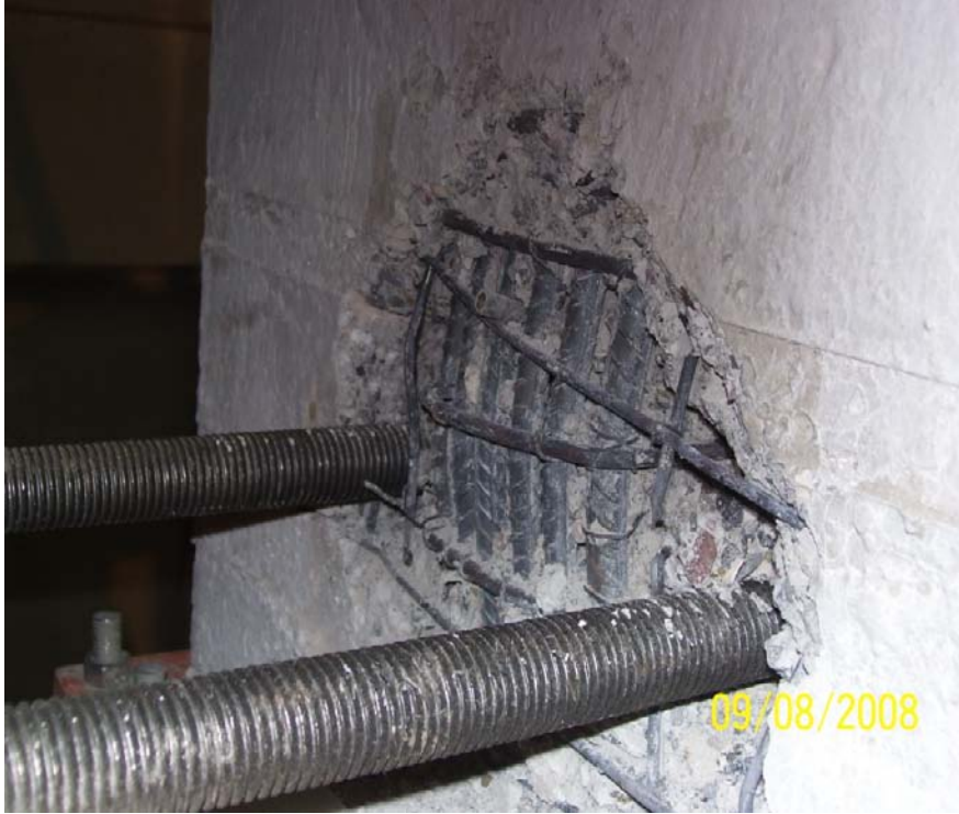
Resim 3.9. RC2 elemanı kiriş üst donatılarının burkulması
