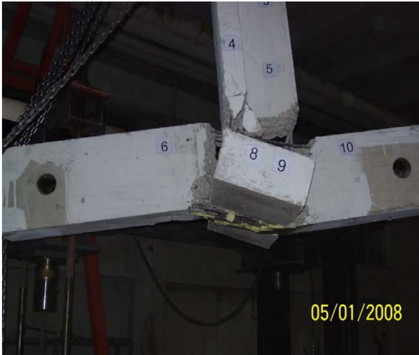
Resim 3.10. WJ1 elemanının deney tamamlandıktan sonraki son durumu
