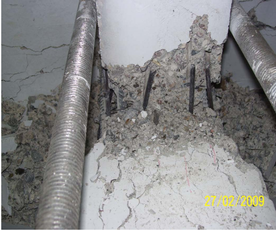
Resim 3.29. D2 elemanında kiriş alt yüzünden çıkan U etriye kol uçları
