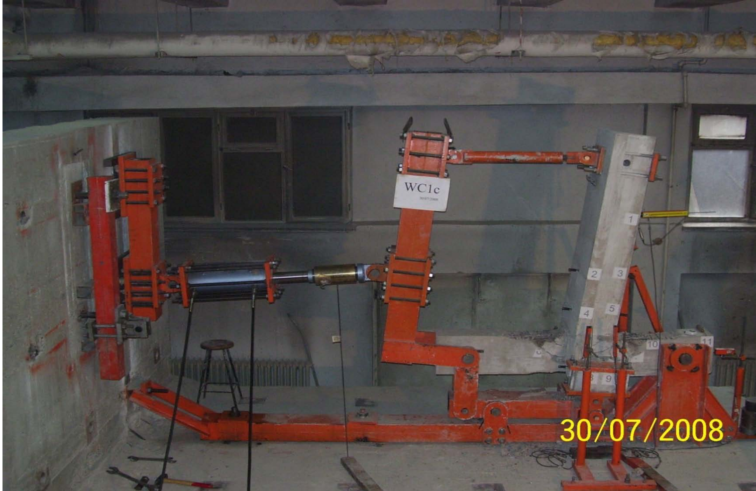
Resim 4.9. WC1c deneyinde alt kolon düğüm ve üst kolonda oluşan hasarlar
