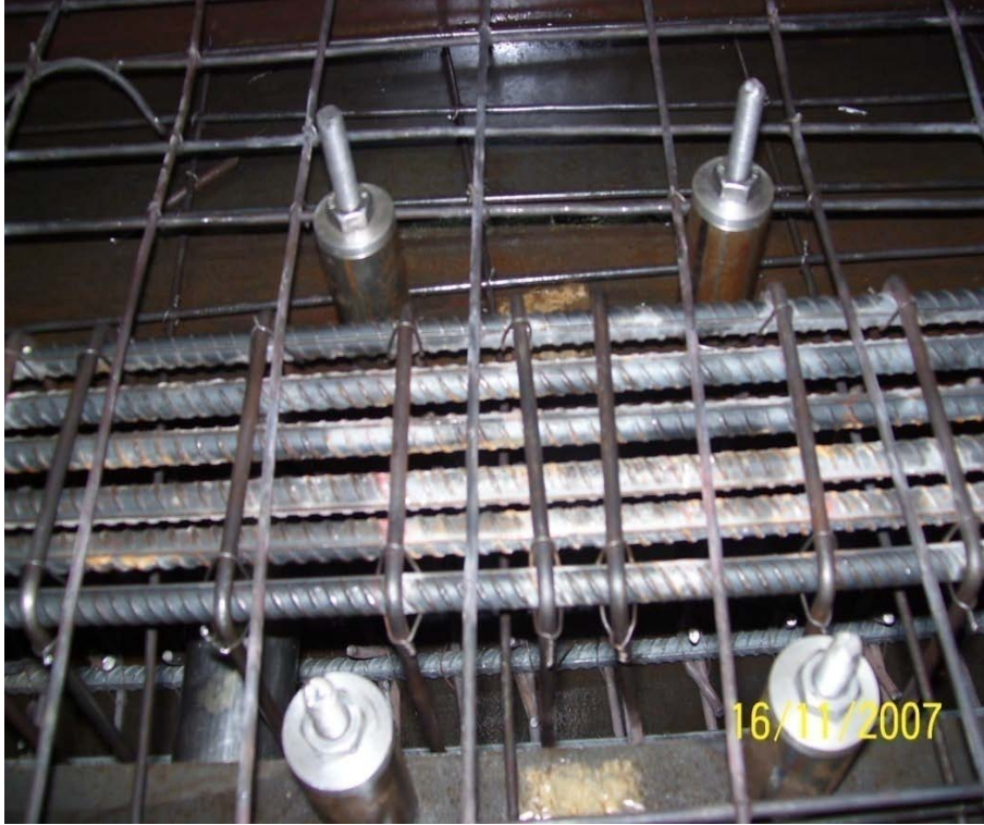
Resim 3.3. Kirişi deney sistemine bağlamak amacıyla döşeme delikleri için aparatlar
