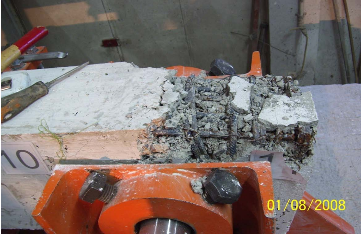
Resim 4.21. A1 elemanında sabit pim civarında oluşan hasar
