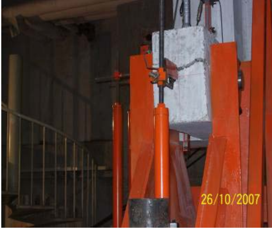
Resim 3.7. RC1 elemanında sabit pim deliği civarında alt kolondaki yarıma
