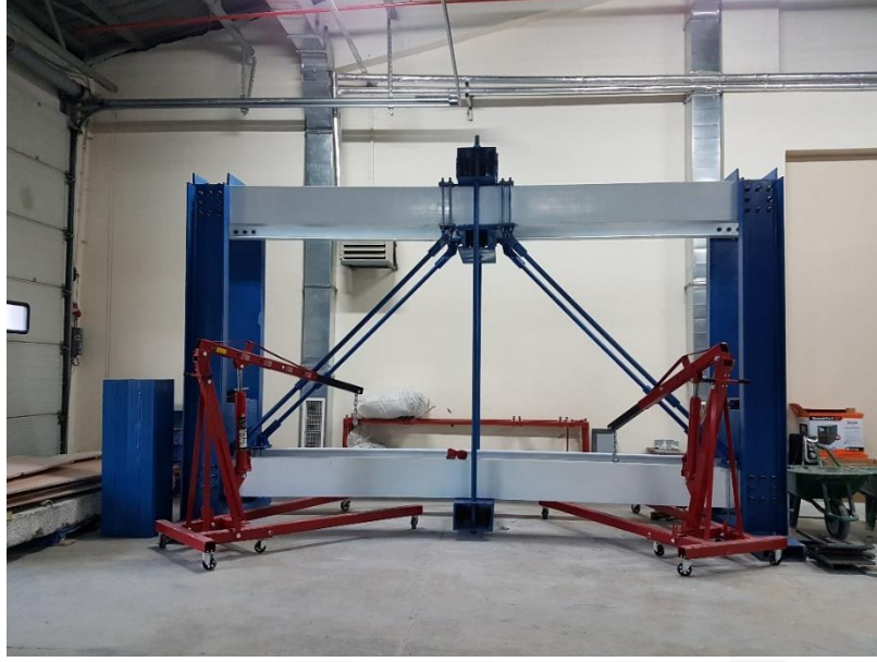
Şekil 3.31. Yükleme çerçevesi ve portatif vinçlerin genel görünümü
