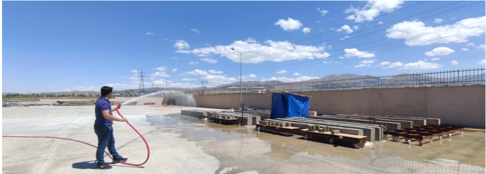
Şekil 3.18. Betonarme kiriş numunelerin nemli tutulma işlemi
