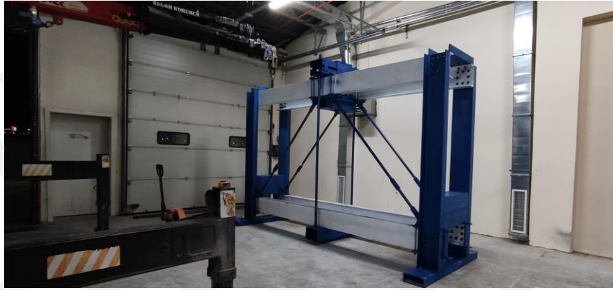
Şekil 3.30. Yükleme çerçevesinin deneysel çalışma alanına yerleştirilmesi
