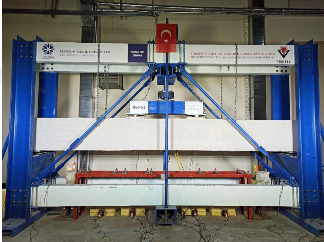
Şekil 7. BS0-S2 kirişi deney öncesi görünümü
