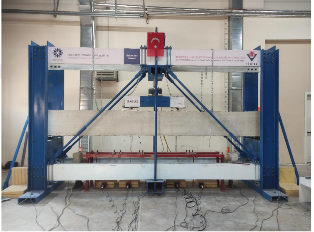
Şekil 13. BS0-S3 kirişi deney öncesi görünümü
