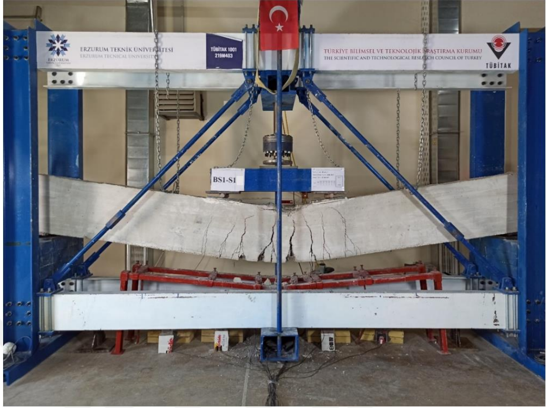
Şekil 22. BS1-S1 kirişi deney sonrası görünümü
