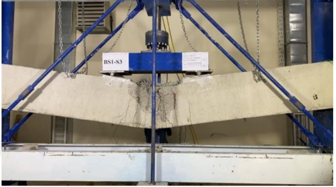
Şekil 52. BS1-S3-2 kirişi deney sonrası görünümü
