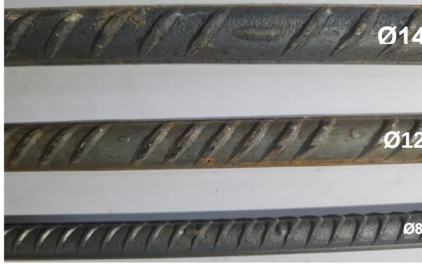
Şekil 4.12. Ø8, Ø12 ve Ø14 donatı çubukları nervür detay görüntüleri
