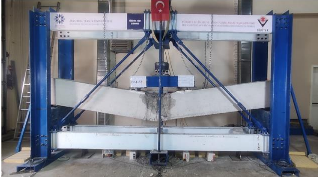
Şekil 28. BS1-S2 kirişi deney sonrası görünümü
