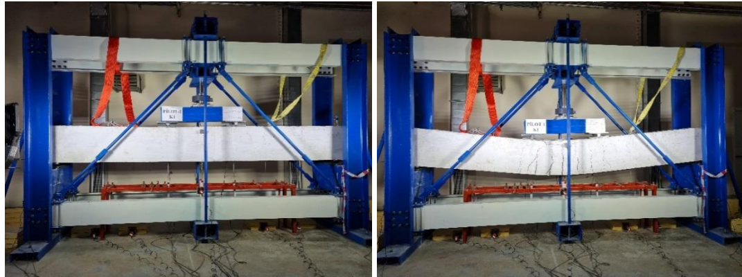
Şekil 3.42. PİLOT-1 numunesinin, (a) Deney öncesi görüntüsü, (b) Deney sonu görüntüsü.
