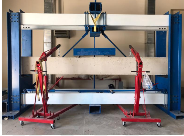
Şekil 3.40. Betonarme pilot kiriş numunelerinin yükleme düzeneğine alınması işlemine ilişkin genel görünümü.
