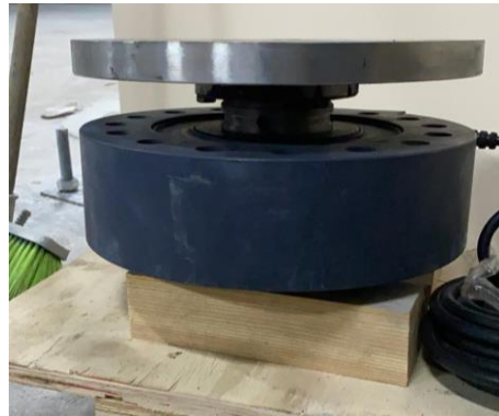
Şekil 3.34. Yük ölçümünde kullanılan CAS marka yassı yük hücresi
