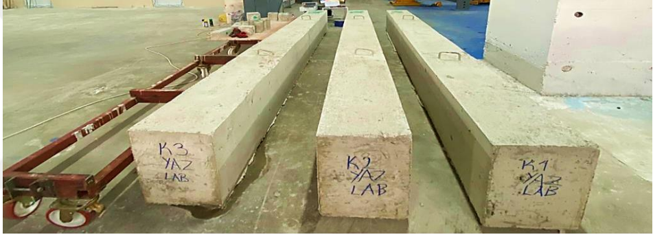
Şekil 3.17. Laboratuvar koşullarında bekletilen betonarme kirişler
