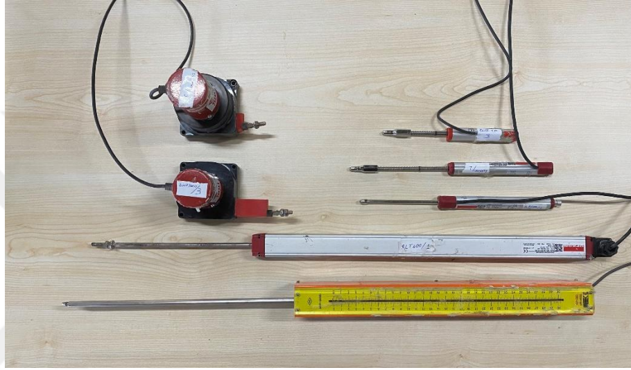
Şekil 3.35. Deformasyon ölçümlerinde kullanılan sensörlerin genel görünümü
