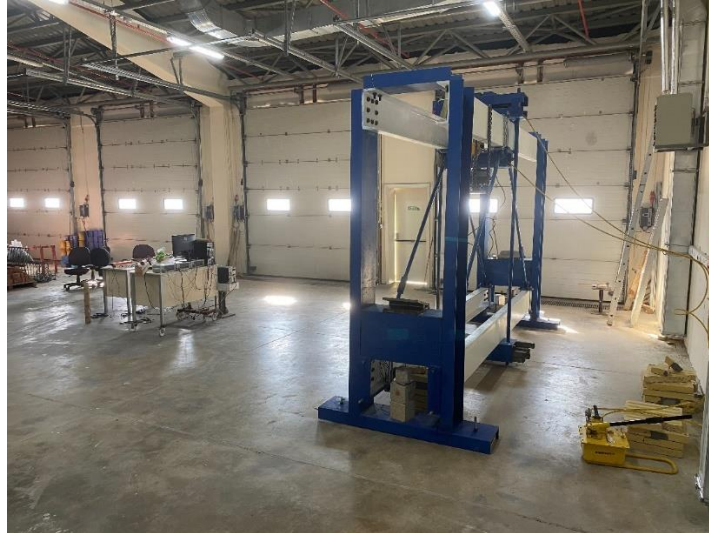
Şekil 3.38. Yükleme çerçevesi ve veri toplama sisteminden oluşan deney düzeneği
