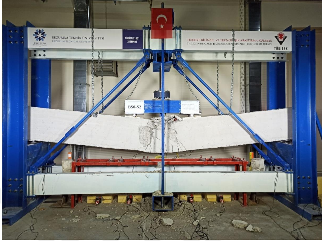
Şekil 10. BS0-S2 kirişi deney sonrası görünümü
