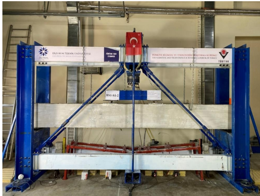
Şekil 19. BS1-S1 kirişi deney öncesi görünümü.
