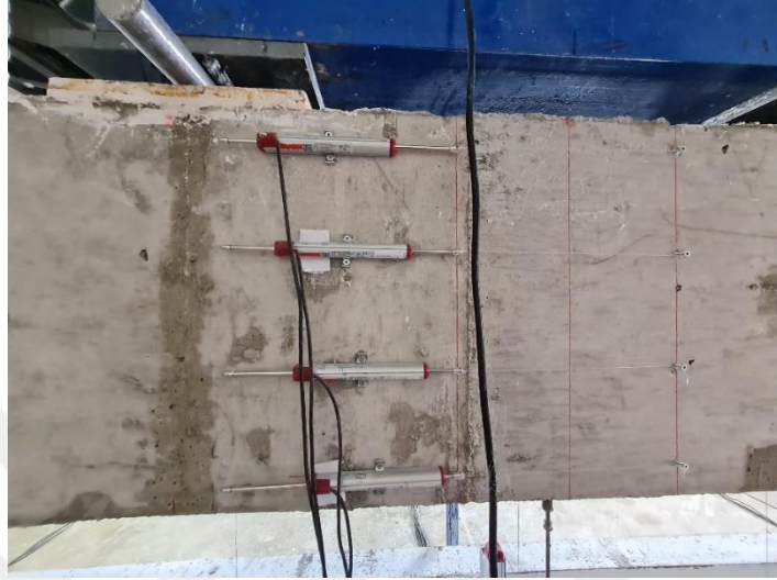
Şekil 3.49. Eğrilik hesaplamalarında kullanılacak yatay deformasyon sensörlerinin yerleşimi.
