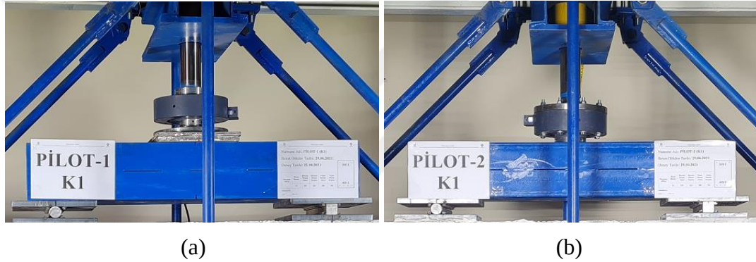
Şekil 3.43. Yükleme mekanizması yapılan değişiklik, (a) PİLOT-1 deney sırasında yük hücresi aktarma mekanizması, (b) PİLOT-2 deney sırasında yük hücresi aktarım mekanizması.
