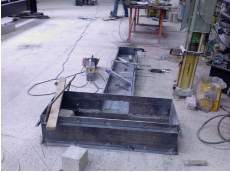
Resim 3.1. Elemanların üretildiği sac kalıp
