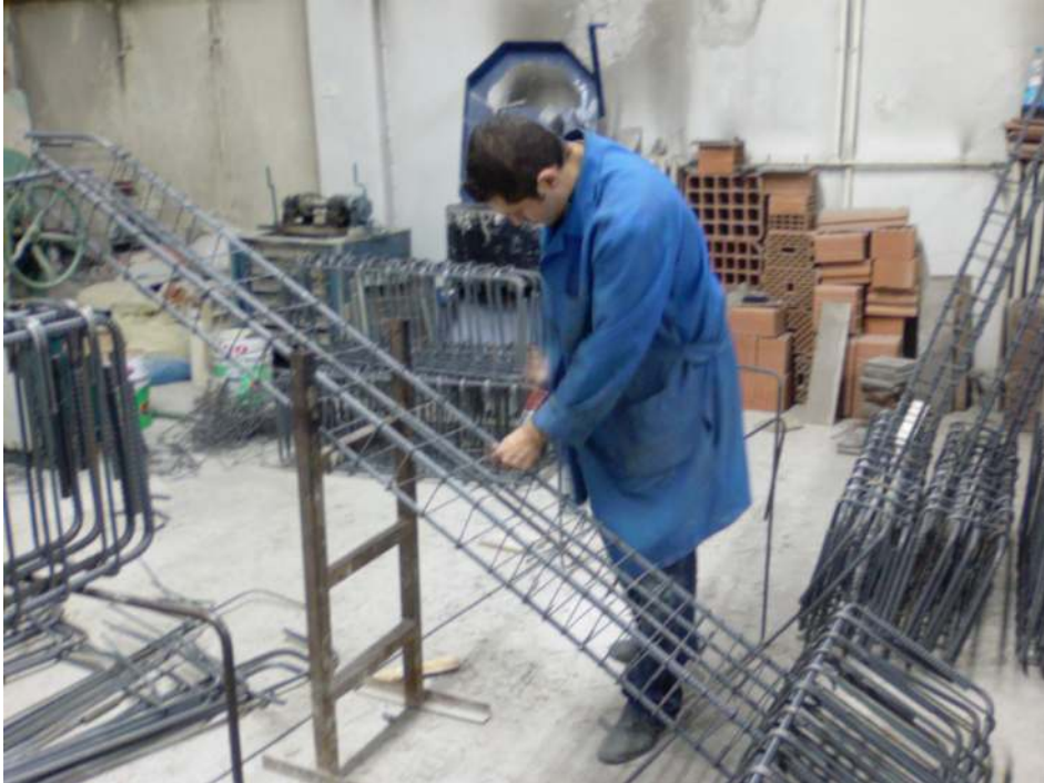
Resim 3.2. Elemanların donatıları hazırlanması
