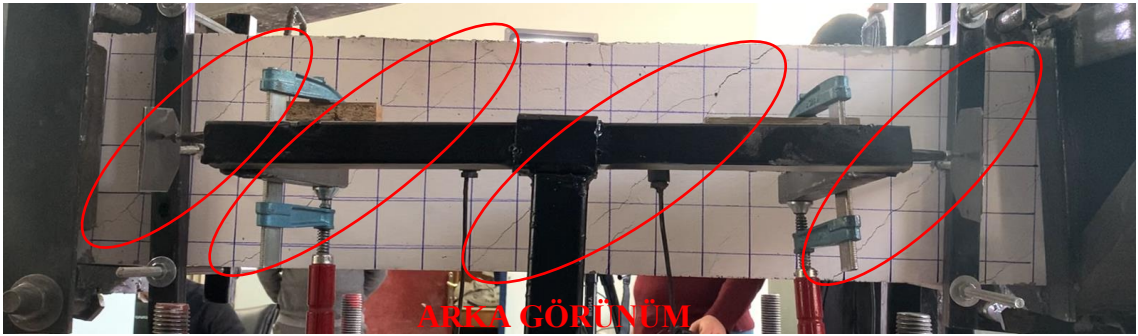
Şekil 4.81. BK-N-10-B numunesi maksimum burulma momenti ön ve arka yüzü için hasar durumu
