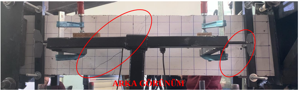
Şekil 4.41. BK-N-20-A numunesi maksimum burulma momenti ön ve arka yüzey için hasar durumu
