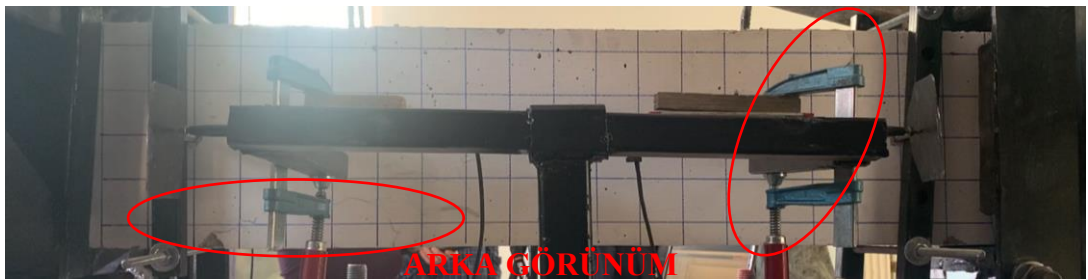
Şekil 4.8. BK-D-0-B numunesi ilk çatlak ve maksimum burulma momenti değerlerinde ön ve arka yüzey için hasar durumu
