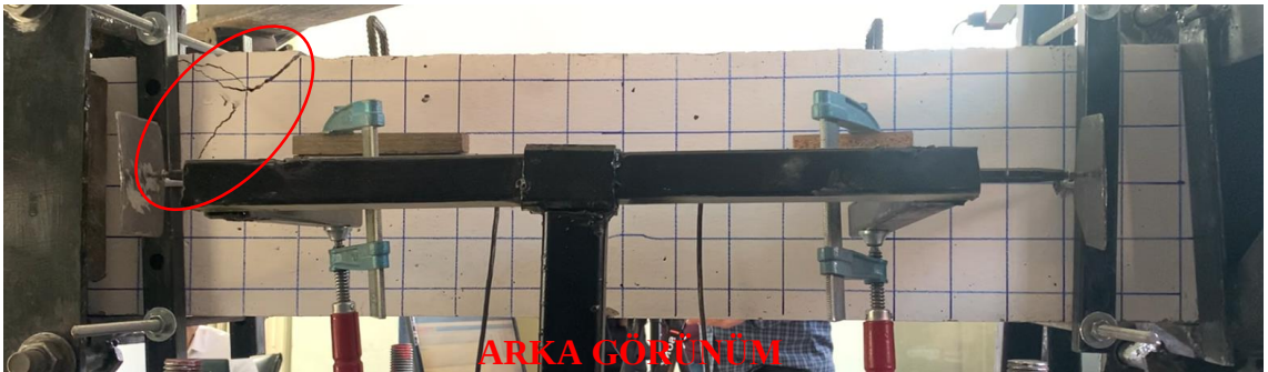
Şekil 4.2. BK-D-0-A numunesi ilk çatlak ve maksimum burulma momenti değerlerinde ön ve arka yüzey için hasar durumu
