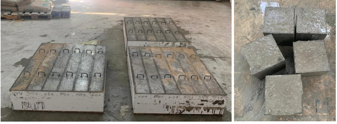
Şekil 3.9. Deney numunelerin ve küp numunelerin kür işlemi
