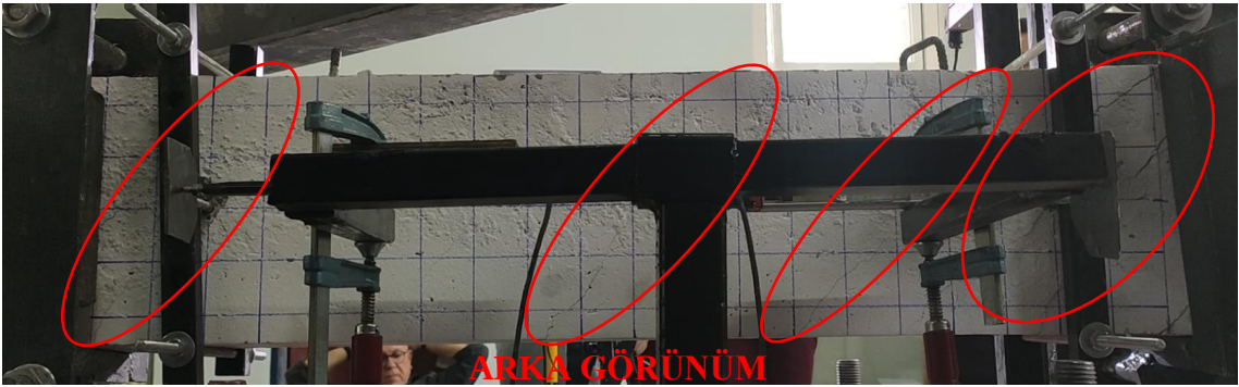
Şekil 4.89 BK-D-5-A numunesi maksimum burulma momenti hasar durumu
