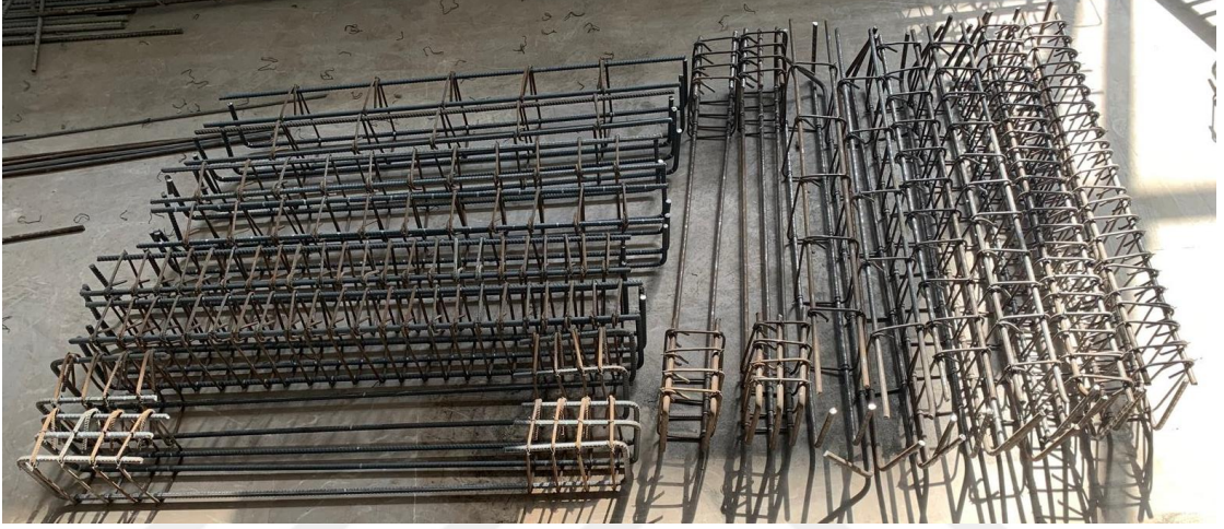
Şekil 3.5. Deney numunelerine ait donatı kafesleri
