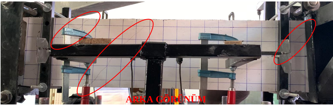
Şekil 4.57. BK-D-10-A numunesi maksimum burulma momenti ön ve arka yüzey için hasar durumu
