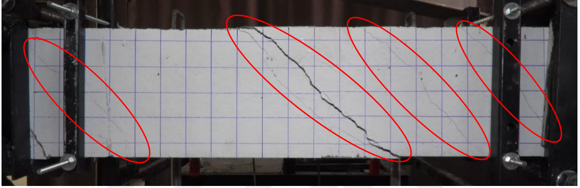
Şekil 4.58. BK-D-10-A numunesi göçme noktası değerinde hasar durumu
