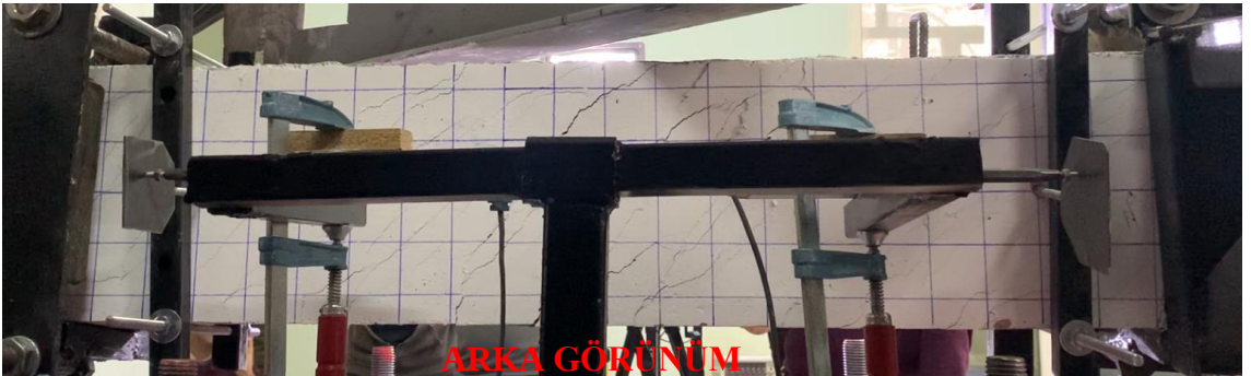
Şekil 4.113. BK-N-5-B numunesi maksimum burulma momenti ön ve arka yüzey için hasar durumu
