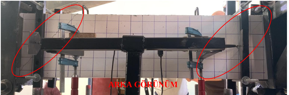
Şekil 4.65. BK-D-10-B numunesi maksimum burulma momenti hasar durumu
