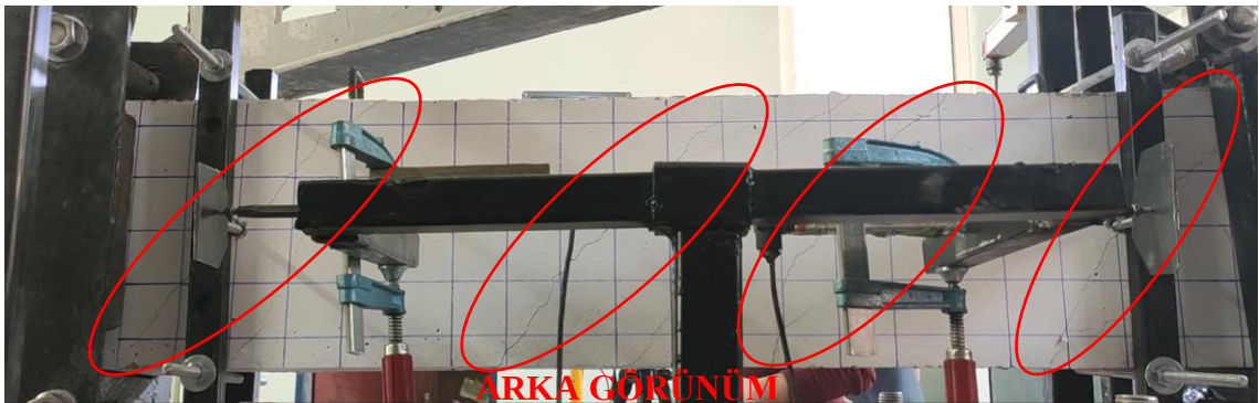
Şekil 4.73. BK-N-10-A numunesi maksimum burulma momenti ön ve arka yüzey için hasar durumu
