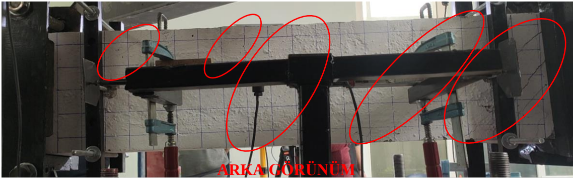
Şekil 4.97. BK-D-5-B numunesi maksimum burulma momenti ön ve arka yüzey için hasar durumu
