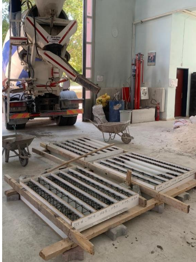
Şekil 3.7. Sipariş edilen betonun transmikser ile laboratuvara getirilmesi
