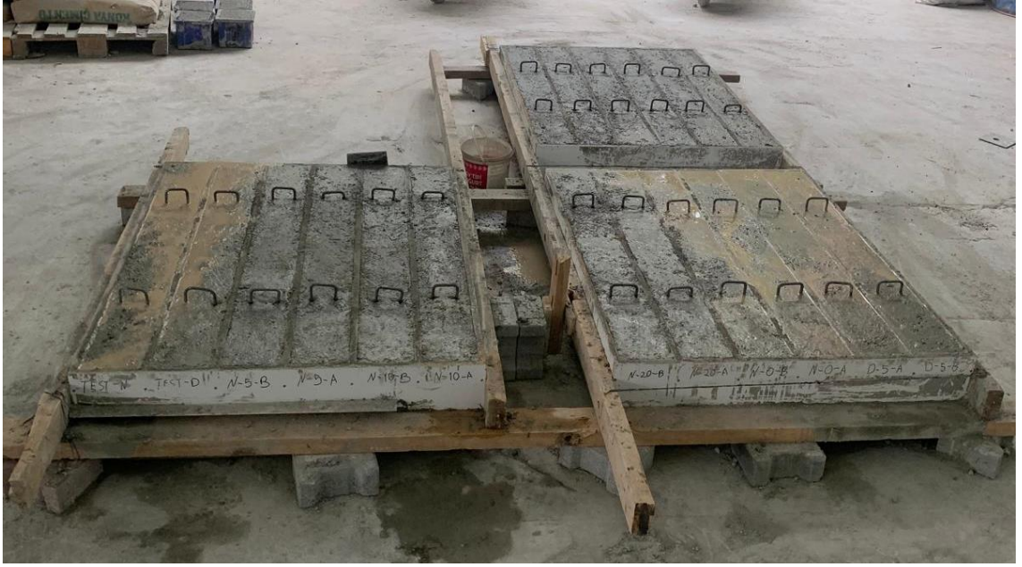
Şekil 3.8. Beton döküm işlemi sonrası deney numuneleri
