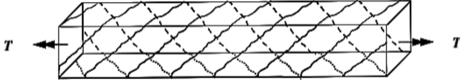
Şekil 1.1. Burulmada kesme çatlakları (Ersoy ve diğ., 2019)
