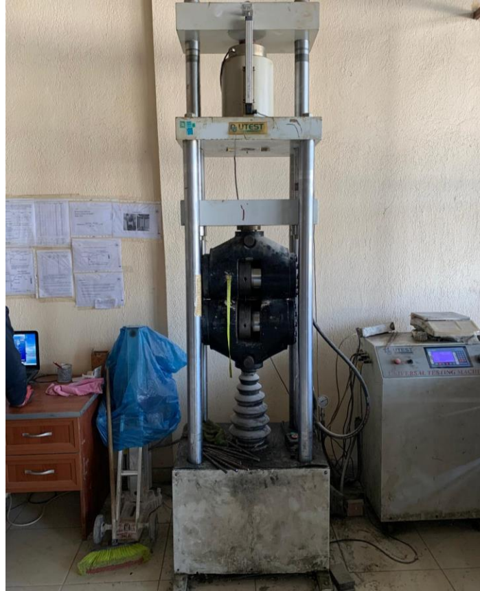
Şekil 3.4. Çelik çekme deney düzeneği
