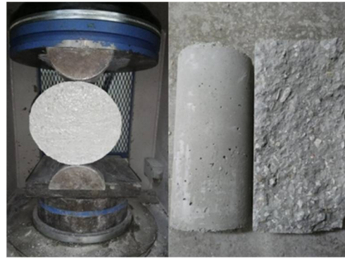
Şekil 3.8. Betonun yarmada çekme dayanımının belirlenmesi
