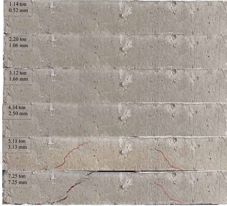
Şekil 4.7. RB15 referans kiriş numunesine ait çatlak oluşum aşamaları
