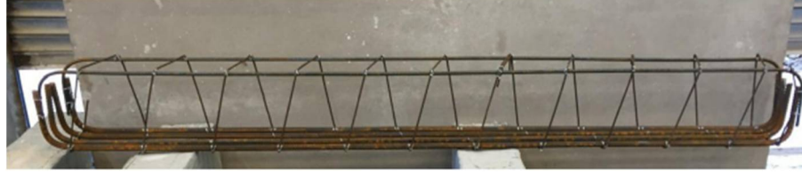
Şekil 2.4. Spiral etriye numunesi (Shatarat ve ark., 2016)
