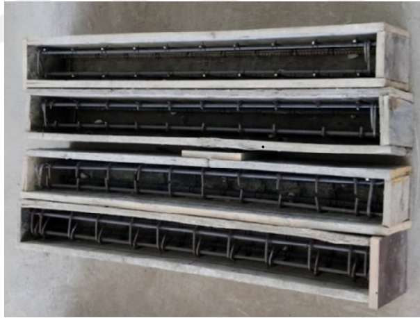
Şekil 3.2. Deney kirişlerinin kalıplarının hazırlanması
