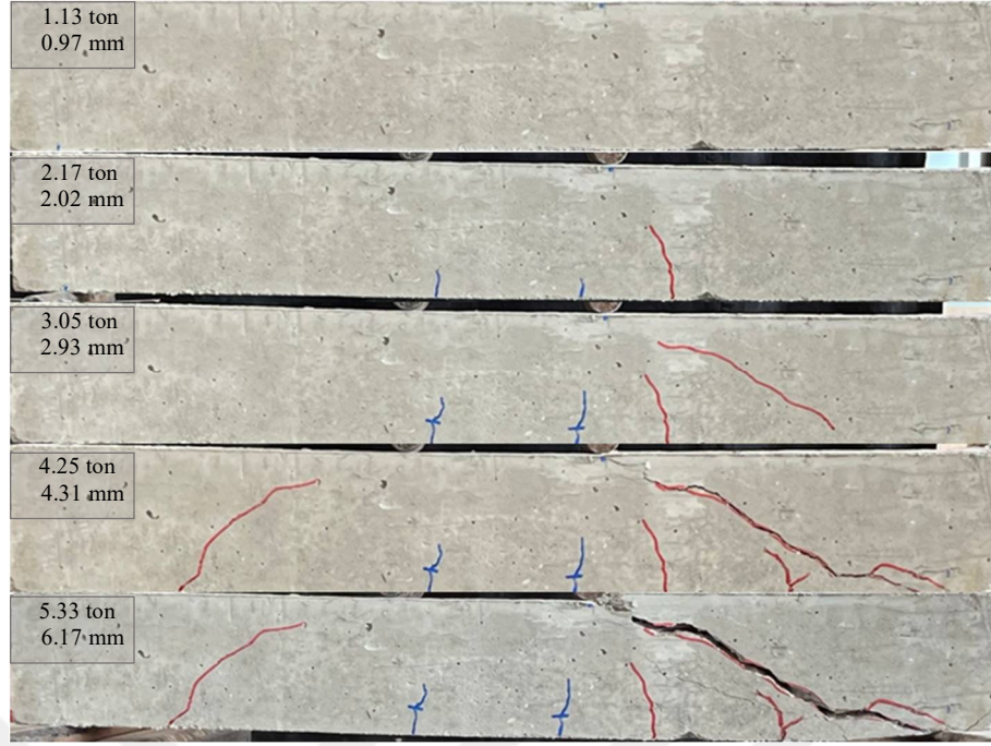
Şekil 4.52. S15 3.5 kiriş numunesine ait göçme sonrası hasar detayları
