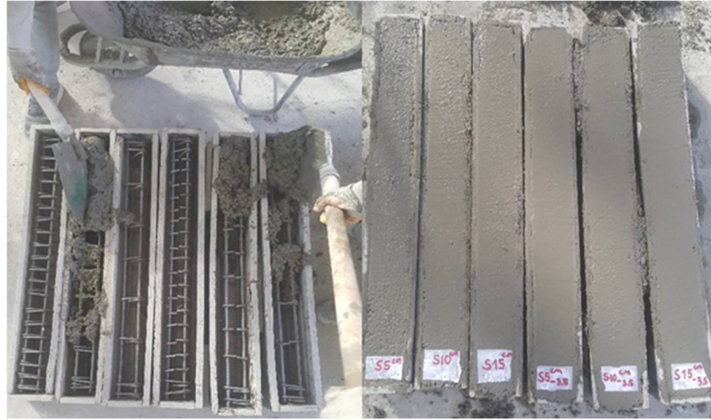
Şekil 3.5. Betonun kalıplara yerleştirilmesi
