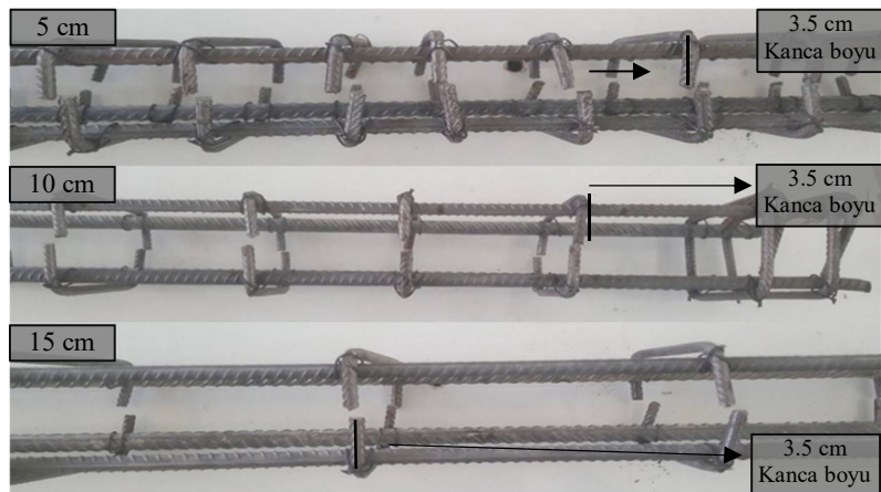
Şekil 3.11. 5, 10, 15 cm aralıklarla 3.5 cm kanca boyuna sahip etriye detayları
