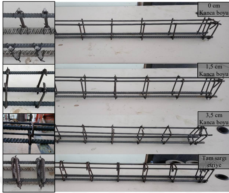
Şekil 3.9. Etriye kanca boyu donatı detayları
