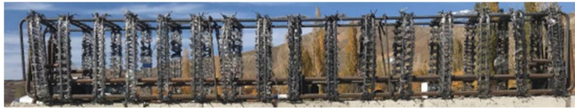
Şekil 2.9. Geogrid deney numunesi (Şavluk, 2019)
