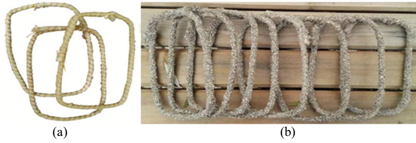
Şekil 2.8. (a) Nervürlü dikdörtgen etriyeler (b) Nervürlü-Kumlu dikdörtgen etriyeler (Kadı, 2019)
