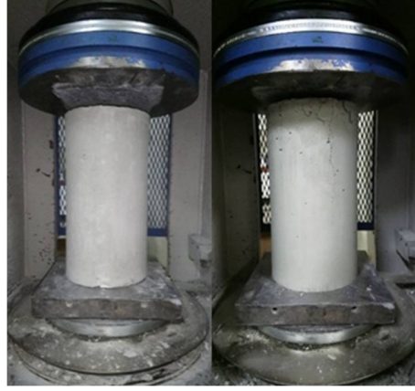
Şekil 3.7. Beton basınç dayanımının belirlenmesi
