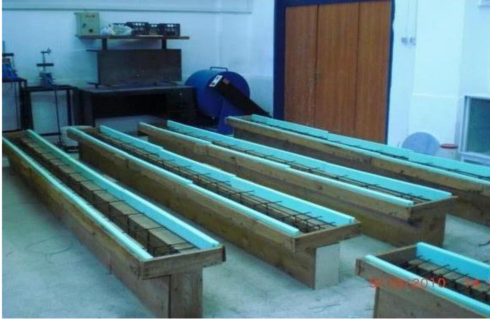
Resim 2.4. Beton dökümüne hazır deney elemanları
