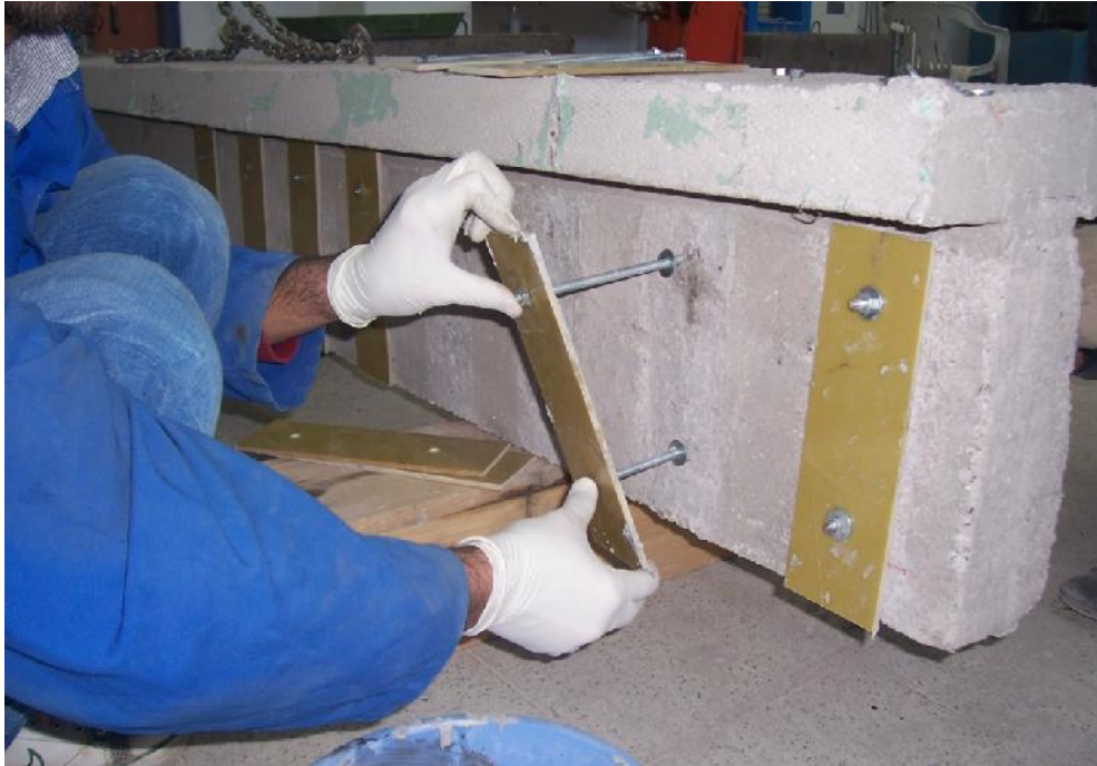
Resim 2.8. Kiriř yan yzeylerine yapıřtırılan GFRP řeritler
