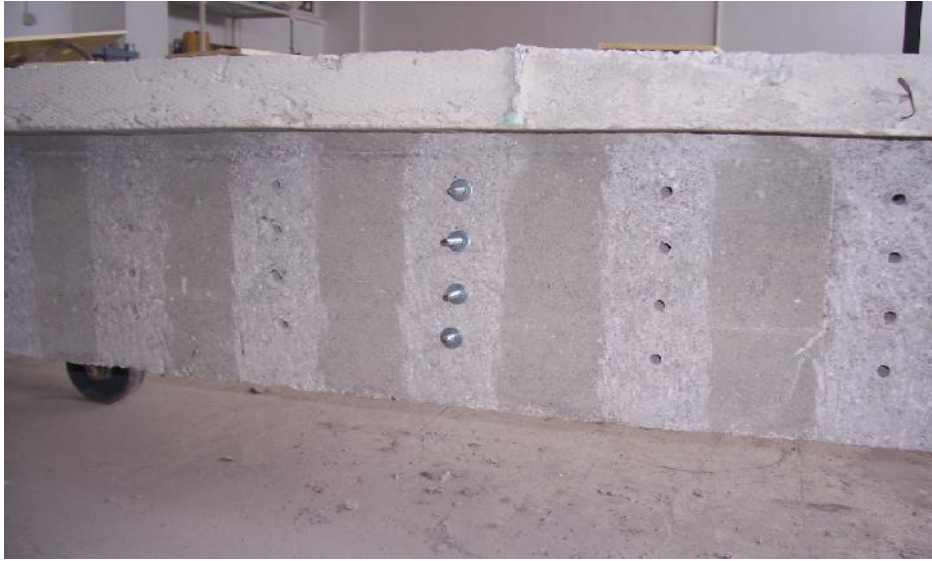
Resim 2.6. Beton deney elemanına yerleştirilen ankrajlar
