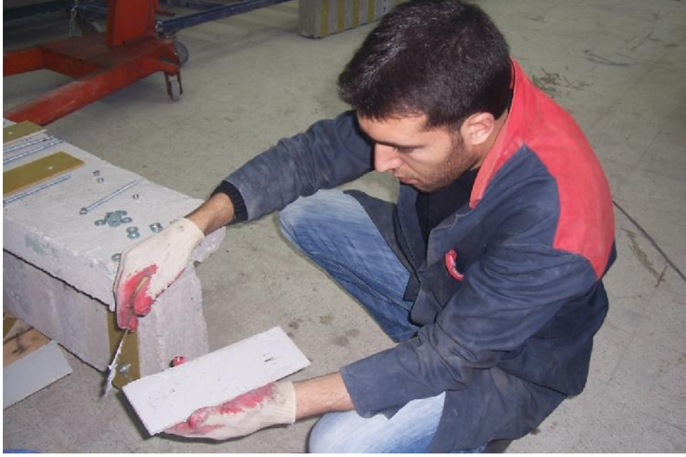
Resim 2.7. GFRP řeritlere Sikadur 31 epoksi yapıřtırıcı srlmesi
