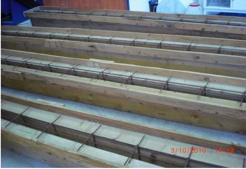
Resim 2.3. Donatı kafesi yerleştirilmiş deney elemanı 2,3,4 ve 5
