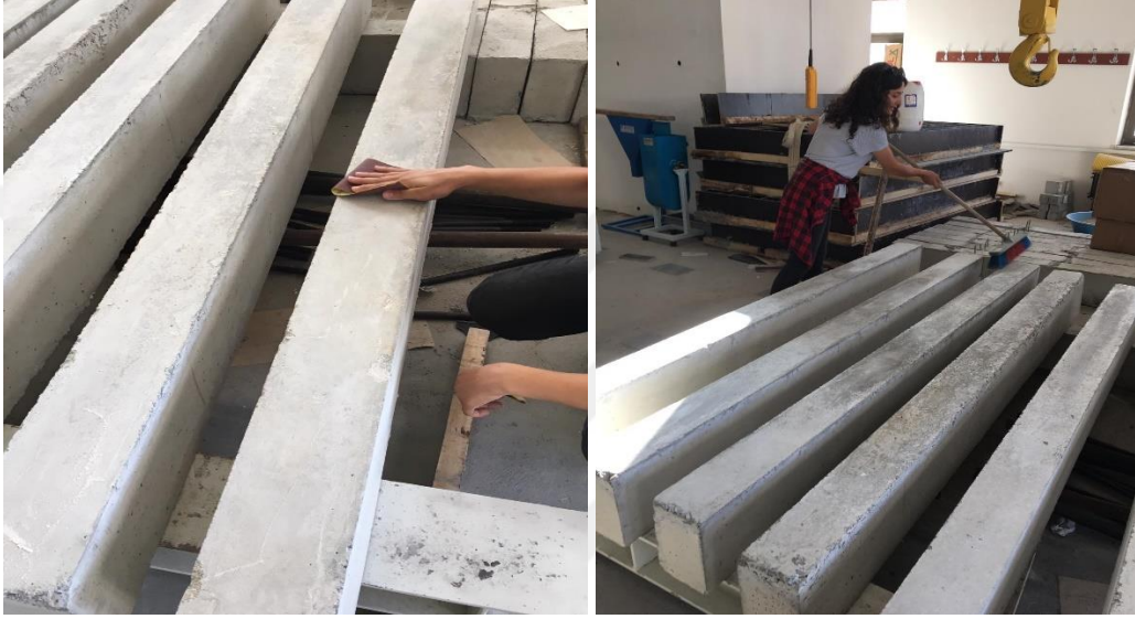
Şekil 3.13. Deney elemanlarının yüzey temizliğinin yapılması
