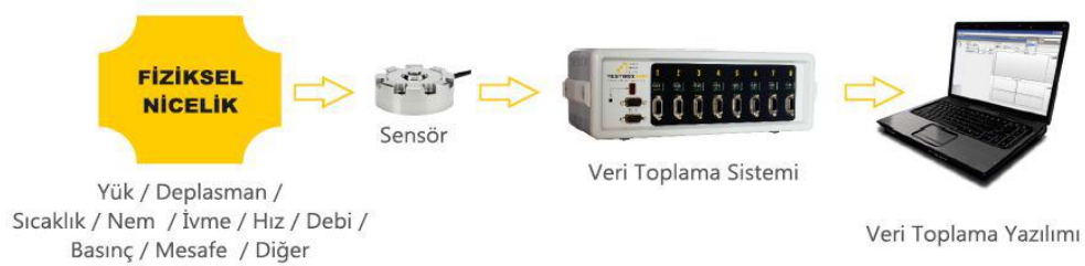
Şekil 3.24. Deneylerde kullanılan veri aktarım sistemi ve bilgisayar programı (Başsürücü, 2013)
