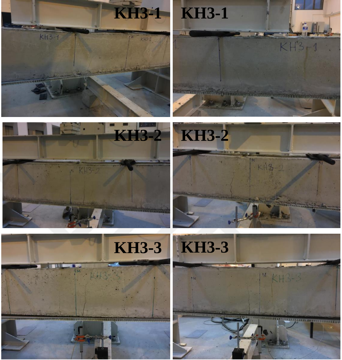
Şekil 4.16. KH3-1, KH3-2 ve KH3-3 kirişlerinin deney sonrası fotoğrafları
