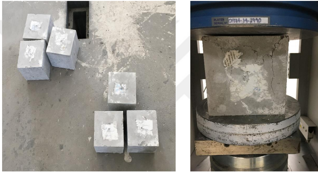
Şekil 4.1. Kür süresi tamamlanan numunelerin basınç dayanım testine tabi tutulması
