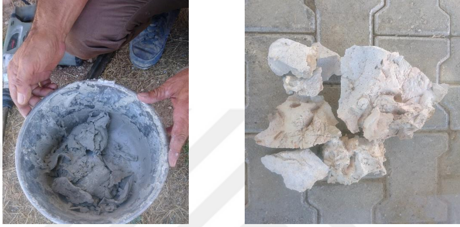
Şekil 3.16. Erken priz alan Sikadur-31 epoksi yapıştırıcı
