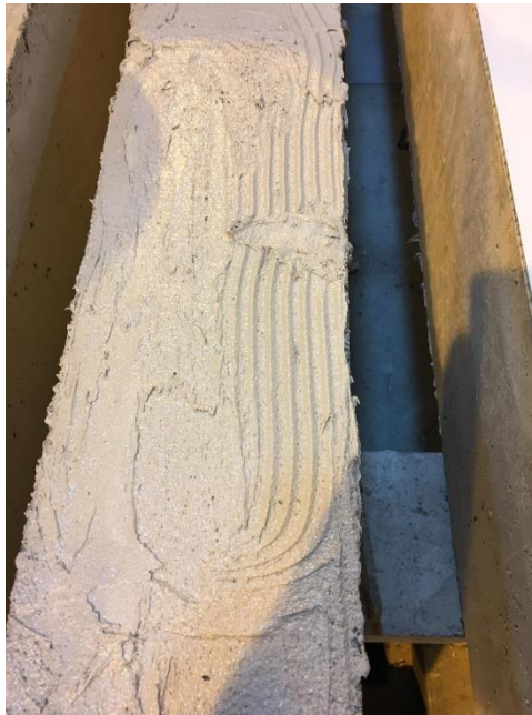
Şekil 3.15. Hazırlanan Sikadur-31 epoksi yapıştırıcının kiriş yüzeyine sürülmesi
