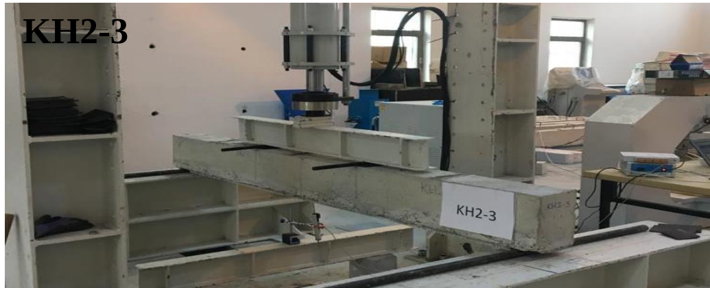
Şekil 4.12. KH2-1, KH2-2 ve KH2-3 kirişlerinin deney öncesi fotoęrafları
