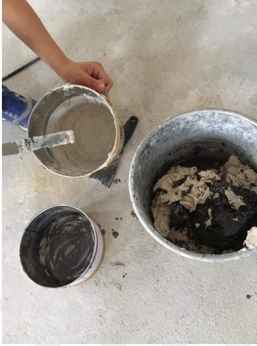
Şekil 3.14. Sikadur-31 epoksi yapıştırıcının hazırlanması
