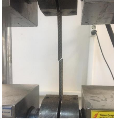
Şekil 4.2. Donatı çeliği çekme deneyi
