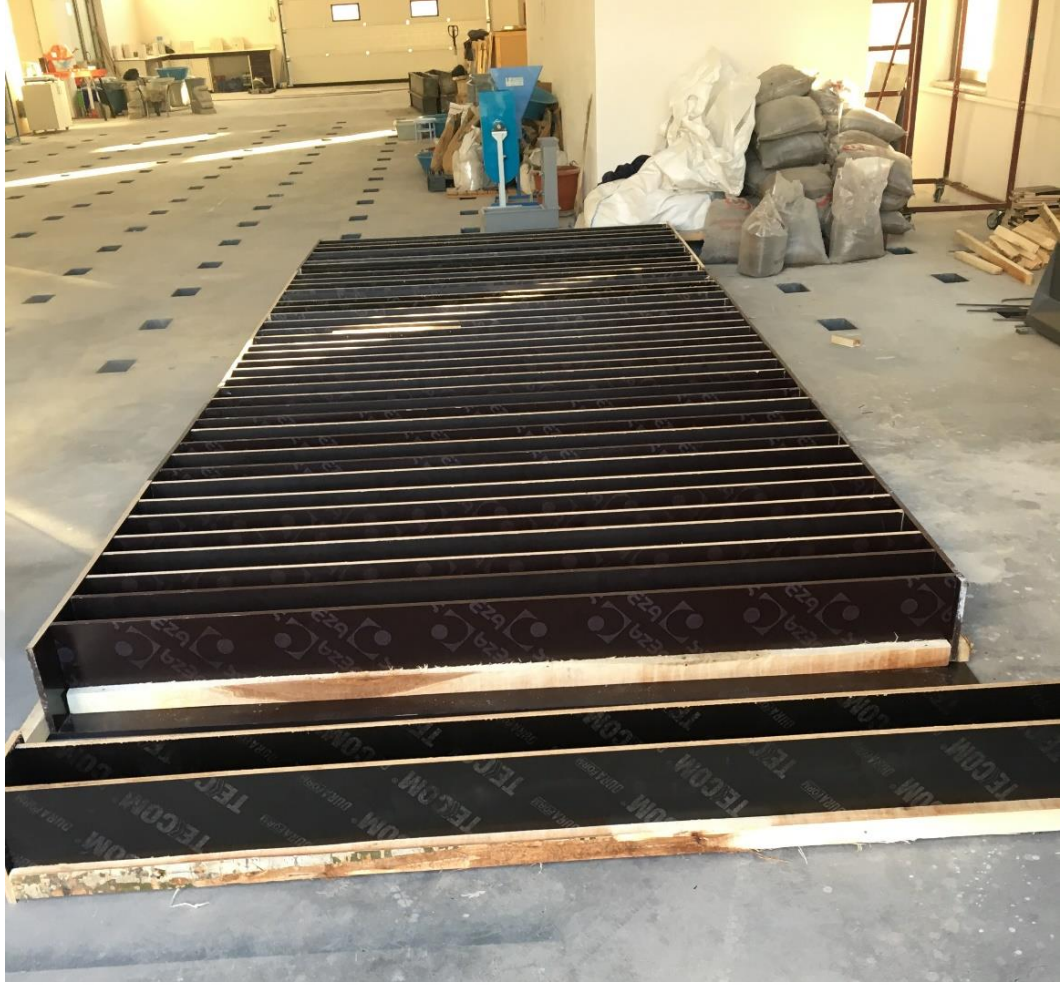
Şekil 3.6. Deney elemanları kalıbı
