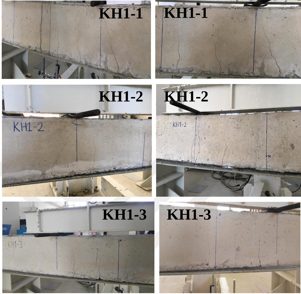
Şekil 4.8. KH1-1, KH1-2 ve KH1-3 kirişlerinin deney sonrası fotoğrafları
