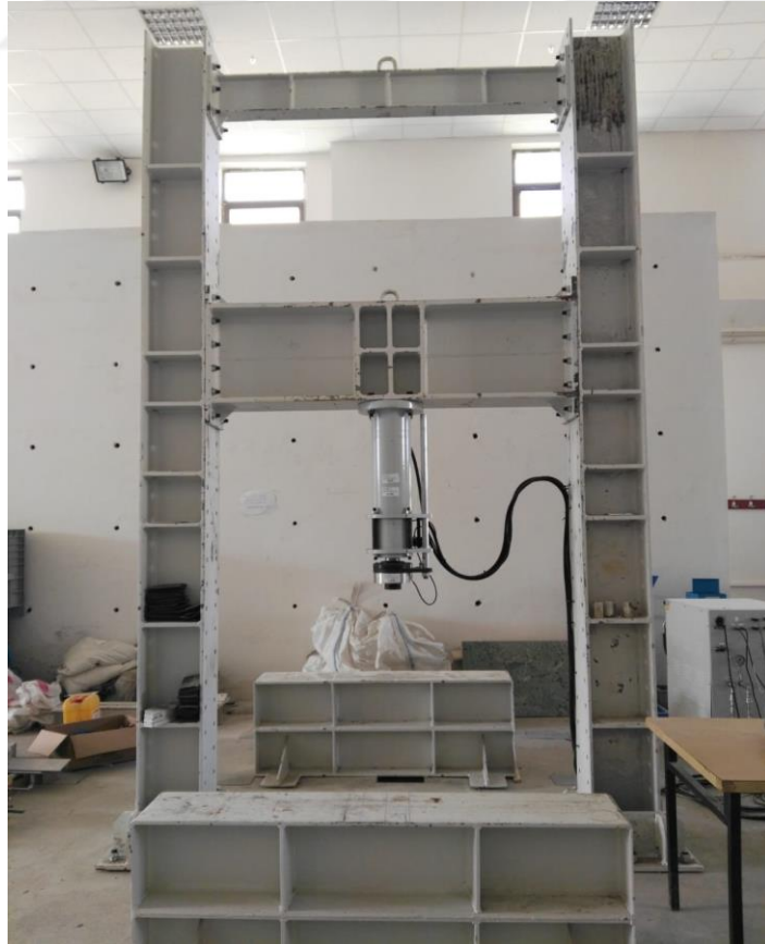
Şekil 3.22. Eğilme deney düzeneđi
