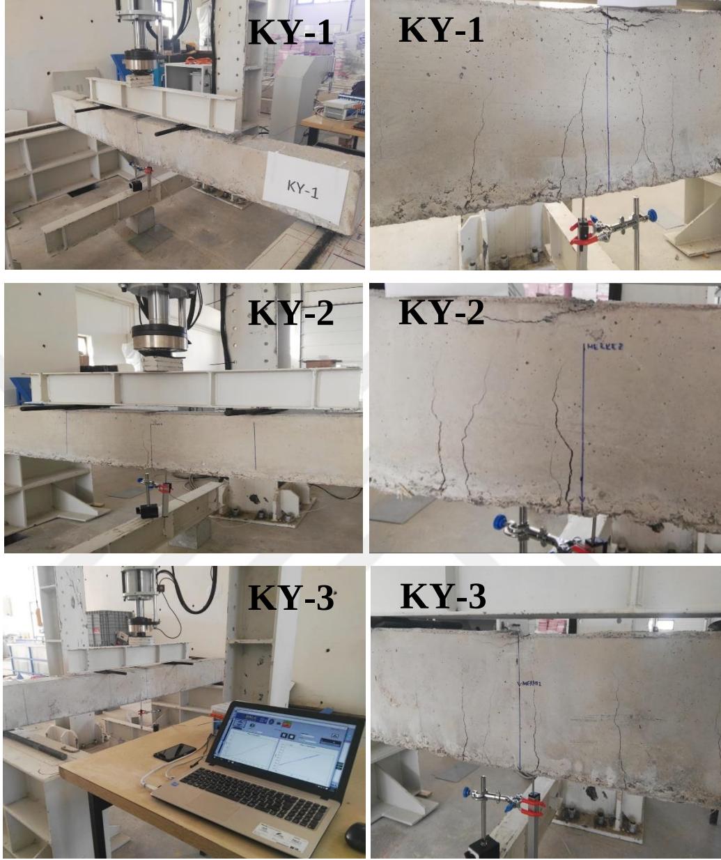
Şekil 4.5. Referans kirişlerin deney sonrası fotoğrafları
