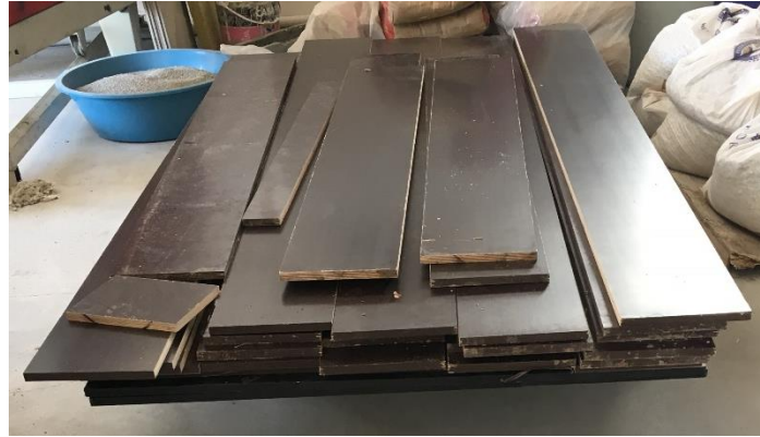
Şekil 3.1. Deneyde kullanılan kalıp malzemesi
