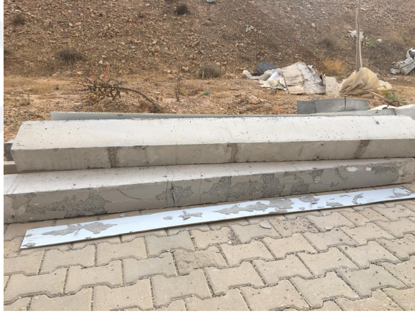
Şekil 4.11. Deney sonrası honeycomb panelin (Panel 1) kiriş yüzeyinden kaldırılması
