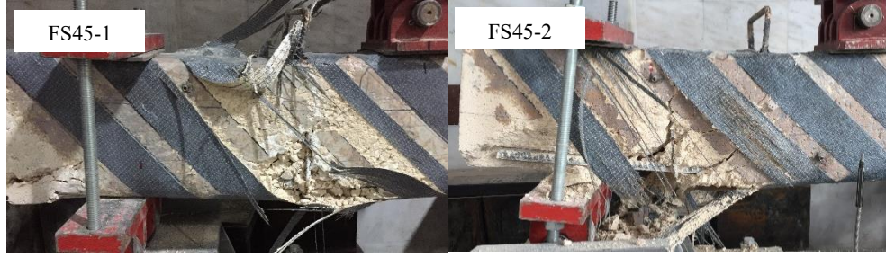
Şekil 4.14. FS45 kiriş numunelerinin yükleme sonrası deformasyon şekilleri
