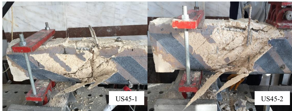
Şekil 4.6. US45 kiriş numunelerinin yükleme sonrası deformasyon şekilleri
