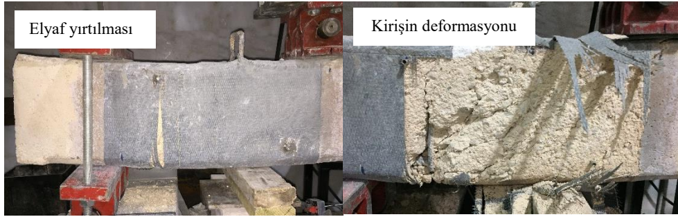
Şekil 4.22. FSW90 kiriş numunesinin yükleme sonrası deformasyon şekilleri
