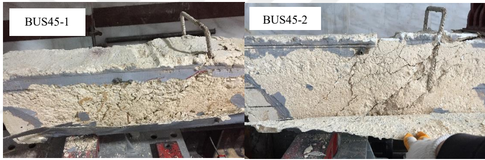
Şekil 4.10. BUS45 kiriş numunelerinin yükleme sonrası deformasyon şekilleri
