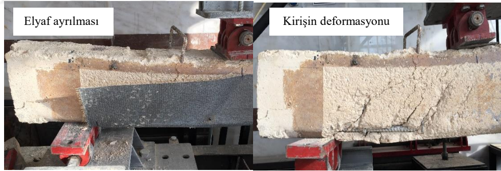
Şekil 4.18. SBS90/0 kiriş numunesinin yüklemeye sonrası deformasyon şekilleri
