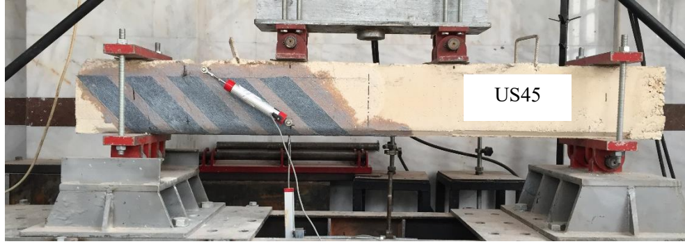
Şekil 4.5. 45US kiriş numunelerinin eğilme deneyi
