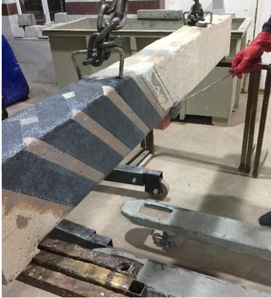
Şekil 3.19. Beton yüzeyine epoksi uygulanması
