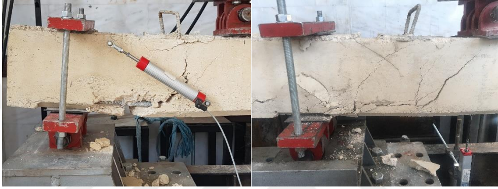
Şekil 4.2. Kontrol kirişin yükleme sonrası deformasyon şekli
