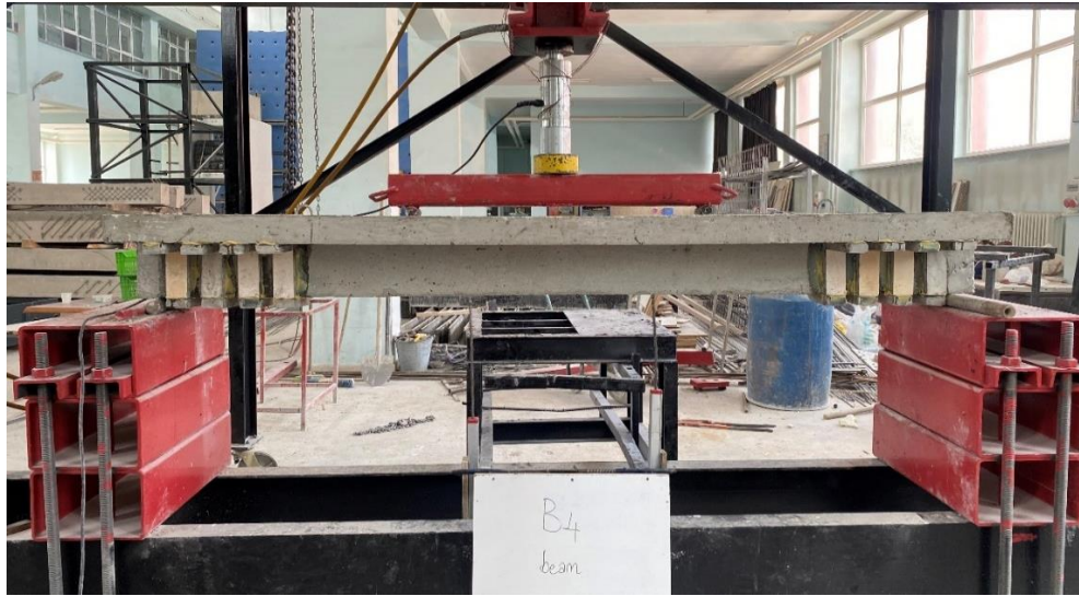
Şekil 5.14 B4 numunesinin yükleme öncesi görüntüsü
