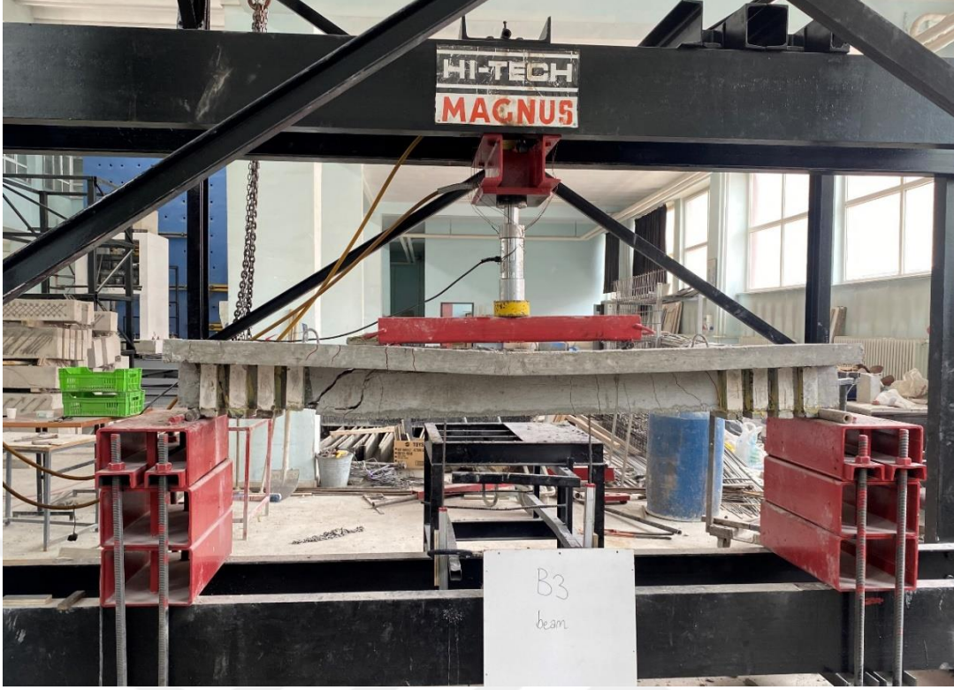
Şekil 5.11 B3 numunesinin yükleme sonrası görüntüsü
