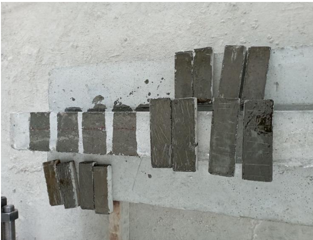
Şekil 3.27 Kiriş ve blok yüzeylerine epoksi astarının uygulanması
