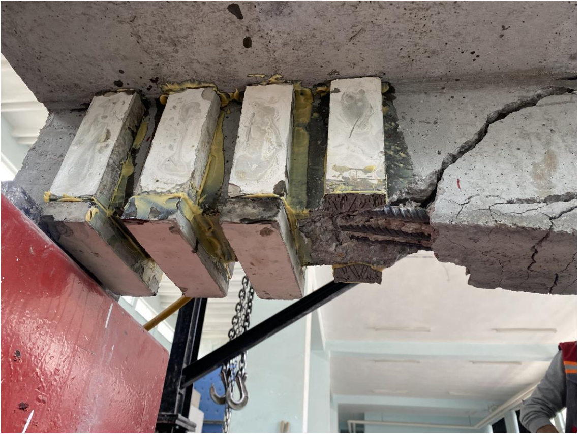
Şekil 5.12 B3 numunesinin yükleme sonrası oluşan çatlaklar
