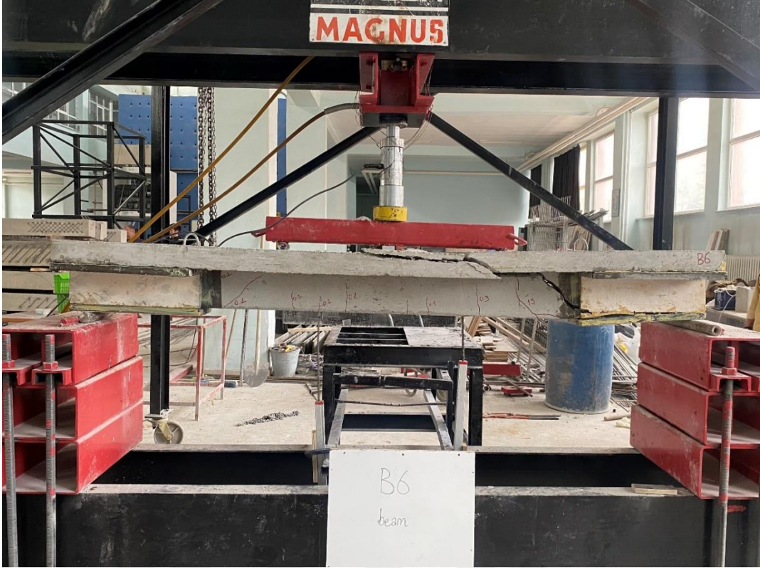
Şekil 5.23 B6 numunesinin yükleme sonrası görüntüsü
