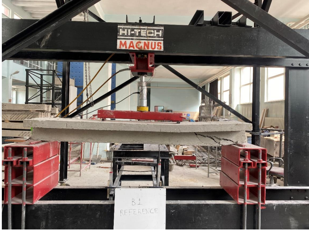
Şekil 5.2 B1 referans numunesinin yükleme sonrası görüntüsü
