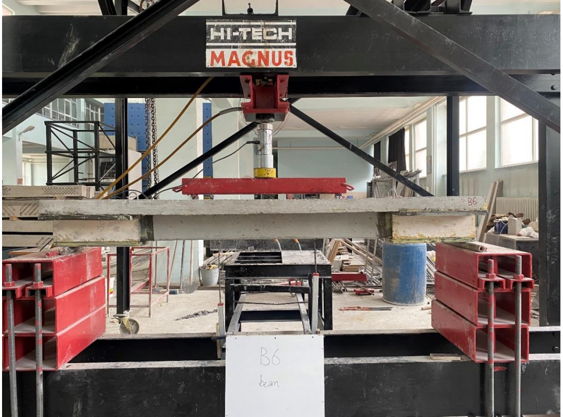
Şekil 5.22 B6 numunesinin yükleme öncesi görüntüsü
