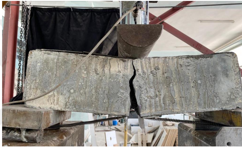
Şekil 3.7. Numune detayları ve deney sonucunda oluşan çatlak görünümü (Kayacık 2022)
