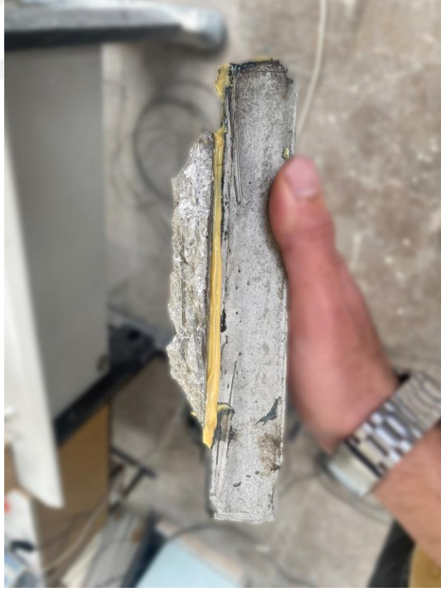
Şekil 5.16 B4 numunesinin yükleme sonrası oluşan çatlaklar
