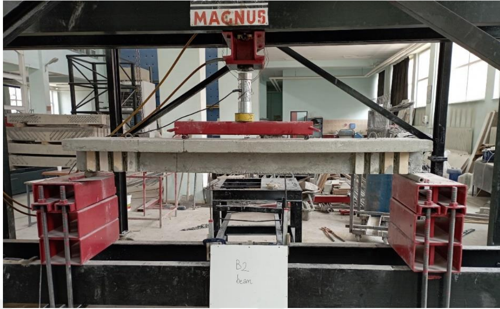
Şekil 5.6 B2 numunesinin yükleme öncesi görüntüsü
