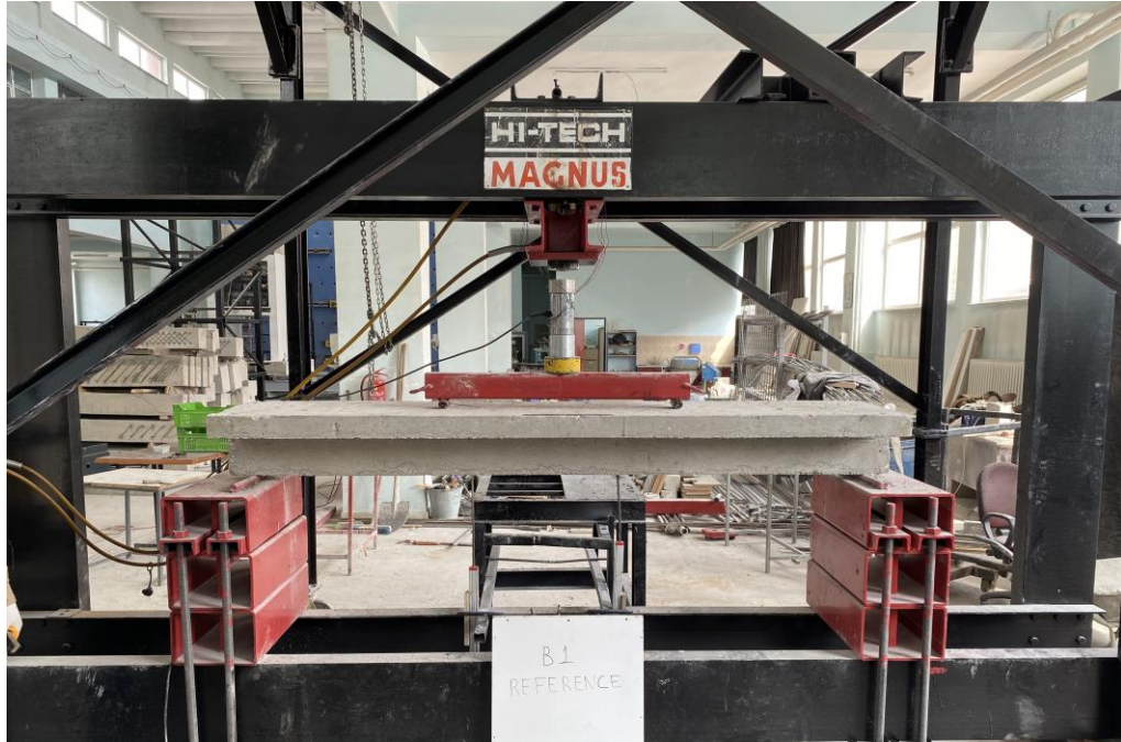
Şekil 5.1 B1 referans numunesinin yükleme öncesi görüntüsü
