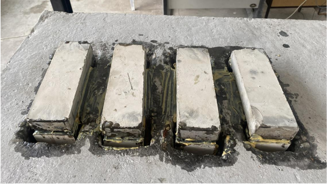
Şekil 5.20 B5 numunesinin yükleme sonrası oluşan çatlaklar
