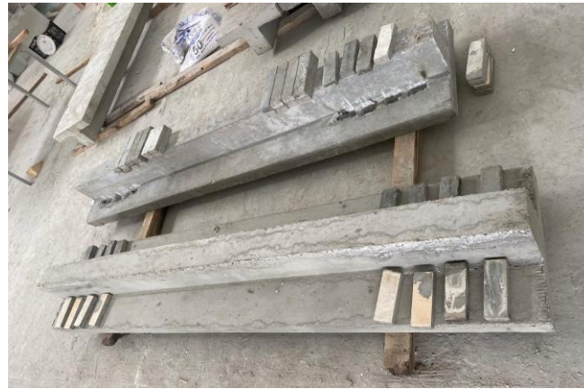
Şekil 3.25 Lifli özel blokların kiriş güçlendirilme şekillerine göre gruplandırılması
