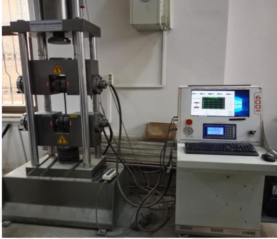
Şekil 3.2: Büyük ölçekli numunelerde kullanılan donatıların çekme testi
