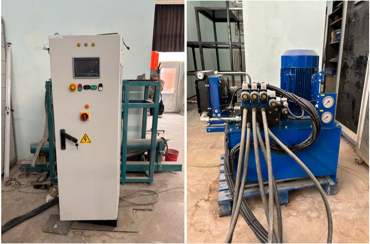
(a) (b) Şekil 3.8. Otomasyon sistemi, a) otomasyon panosu, b) hidrolik güç ünitesi
