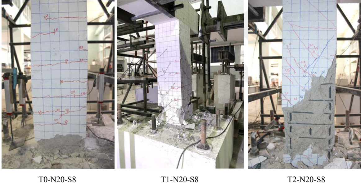
Şekil 4.107. II. gruba ait plastik mafsal ve hasar görüntüleri
