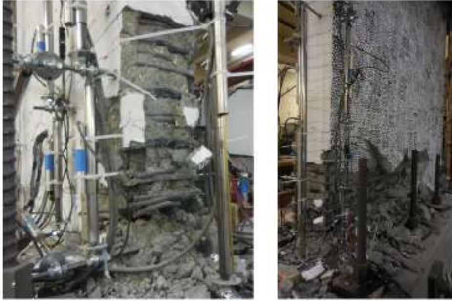
Şekil 2.8 WP6 Perdesi hasar fotoğrafı (Segura, 2017)
