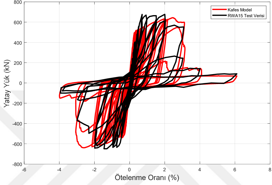
Şekil 4.30 RWA-15 Hibrit model (10h) ve Kafes model yanal yük yatay ötelenme oranı grafięi
