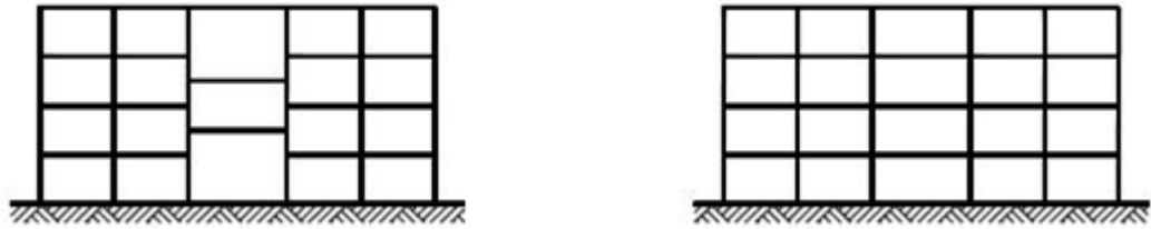
Şekil 2.10. Düşeyde kiriş süreksizliği içeren ve içermeyen tipik örnekler [12].
