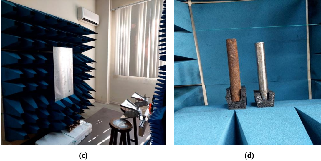
Şekil 3.13. Doğrulama ve kalibrasyon ölçümleri; a) Referans anten kullanarak ölçümler; b) Arka plan ölçümü; c) Düz metal plaka ölçümü; d) Paslı ve passız çubuk referans ölçümü
