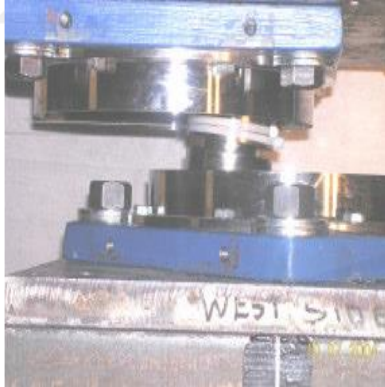
Şekil 4.23 Sürtünlmeli sarkaç sisteminin yer değıştirmesi (b) (Constantinou, 2004)
