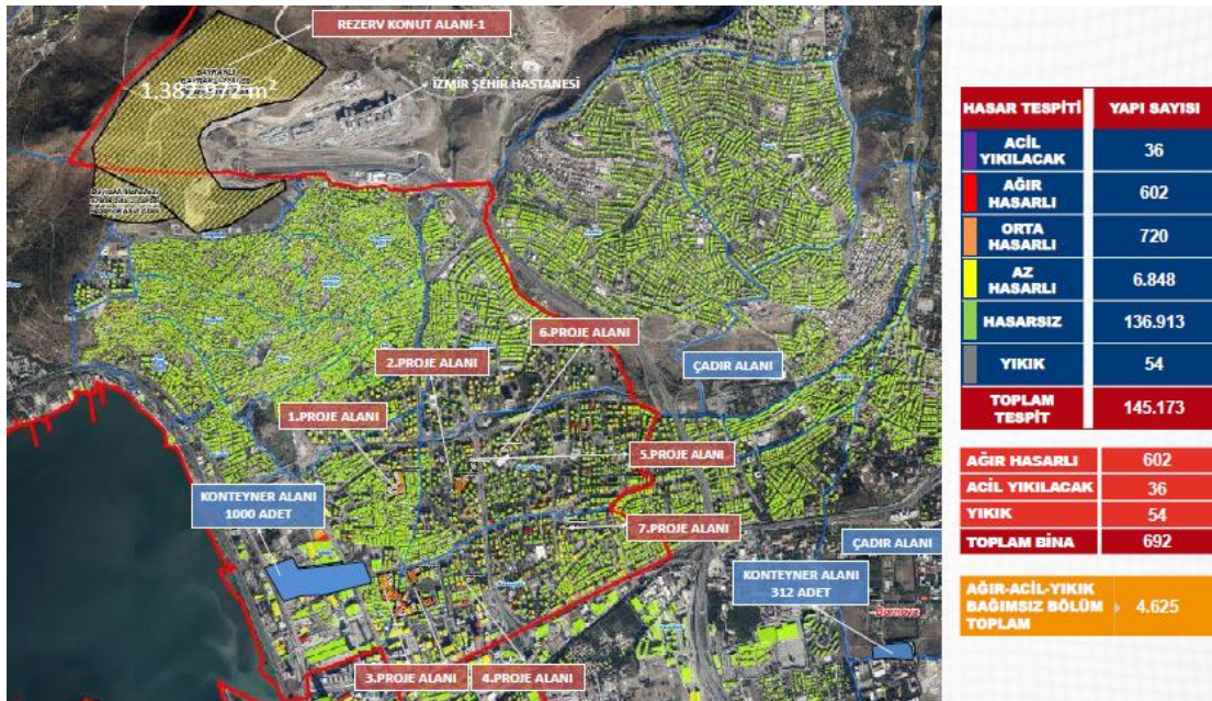
Şekil 5.41. İzmir (Seferihisar) depreminde, betonarme binaların hasar alma derecelerine göre sınıflandırılıp haritada gösterimi (ÇŞB, 2021)
