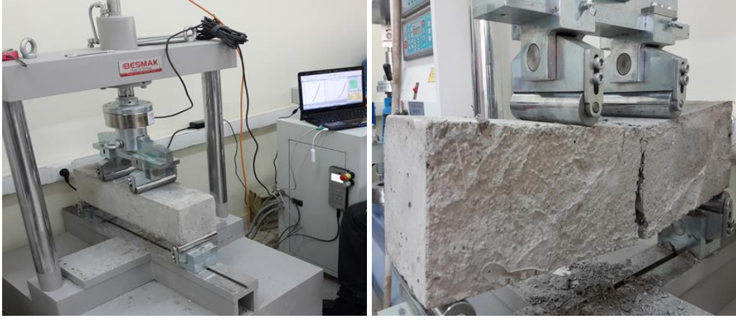
Şekil 3.7. Kiriş eğilme testine tabi tutulan beton numuneler
