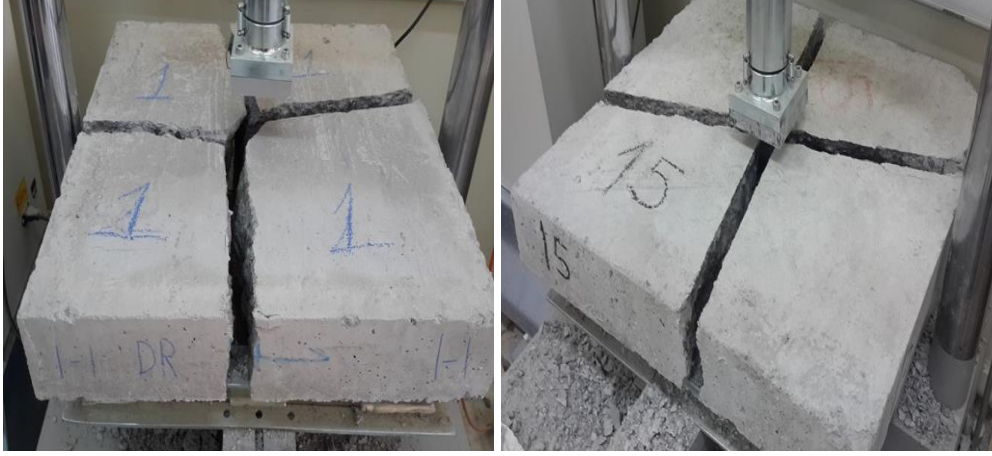
Şekil 4.2. Referans betonlarda plak kırılma testleri
