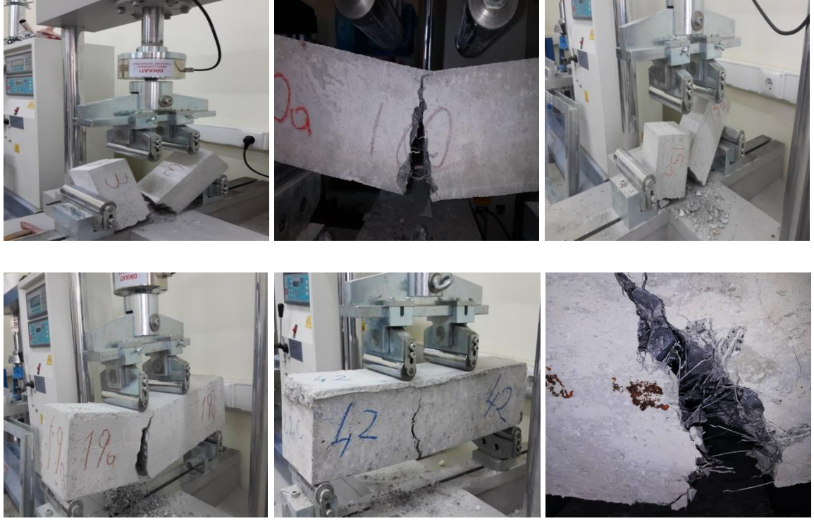
Şekil 4.46. Çelik lifli betonların kiriş eğilme testleri
