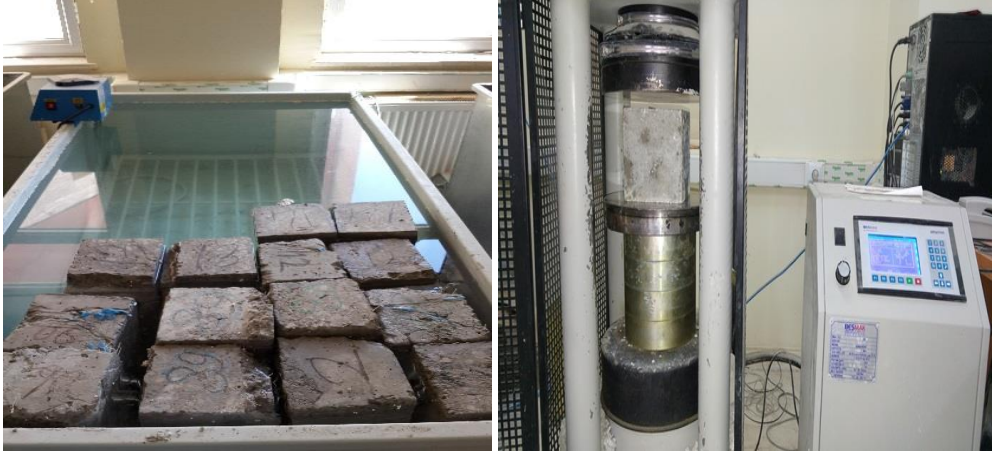
Şekil 3.8. Basınç testine tabi tutulan beton numuneler
