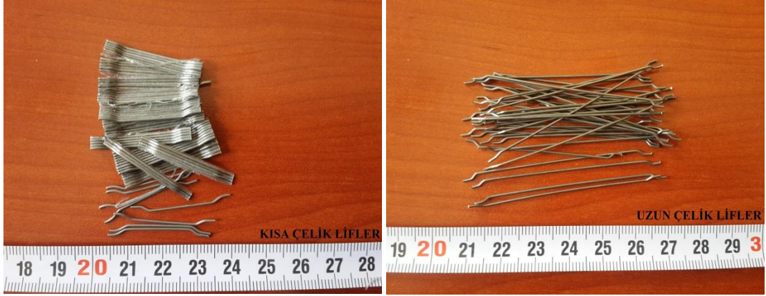
Şekil 3.5. Betonda kullanılan kısa ve uzun çelik lifler
