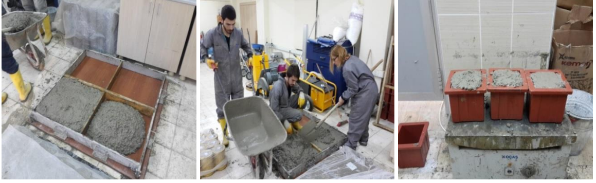
Şekil 3.1. Normal beton üretiminde kullanılan kalıplar
