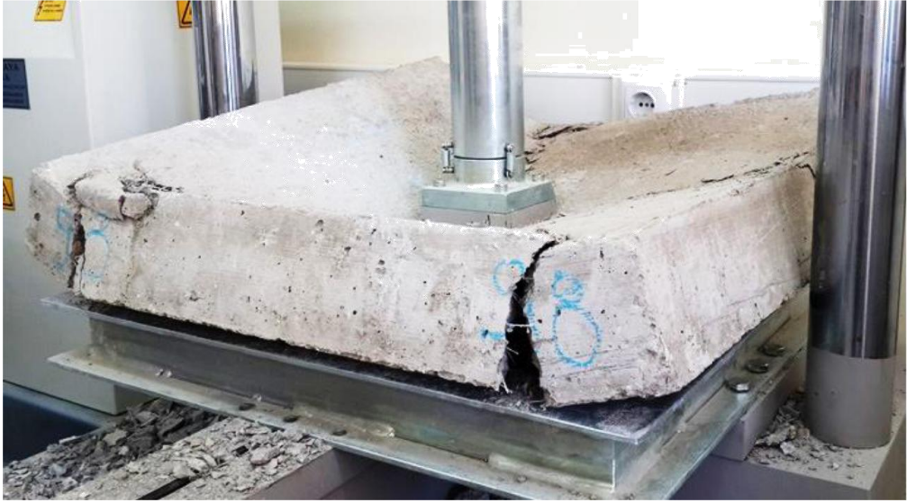
Şekil 4.91. Lifli beton plakların kırılma şekilleri
