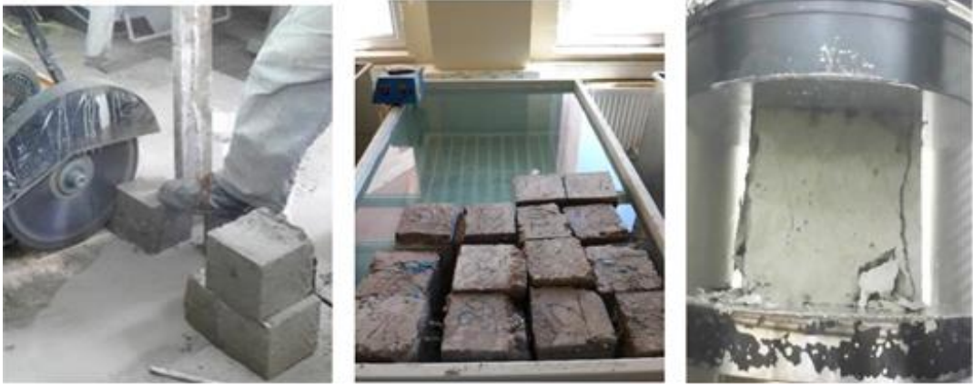
Şekil 3.8. Basınç testine tabi tutulan beton örnekler
