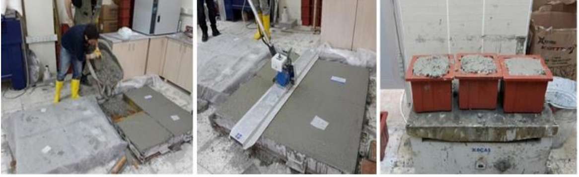
Şekil 3.1. Lifsiz referans ve kısa lifli normal üretim betonlar.
