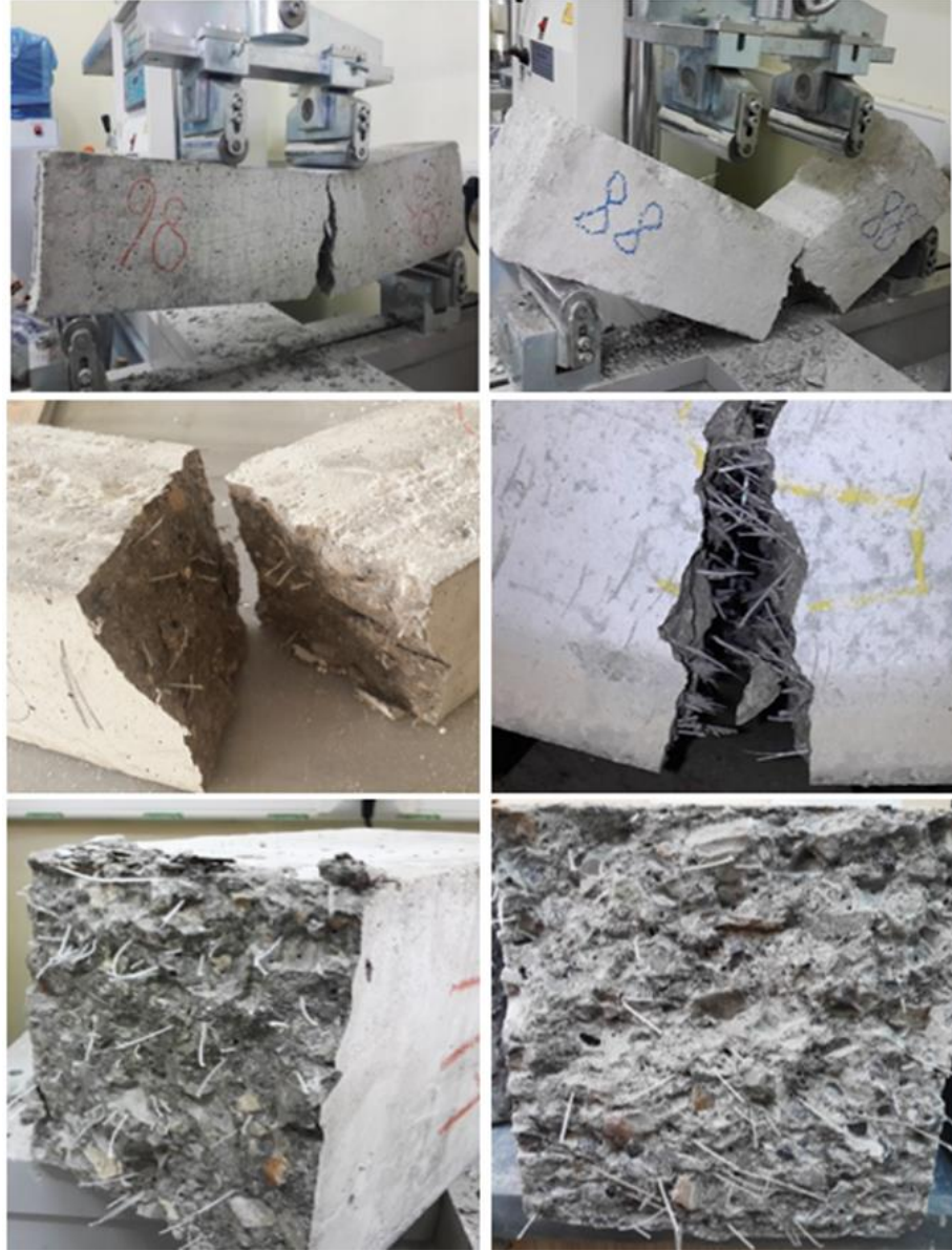
Şekil 4.46. PP lifli betonların kiriş eğilme testleri
