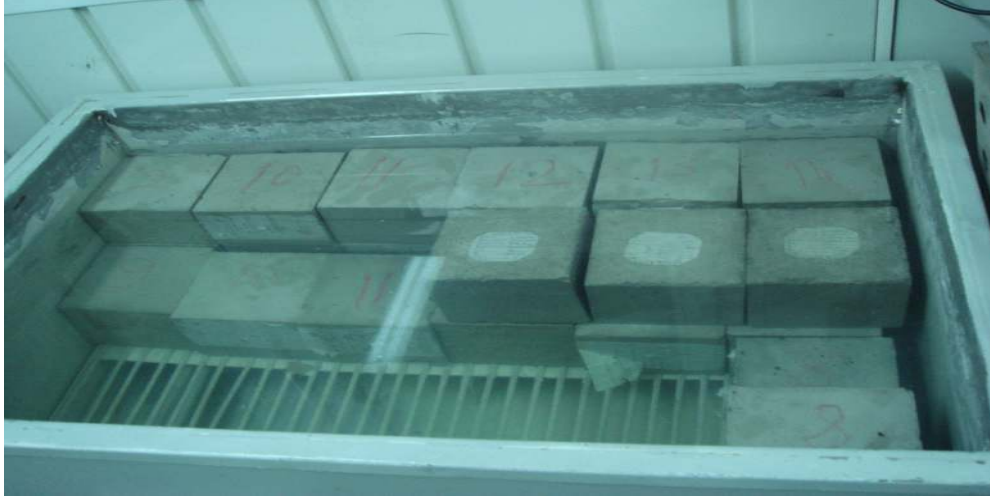
Resim 7.6. Beton k r tankı
