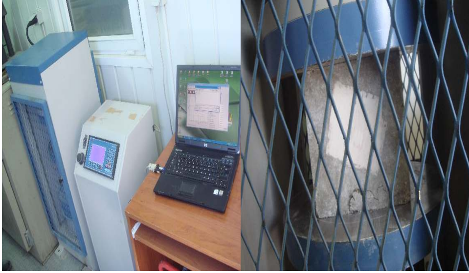
Resim 7.4. Beton test presi ve numune kırılması
