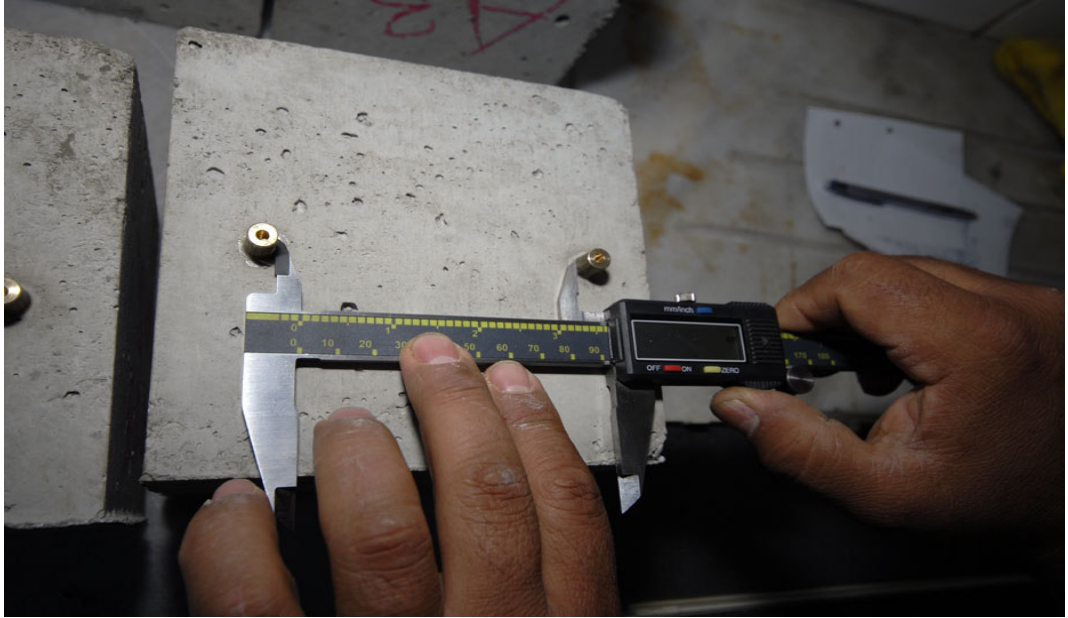
Resim 7.11. K p numunelerin boyuna deęiřimlerinin g zlenmesi
