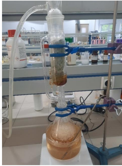
Şekil 3. 1. Soxhlet cihazı ile boyar madde ekstraksiyon işlemi
