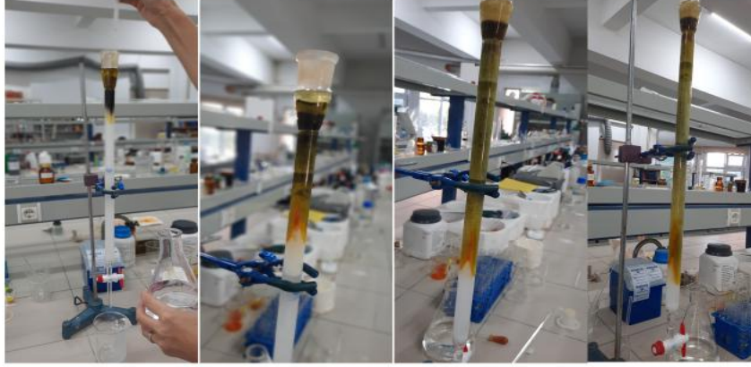
Şekil 3. 9. Beyaz dut yaprağı için uygulanan kolon kromatografisi
