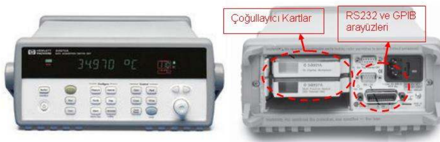
Şekil 6.2 HP Agilent 34970A DAQ veri toplama cihazının ön ve arka yüzlerinin görünümüleri
