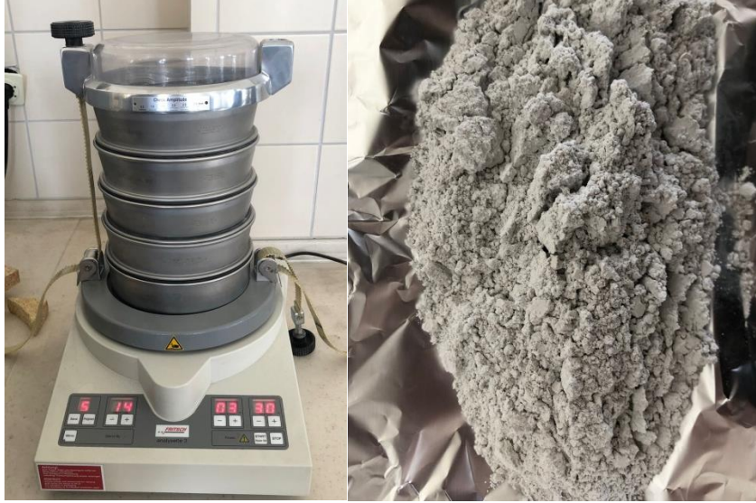
Şekil 3.6. Eleme işlemi yapılmış takviye malzemesi
