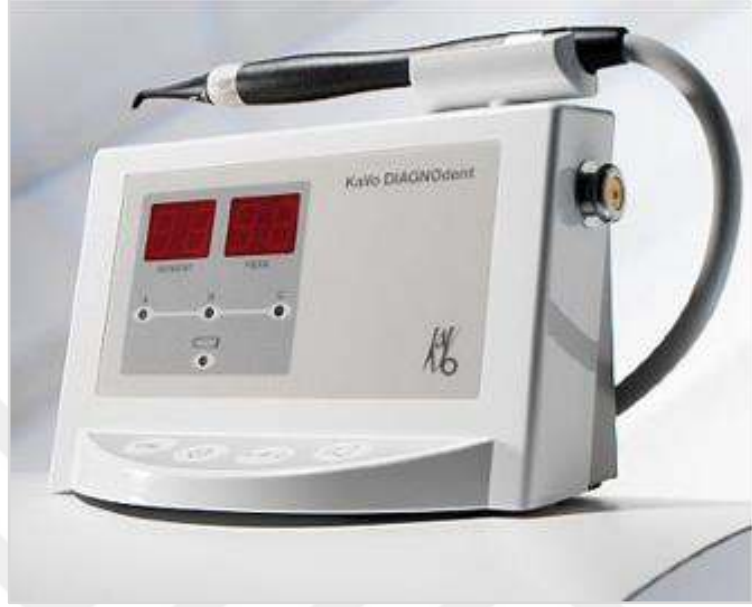
Şekil 2.5. DIAGNOdent çürük teşhis cihazı (57)
