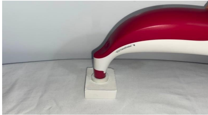
Şekil 14: Spektrofotometre cihazının standardizasyonunu için hazırlanan düzenek ve spektrofotometre cihazı ile renk ölçümü.
