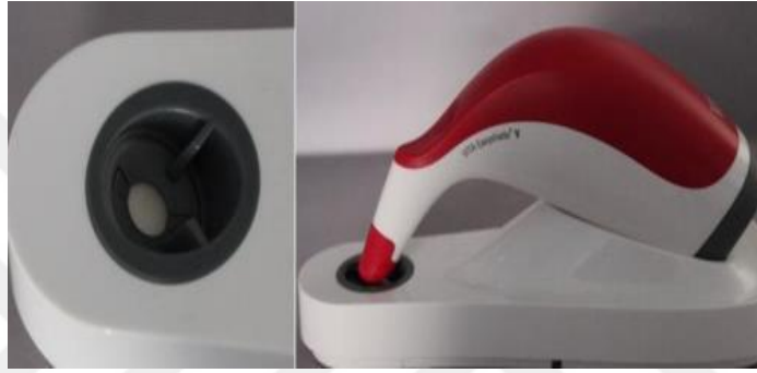
Şekil 13: Spektrofotometre cihazının kalibrasyon ünitesi, kalibrasyon için spektrofotometrenin üniteye yerleştirilmesi.
