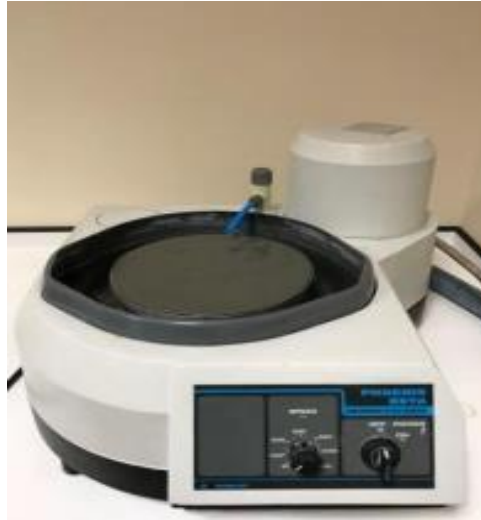
Şekil 10. Örneklerin polisajı için kullanılan cihaz (Phoenix Beta, Buehler, Lake Bluff, IL, ABD)
