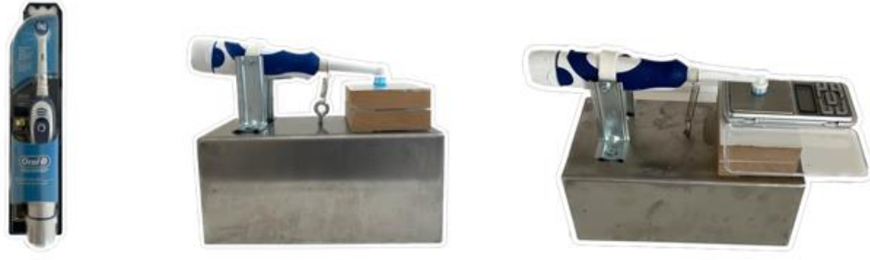
Şekil 3.5.a. Çalışmada kullanılan elektrikli diş fırçası b. Fırçalama düzeneği c. Hassas terazi ile uygulanan kuvvetin kontrolü
