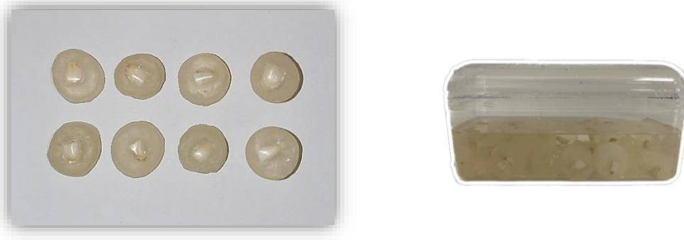
Şekil 3.3.a. Akriliğe gömülen diş örnekler b. Distile suda bekletilen örnekler
