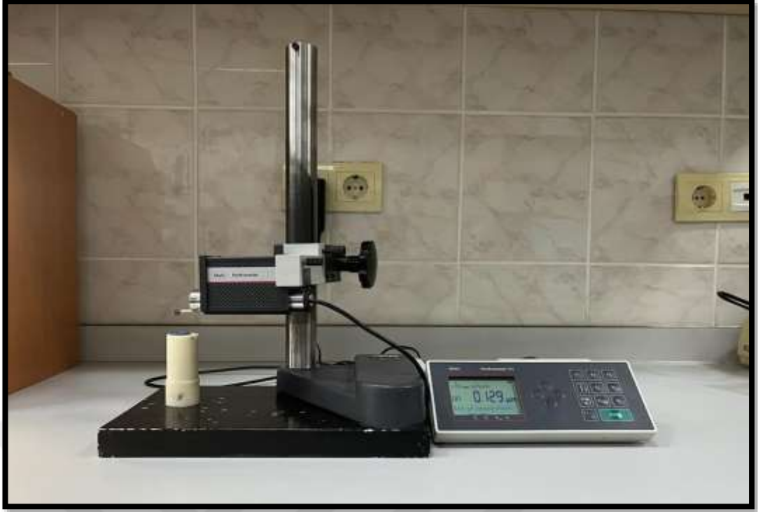
Şekil 3.10. Perthometer M2 (Mahr; Germany) profilometre cihazı
