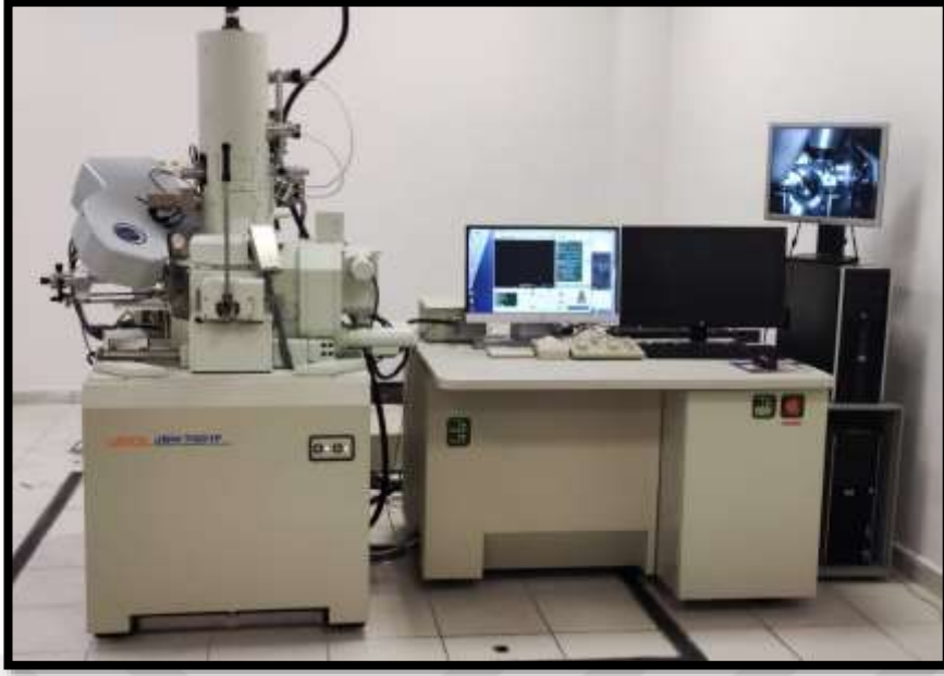
Şekil 3.11. Taramalı Elektron Mikroskobu (JEOL JSM 7001F, Japonya)
