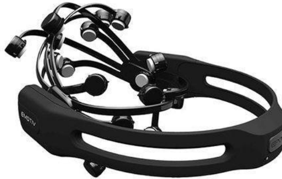
Şekil 3.3. Emotiv EPOC+ 14 Kanallı EEG kayıt cihazı
