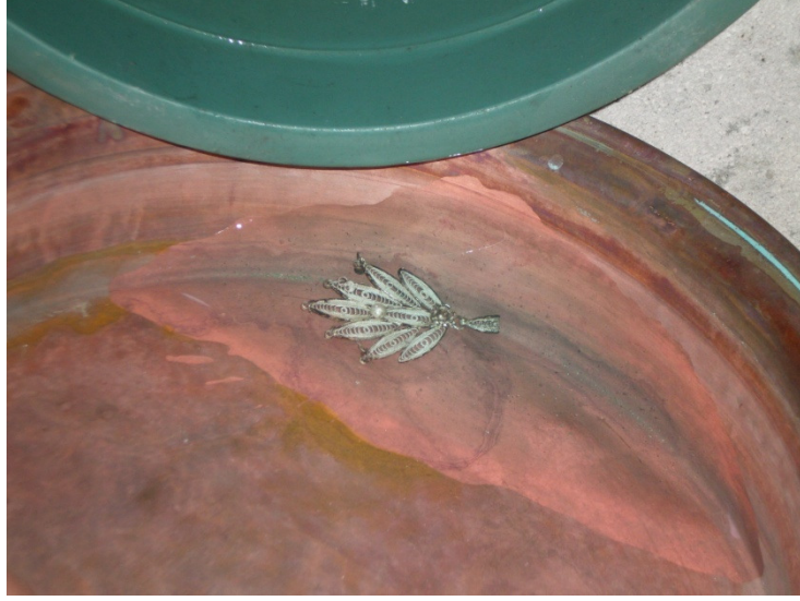
Fotoğraf 110: Bakır kap içine konan ürünün üzerine asitli su ilave edilmesi
