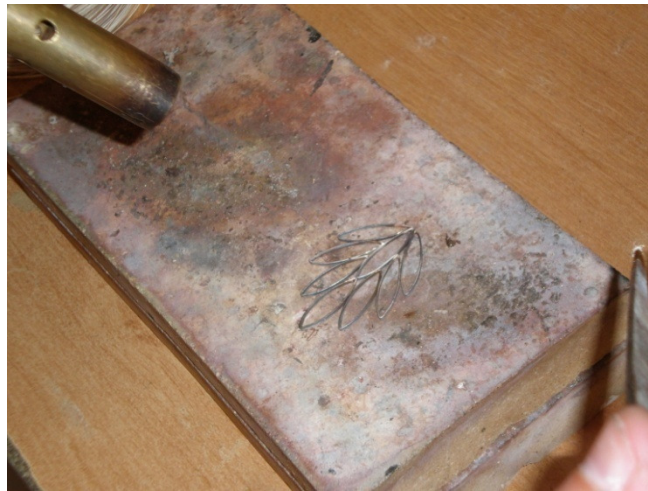
Fotoğraf 100: Belirlenen modelin hazırlanması için çatı tellerinin kaynak ile bir araya getirilmesi
