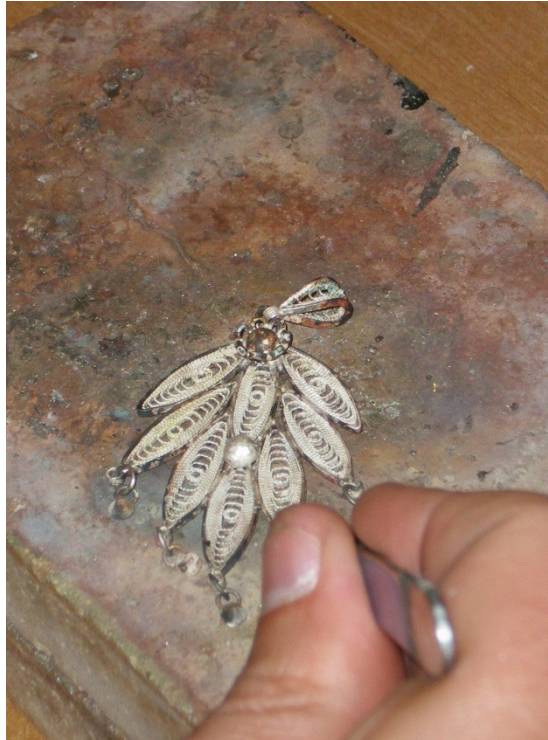
Fotoğraf 107: Takılan pulların ve kordon geçecek kısmının halkalarının kaynatılması
