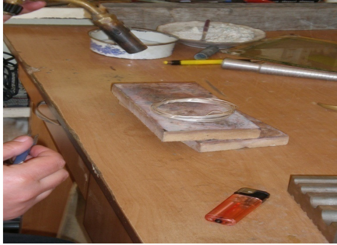
Fotoğraf 95: Silindirden geçmiş gümüş telin tavllanması
