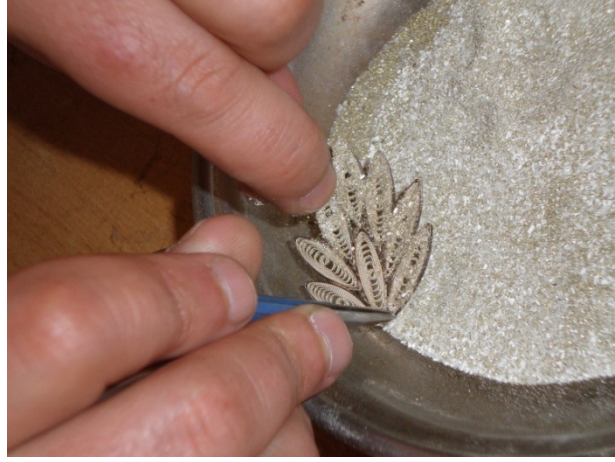
Fotoğraf 108: Dolgu telleri ile doldurulan çatının üzerine toz kaynak ve boraks karışımı dökülmesi
