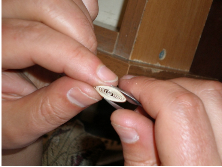
Fotoğraf 101: Çatı telinin içini doldurmak için dolgu teline form verilmesi
