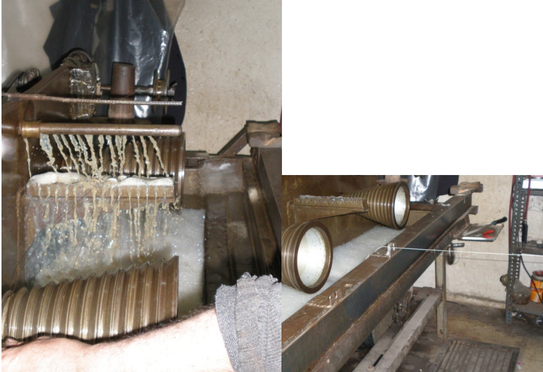
Fotoğraf 90-91: Telin istenilen inceliğe ulaşabilmesi için silindirden sonra hadde makinesinden ya da farklı ölçülerdeki el haddelerinden geçirilmesi
