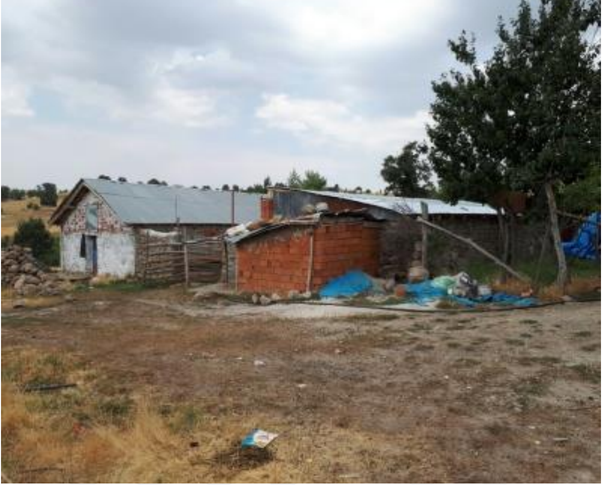
Fotoğraf 4.59: Kamışçık Ağılı Meskenlerinin Yapımında, Taş, Tuğla, Kiremit, Saç ve Ağaç Malzeme Beraber Kullanılmıştır
