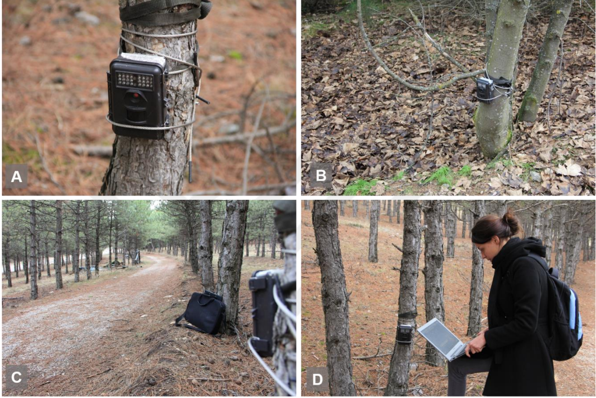
Şekil 3. 2. Çalışmada kullanılan fotokapanların yerleştirilmesi. A , ağaca belli bir açı ile sabitlenmiş Bushnell Trophy fotokapan; B , fotokapanın ağaçtaki konumu ve yerden yüksekliği; C , fotokapan yaklaşık kadrage alanı; D , fotokaptan veri aktarımı
