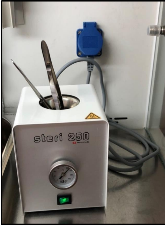
Şekil 3.5. Pens ve bistürü sterilizasyon için kullanılan cam boncuk sterilizatörü
