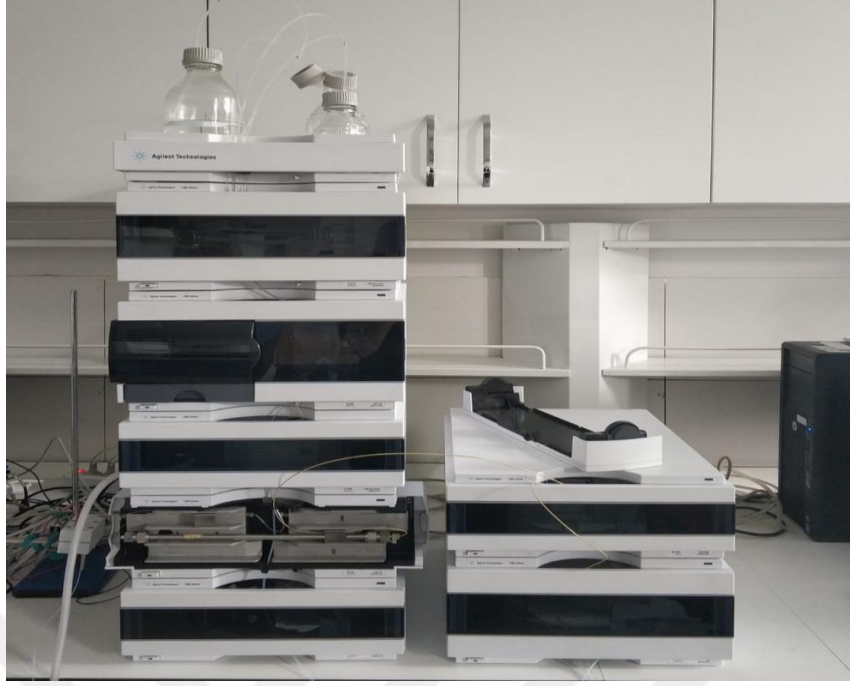
Şekil 3.8. Analizlerde kullanılan HPLC cihazı
