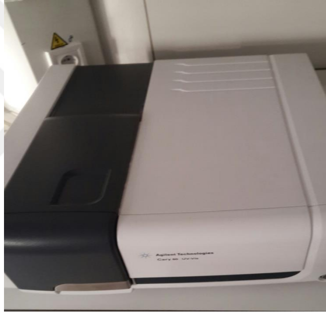
Şekil 3.7. Analizlerde kullanılan spektrofotometre(Agilent-Cary60) cihazı
