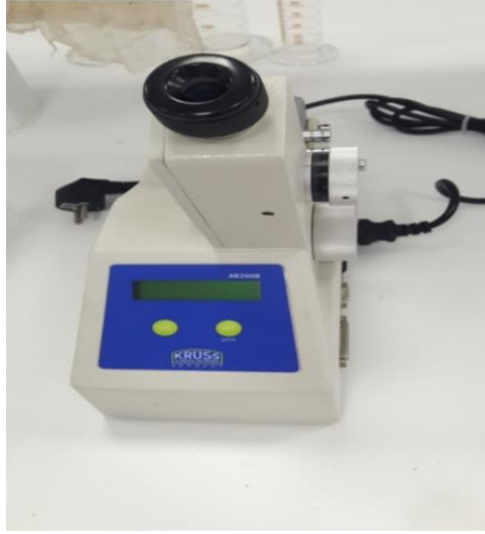
Şekil 3.5. Briks analizinde kullanılan refraktometre cihazı
