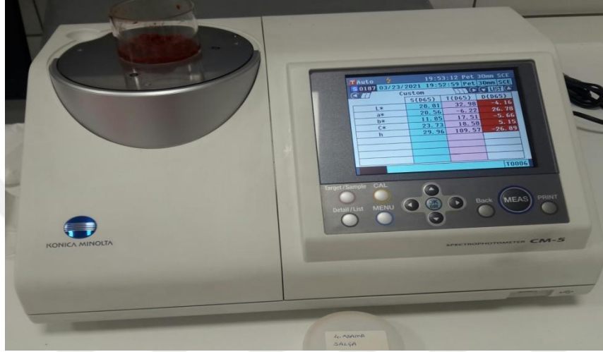
Şekil 3.4. Renk analizinde kullanılan (Konica Minolta, Inc., Japon) cihaz
