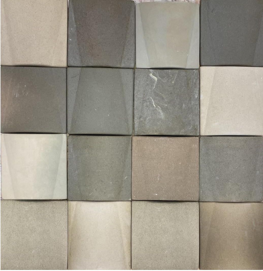
Görsel 4.2. FSDÇR1-GSDÇR2- GSDÇR2-KSDÇR1 Duvar Karosu Örneği, 60x60cm, 1050-1120-1200°C.
