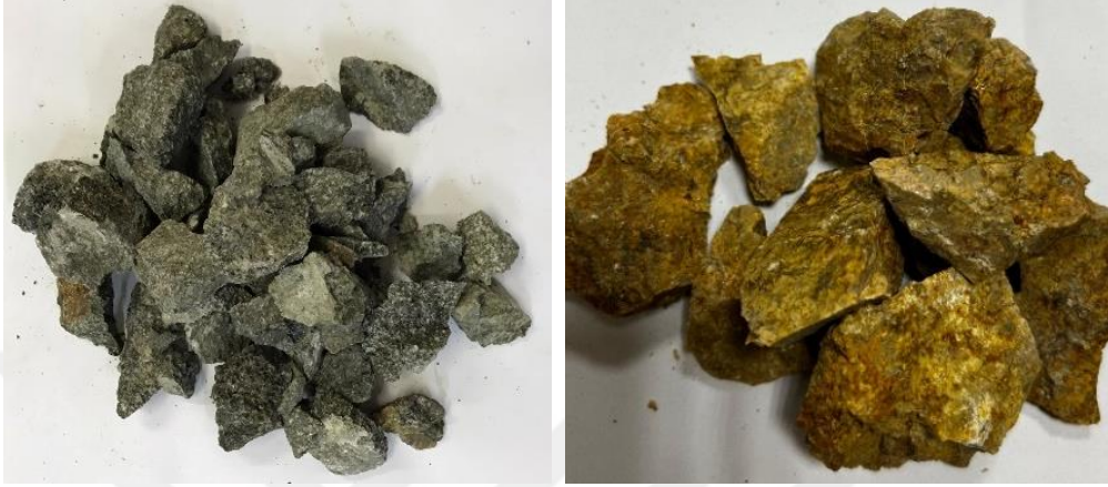
Görsel 2.6. Bozüyük Bölgesi Granit ve Feldspat Hammaddelerinin Çekiç Yardımı ile Küçültülmüş Halleri.
