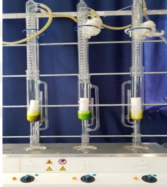
Şekil 3.3. Soxhlet cihazı ile gerçekleştirilen ekstraksiyon işleminin görüntüsü
