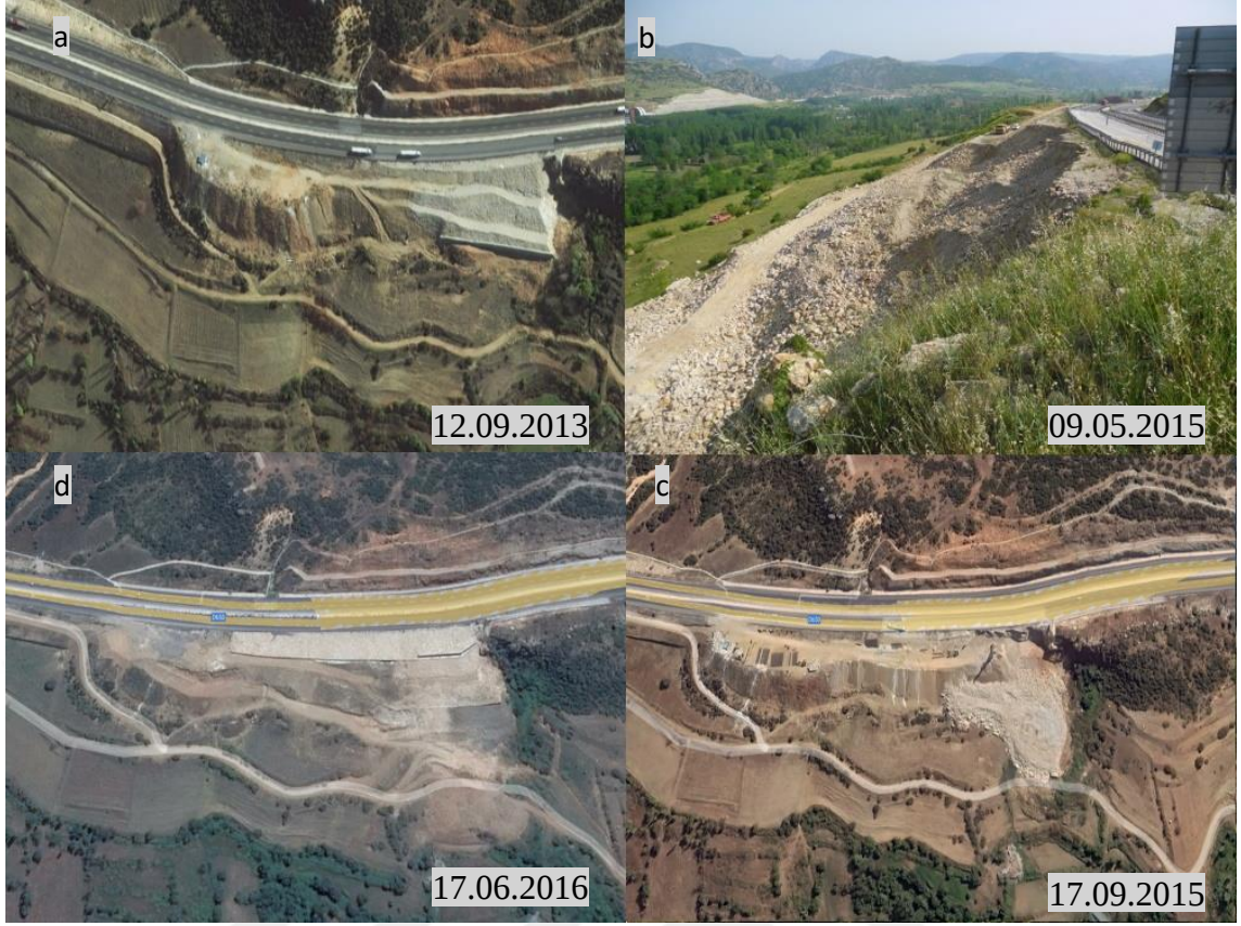
Şekil 4.22. Bilecik Çevre Yolunda Oluşan Kütte Hareketinin Farklı Zamanlara Ait Google Earth (A, C Ve D) Ve Araziden Çekilmiş (B) Görüntüleri.
