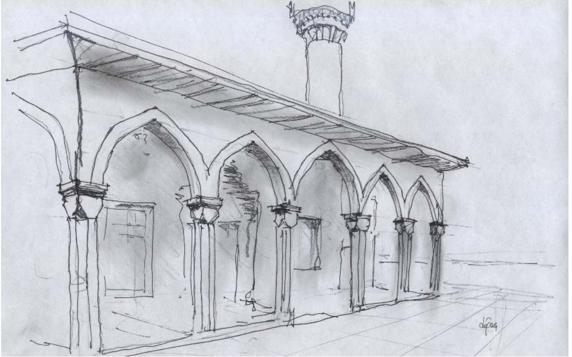
Şekil 3.42 Sivri kemerlerle geçilen açıklıklar
