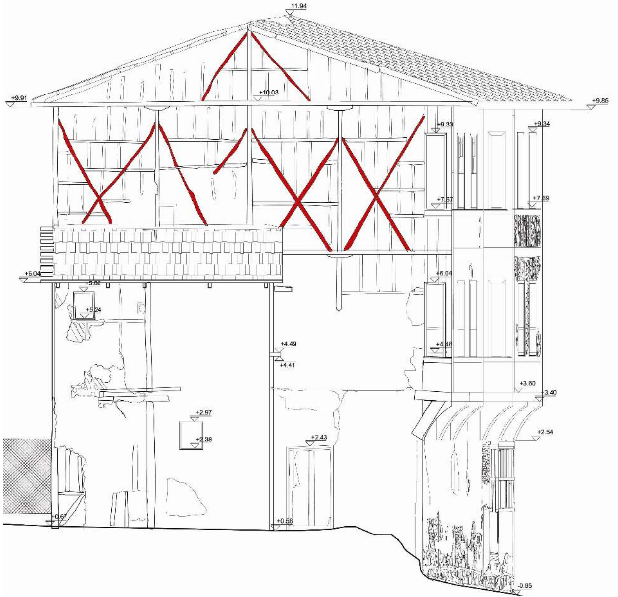
Şekil 3.8 Cebecioğlu Konağı batı cephesi ahşap payanda izleri
