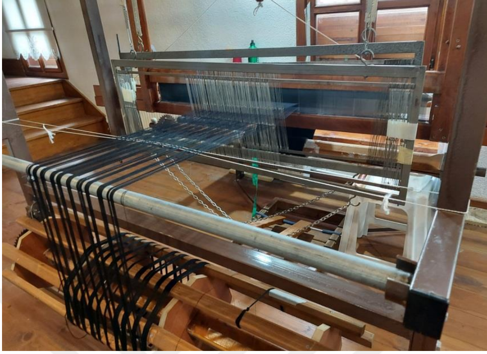
Resim 4.11. Levendlerden tezgâha aktarılan çözü ipliklerinin dokuma tezgâhında arkadan görünüşü (Tatlı, 2021)
