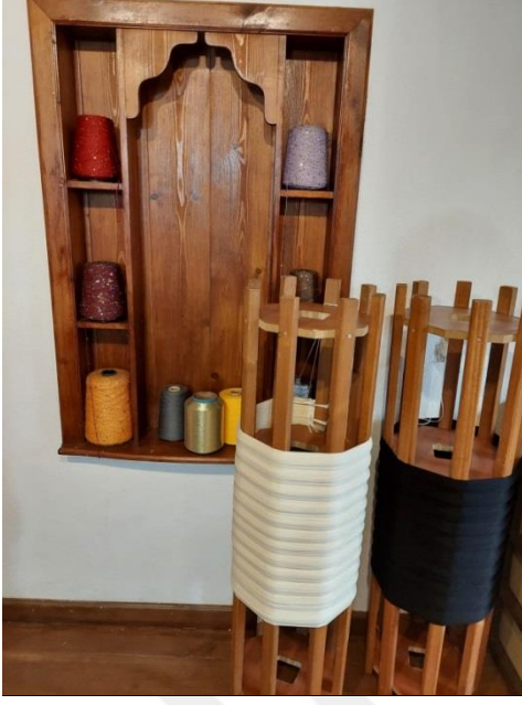
Resim 4.3. Dokuma işlemi için hazırlanan levende sarılmış farklı renkteki çözümler (Tatlı, 2021)
