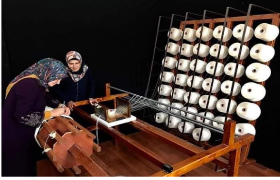
Resim 2.18. Kursiyerlerin çözü dolabında işlem yapması (Tatlı, 2020)
