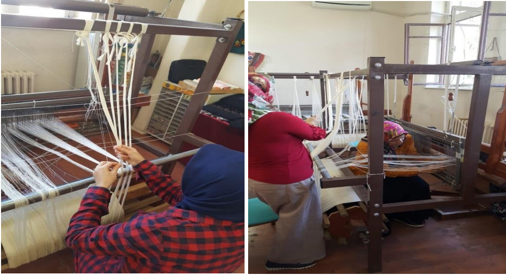
Resim 4.10. Çözümlenen ipliklerinin sırasıyla gücülerden tarağa aktarılması işlemi (Tatlı, 2020)
