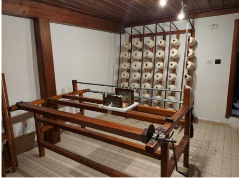
Resim 4.2. Çözü dolabında çözgünün hazırlanması (Tatlı, 2021)
