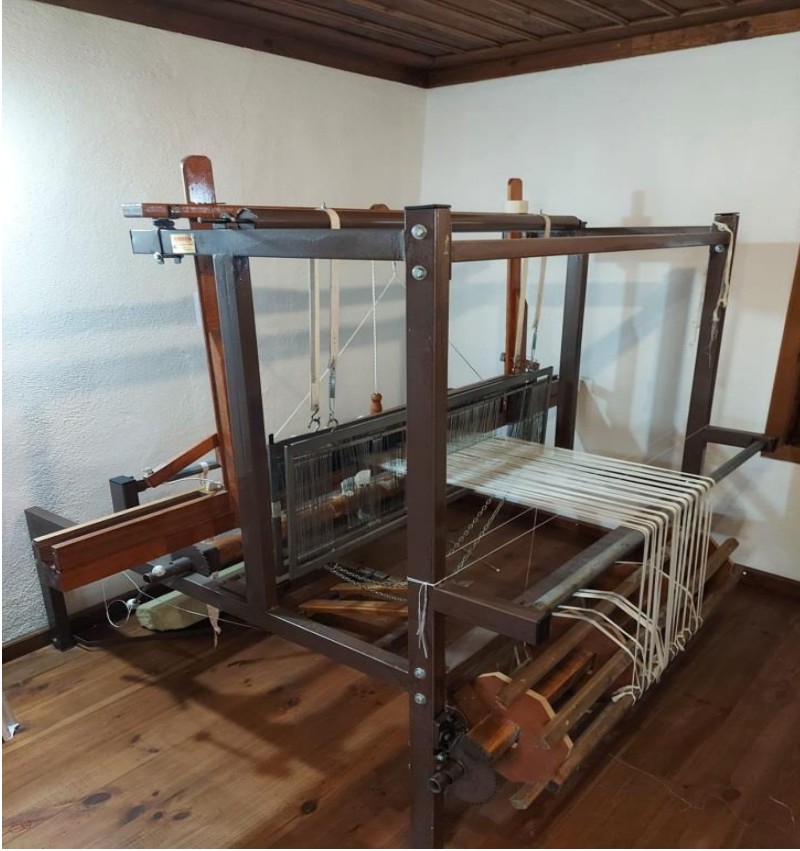
Resim 4.4. Dokuma tezgâhına çözgünün yerleştirilmesi (Tatlı, 2021)
