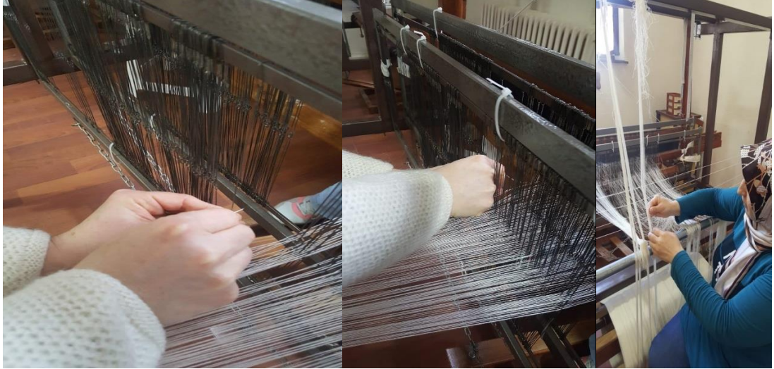
Resim 4.5. Gücü tellerinden çözgü ipliklerinin geçirilmesi (üç farklı görünüş) (Tatlı 2021)
