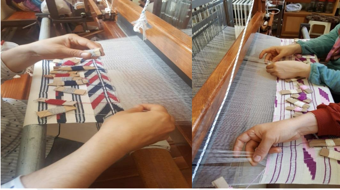
Resim 4.14. Dokuma kumaş üzerine motif işleme atkı ipliklerinin geçirilmesi (iki farklı açıdan görünüş) (Tatlı, 2021)
