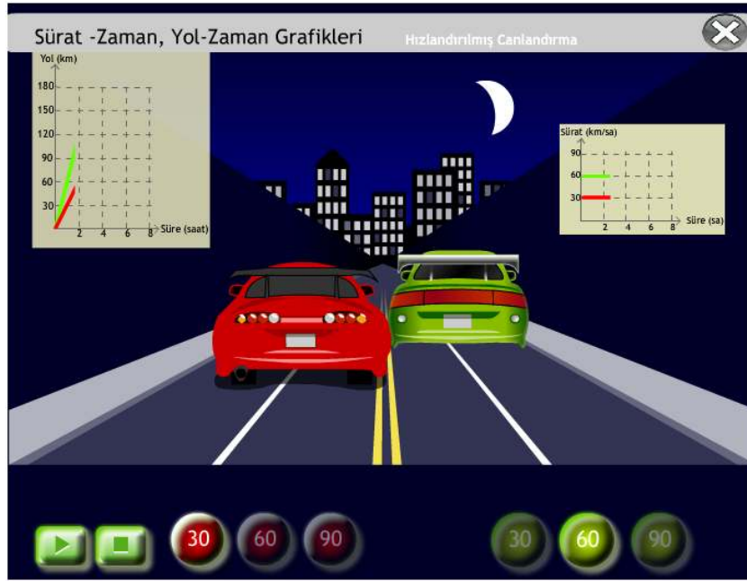
Şekil 7. Hareket eden iki farklı aracın süratlerini ve aldıkları yolları eş zamanlı olarak grafik üzerinde karşılaştıran ekran görüntüsü
