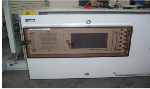
Şekil 3.72 CNC kasa koruyucu kapağı ve dongle (Çekim ve düzenleme: M.S.Ç.)
