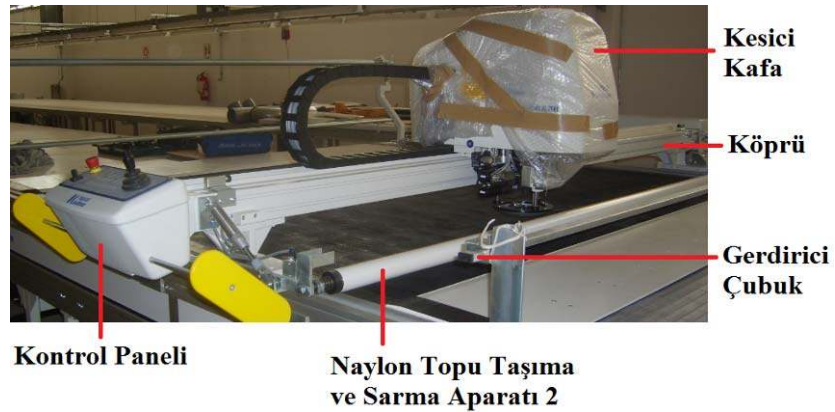
Şekil 3.13 Köprü bileşenleri genel görünümü (Çekim ve düzenleme: M.S.Ç.)
