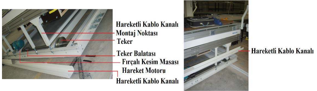
Şekil 3.54 Hareketli kablo kanalı (Çekim ve düzenleme: M.S.Ç.)
