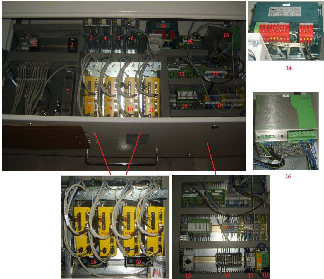
Şekil 3.69 CNC kasa bileşenleri (1: Bileme Taşlarının Kontaktörü, 2: Makinenin mekanik olarak ne kadar çalıştığını gösteren sayaç, 3,4,5,6: elektrik filtreleri (her biri için bir tane-8,9,10,11), 7: CNC kasayı besleyen elektrik filtre sistemi, 8,9,10,11:x,y,c,m sürücüler, 12,13: soğutma fanı, 14: termostat (iç sıcaklığı ölçüp 25-26°C yi aşınca klimayı çalıştırır.), 15: termik şalter, 16: cam sigorta paneli, 17: k1 kontaktör,18: acil stop rölesi, 19: priz, 20: röle paneli, 21,23: klemens, 22,25: klemensli kablo modülü (kablo olarak gelip fişe dönüşür.), 24: ismet marka trafo(110 volt üretir), 26: Quick Power trafo(24 volt üretir) (Çekim ve düzenleme: M.S.Ç.)
