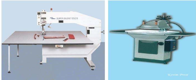
Şekil 1.7 Malzemeyi hareket ettirerek yapılan kesim: Hizar, giyotin makinesi
