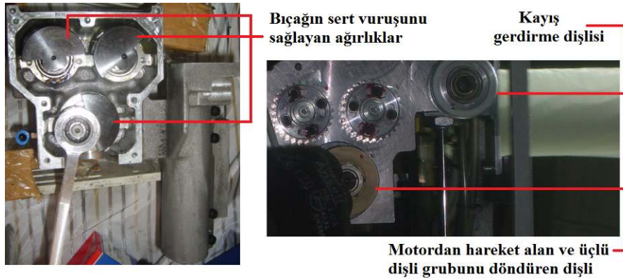
Şekil 3.18 Bıçak tahrik kutusu bileşenleri-2 (Çekim ve düzenleme: M.S.Ç.)
