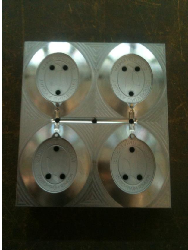
Şekil 5. 22: İmalatı tamamlanan erkek (itici taraf) kalıp çekirdeği.
