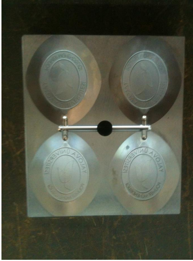
Şekil 5. 24: İmalatı tamamlanan dişi (enjeksiyon taraf) kalıp çekirdeği.
