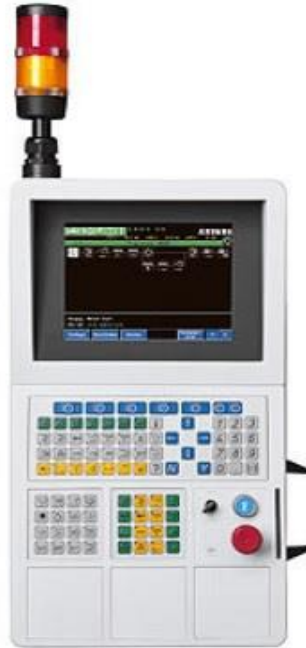
Şekil 3. 5: Enjeksiyon tezgahı kontrol ünitesi [22].
