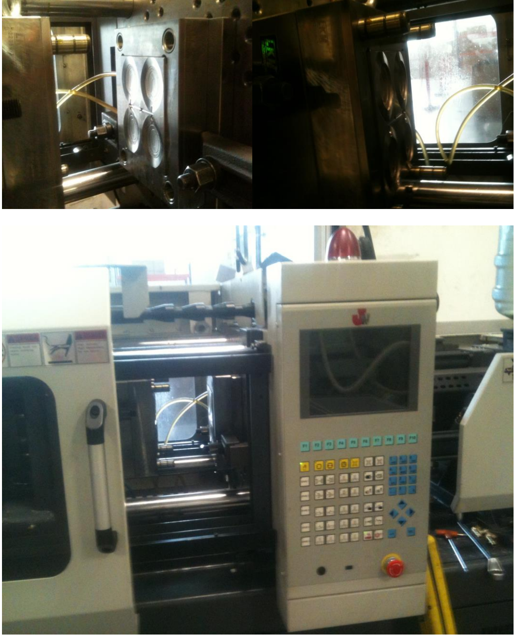
Şekil 5. 30: Deneme baskısı için enjeksiyon tezgahına bağlanması.
