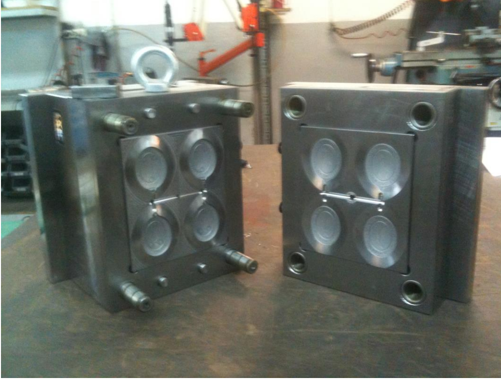
Şekil 5. 29: Kalıbın montajlanmış nihai hali.
