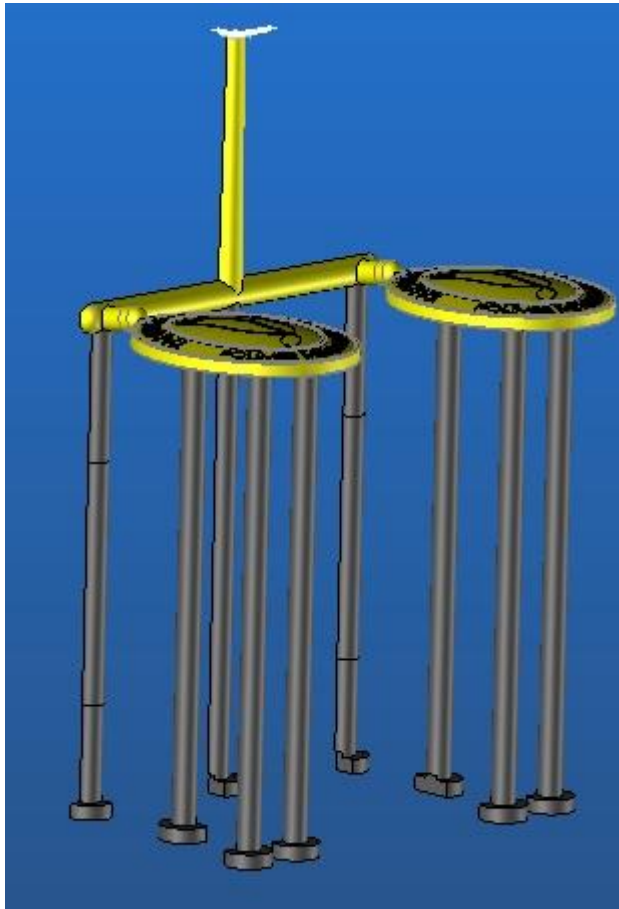
Şekil 5. 19: Kalıp imalat uygulaması için itici yerleşimi.
