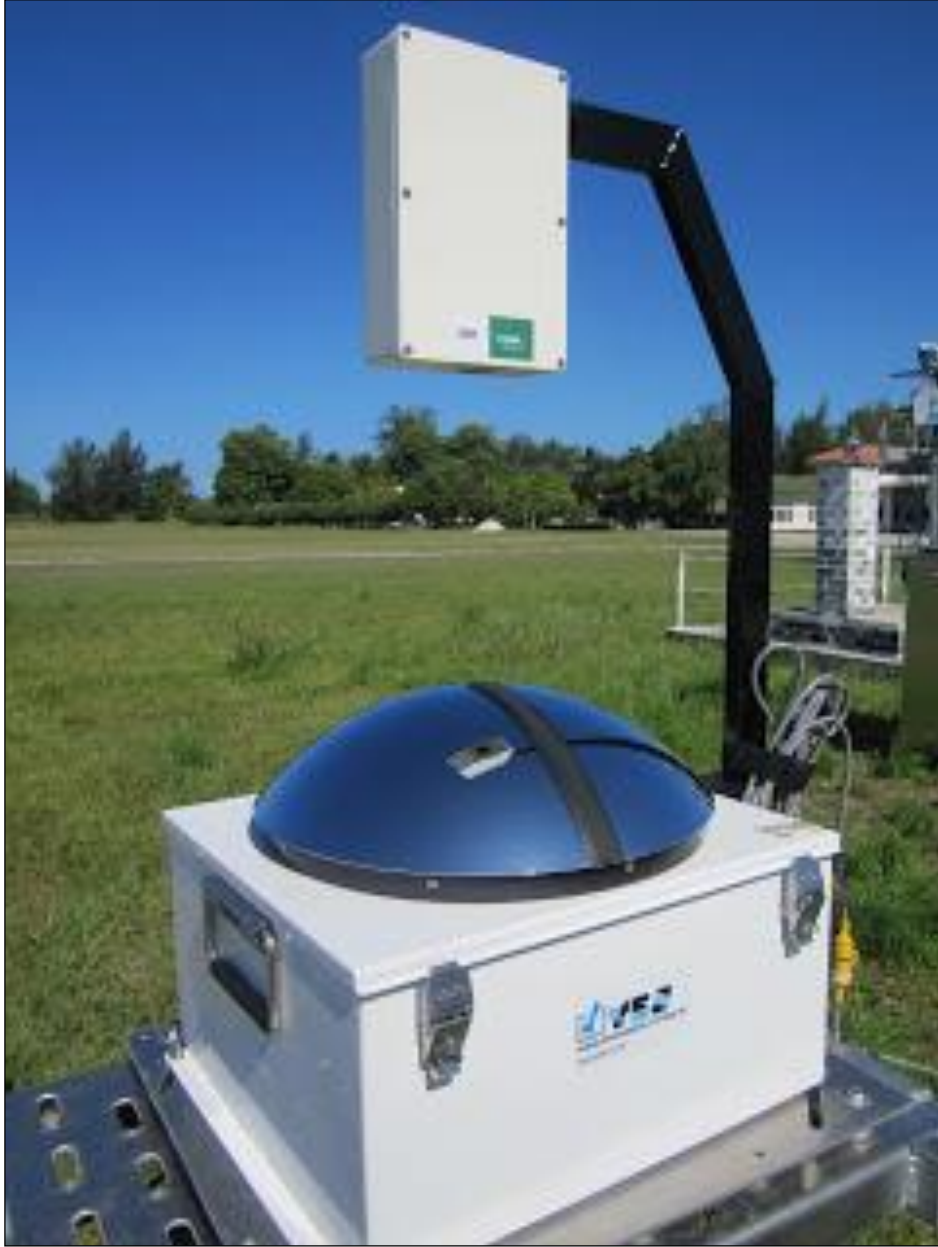
Şekil-6: Tümsek ayna yansıtmalı bir sistem örneği. [19]
