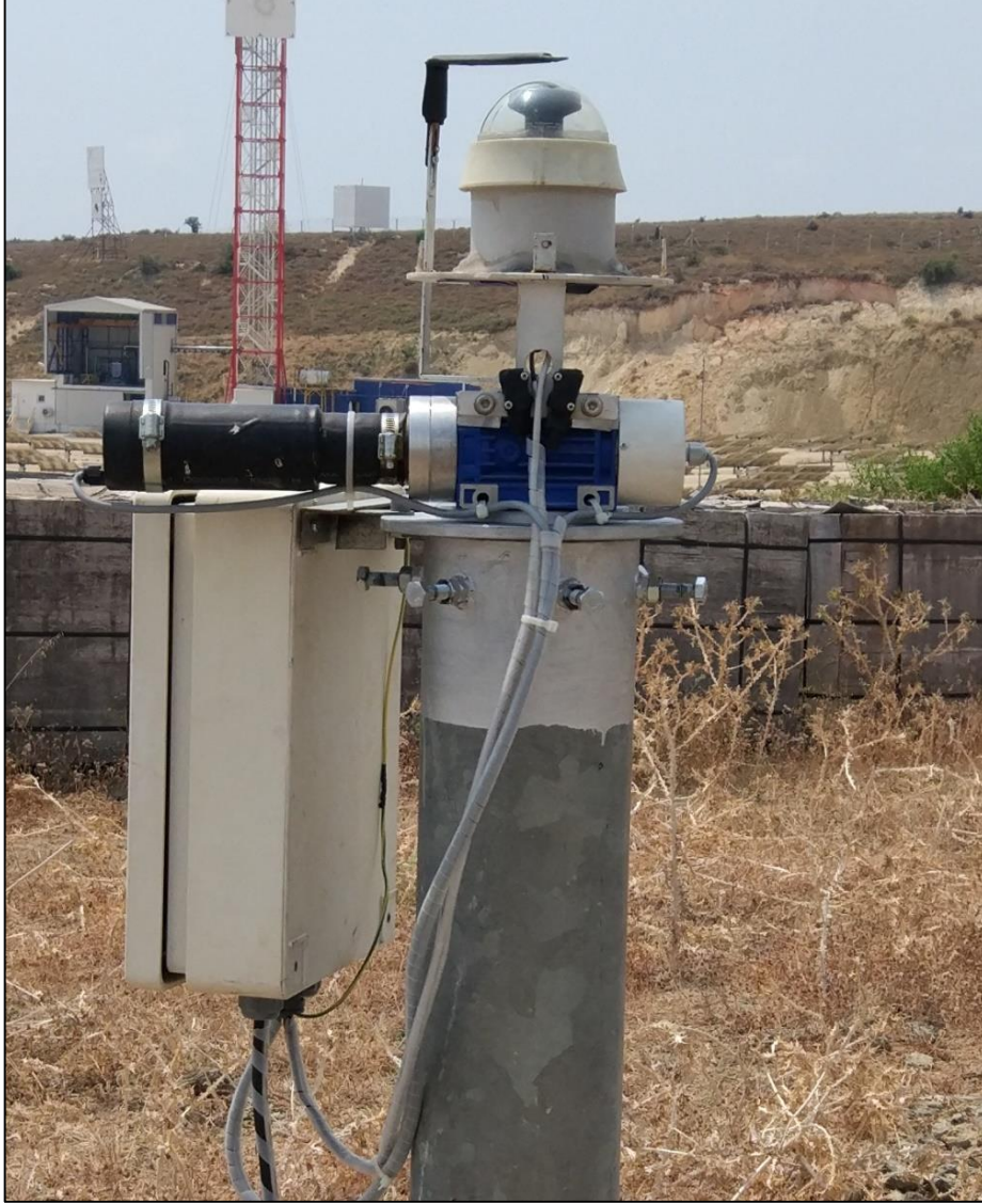
Şekil-7: Çalışmaya özgün olarak tasarlanan güneş kapatma mekanizması.
