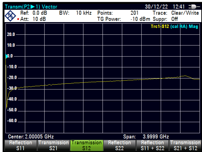
Şekil 4.67 PWM=44 için S12 karakteristiği
