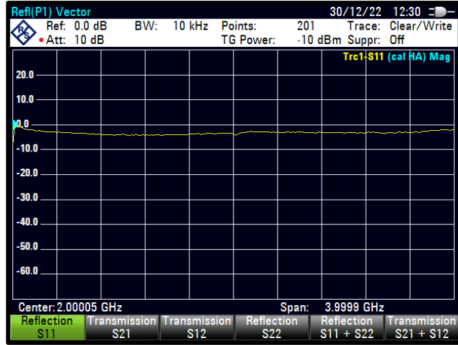
Şekil 4.35 PWM=32 için S11 karakteristiği
