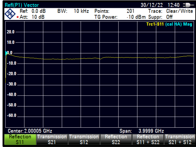
Şekil 4.65 PWM=44 için S11 karakteristiği
