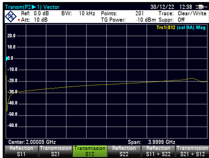
Şekil 4.57 PWM=40 için S12 karakteristiği
