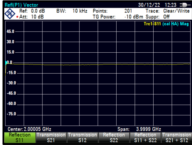
Şekil 4.25 PWM=28 için S11 karakteristiği
