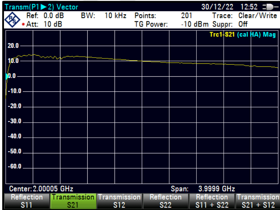
Şekil 4.104 PWM=60 için S21 karakteristiği
