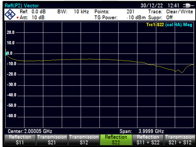
Şekil 4.66 PWM=44 için S22 karakteristiği
