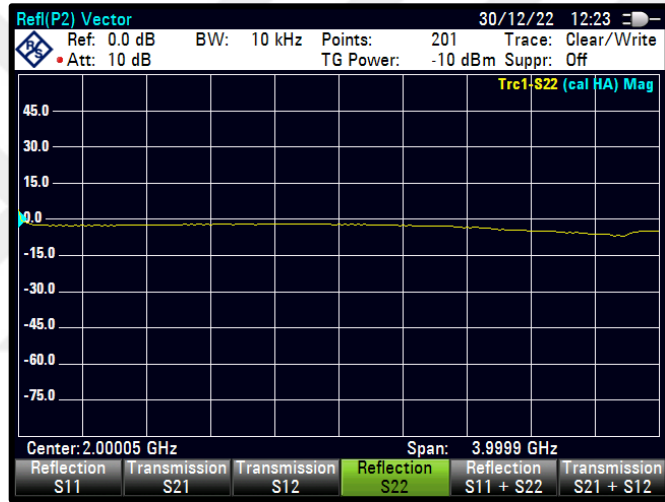
Şekil 4.26 PWM=28 için S22 karakteristiği
