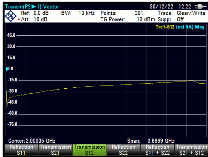
Şekil 4.22 PWM=26 için S12 karakteristiği
