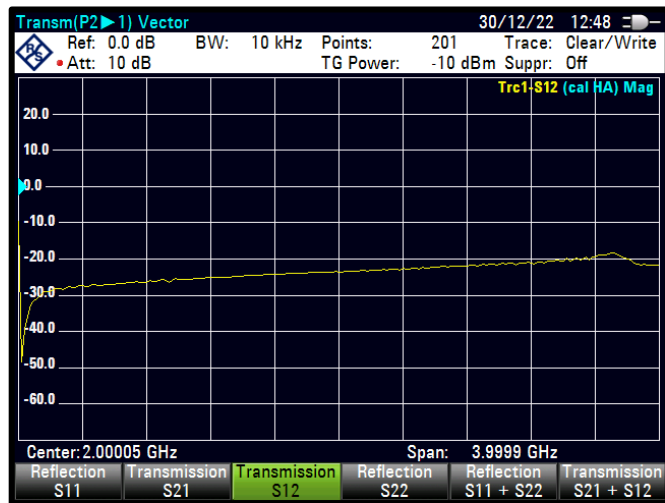
Şekil 4.92 PWM=54 için S12 karakteristiği
