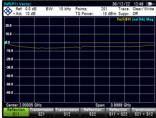
Şekil 4.95 PWM=56 için S11 karakteristiği
