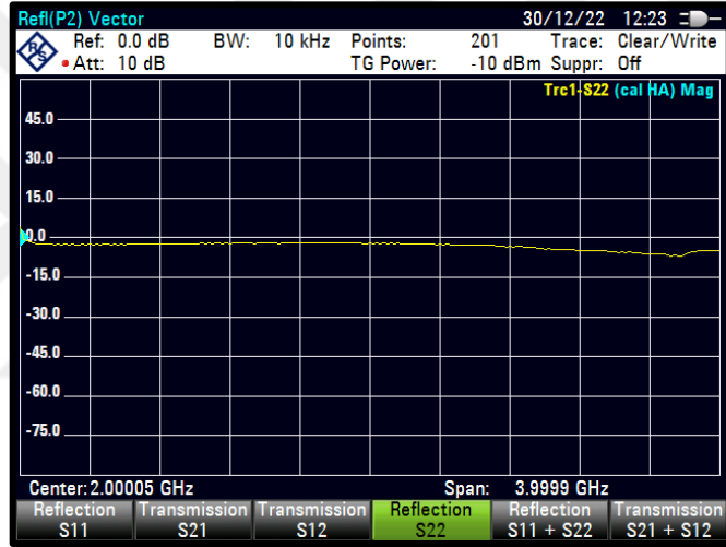
Şekil 4.21 PWM=26 için S22 karakteristiği
