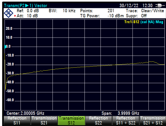
Şekil 4.37 PWM=32 için S12 karakteristiği
