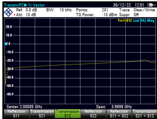
Şekil 4.102 PWM=58 için S12 karakteristiği
