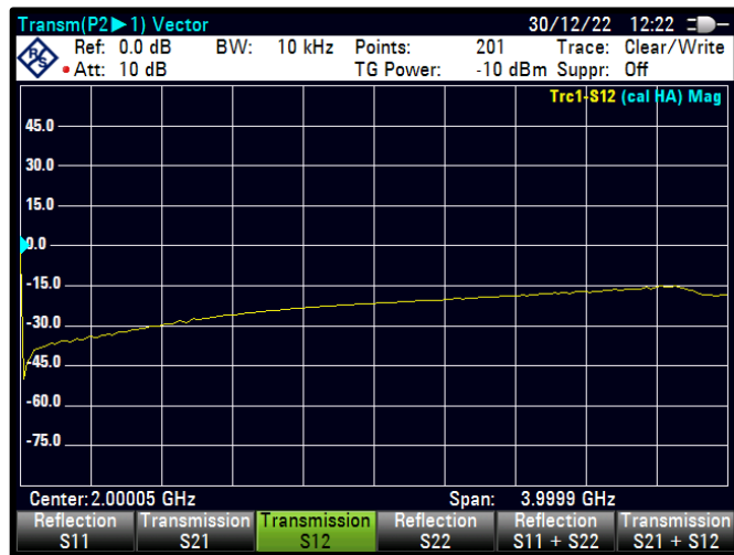
Şekil 4.17 PWM=24 için S12 karakteristiği
