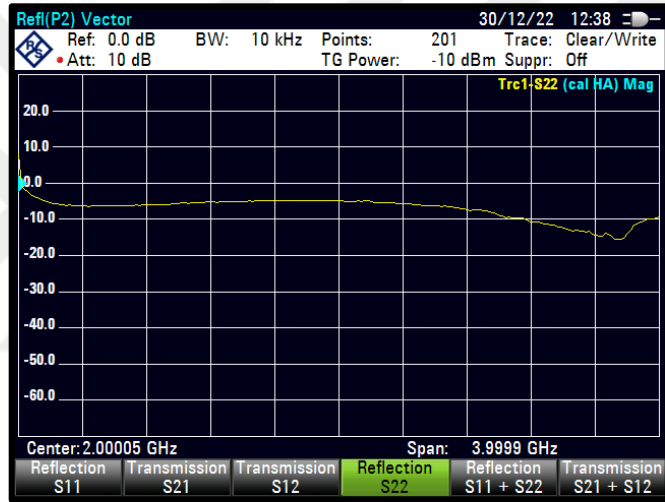
Şekil 4.56 PWM=40 için S22 karakteristiği
