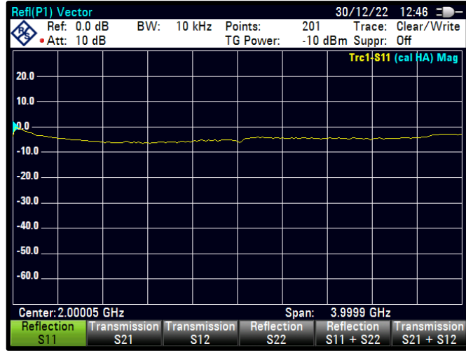
Şekil 4.85 PWM=52 için S11 karakteristiği
