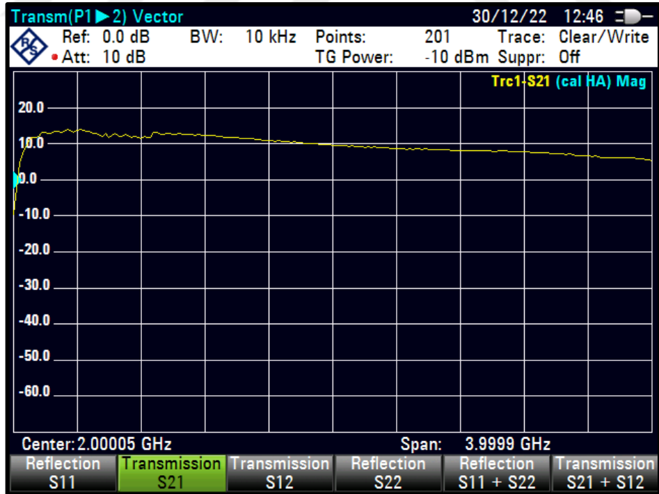
Şekil 4.79 PWM=50 için S21 karakteristiği
