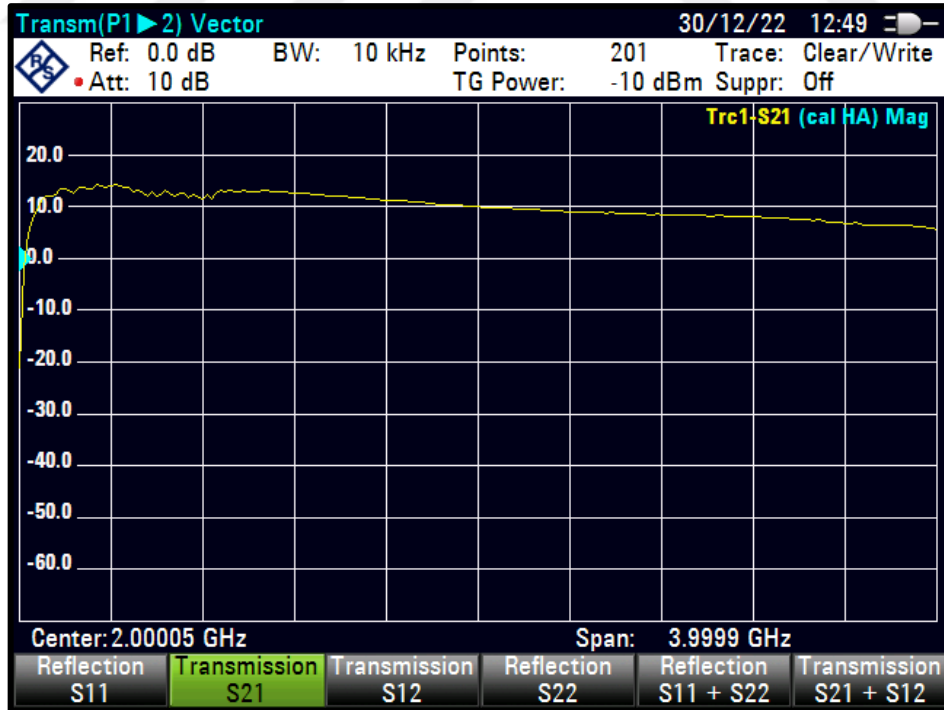
Şekil 4.94 PWM=56 için S21 karakteristiği
