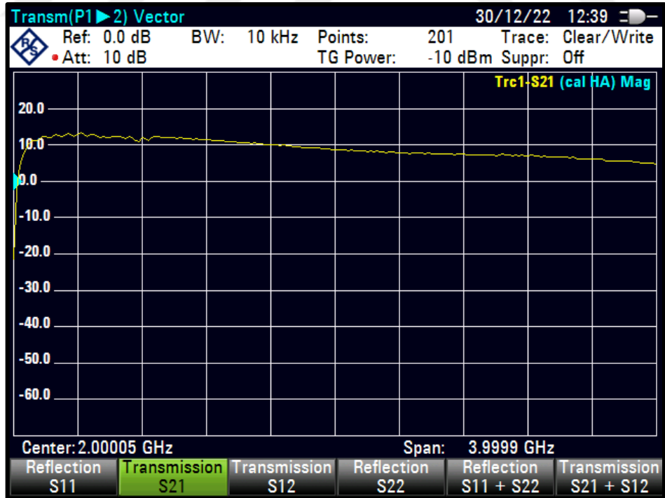
Şekil 4.59 PWM=42 için S21 karakteristiği
