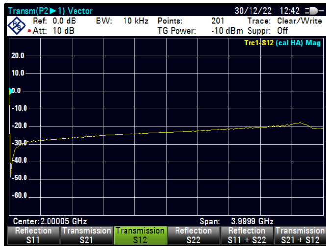
Şekil 4.72 PWM=46 için S12 karakteristiği
