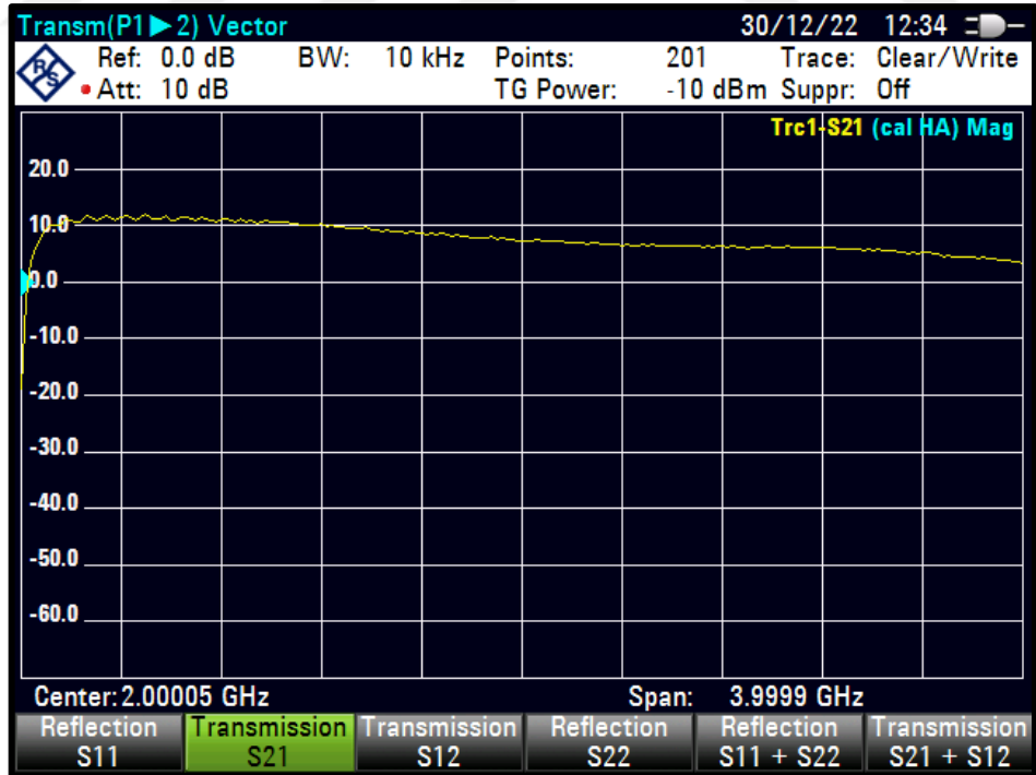
Şekil 4.44 PWM=36 için S21 karakteristiği
