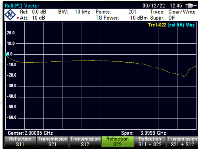
Şekil 4.81 PWM=50 için S22 karakteristiği
