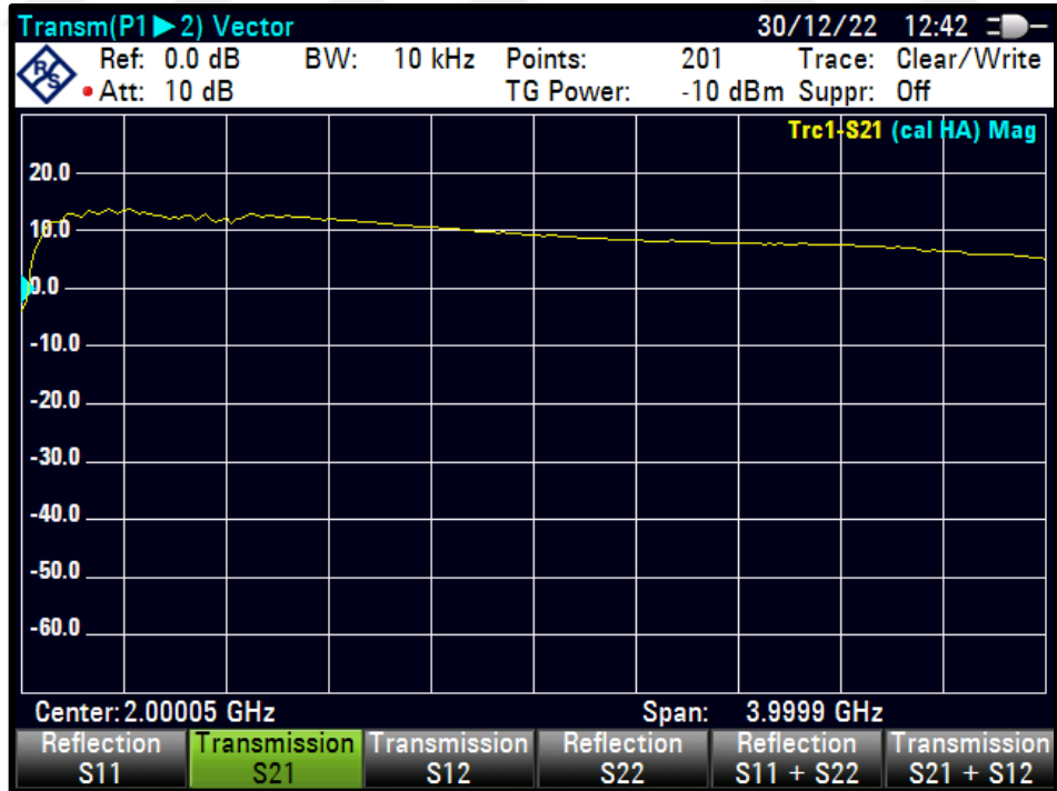
Şekil 4.69 PWM=46 için S21 karakteristiği
