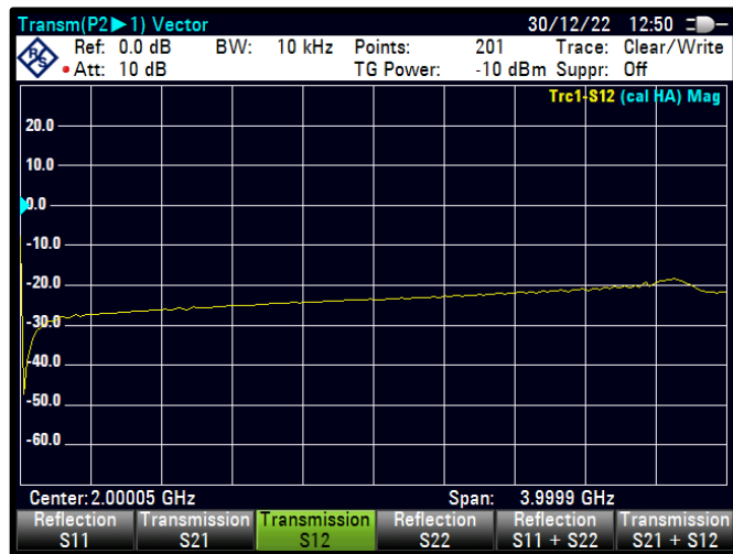
Şekil 4.97 PWM=56 için S12 karakteristiği
