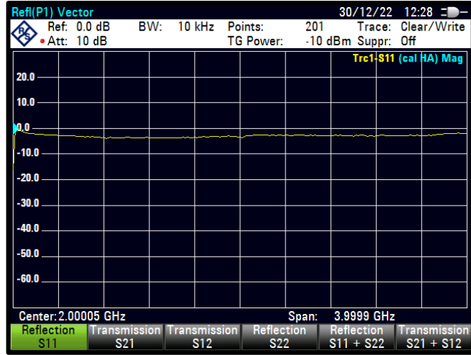
Şekil 4.30 PWM=30 için S11 karakteristiği
