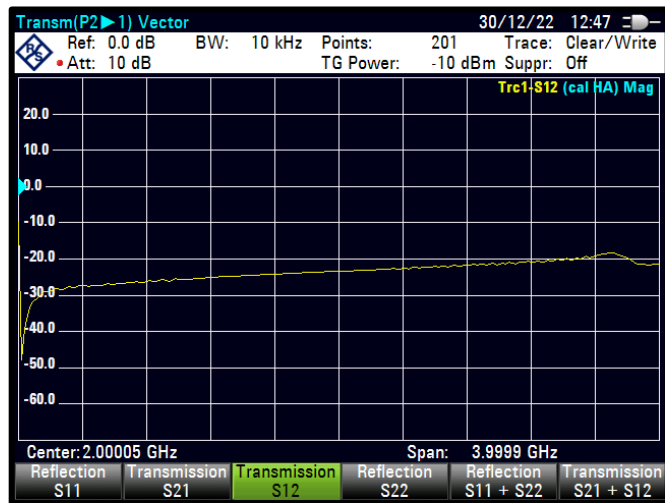
Şekil 4.87 PWM=52 için S12 karakteristiği
