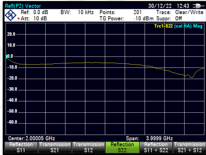
Şekil 4.71 PWM=46 için S22 karakteristiği
