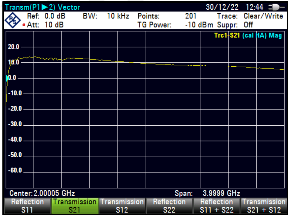
Şekil 4.74 PWM=48 için S21 karakteristiği
