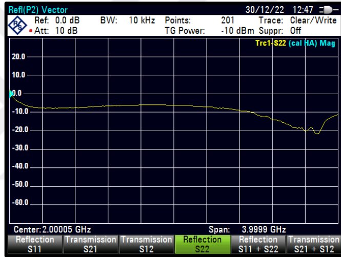
Şekil 4.86 PWM=52 için S22 karakteristiği
