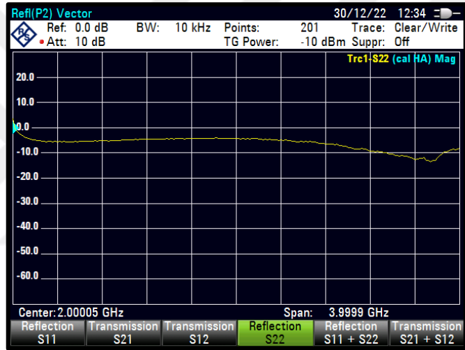
Şekil 4.46 PWM=36 için S22 karakteristiği
