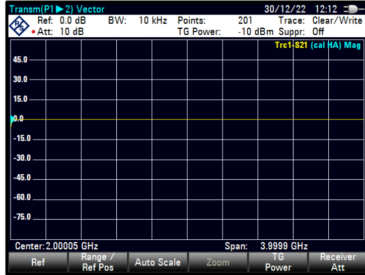
Şekil 4.2 VNA cihazının kalibre edilmesi
