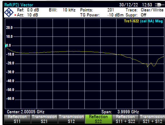
Şekil 4.106 PWM=60 için S22 karakteristiği
