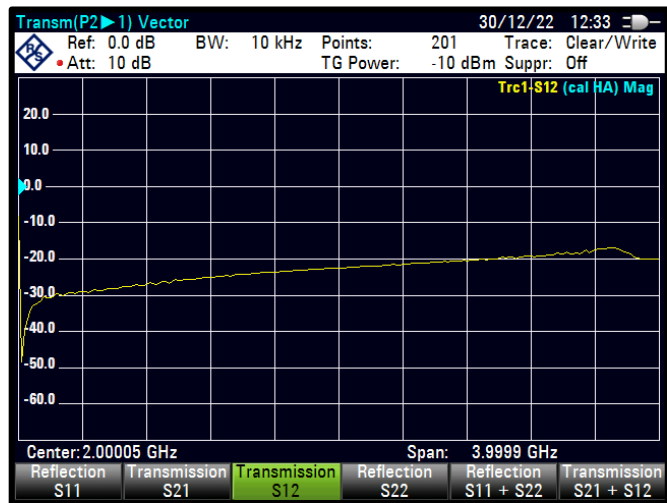
Şekil 4.47 PWM=36 için S12 karakteristiği
