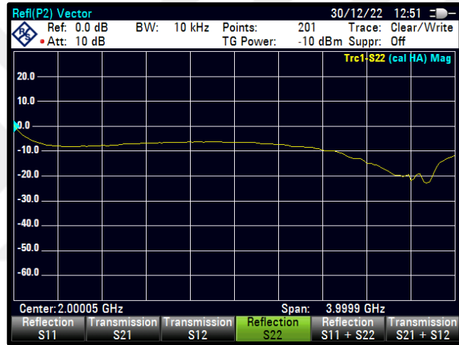
Şekil 4.101 PWM=58 için S22 karakteristiği
