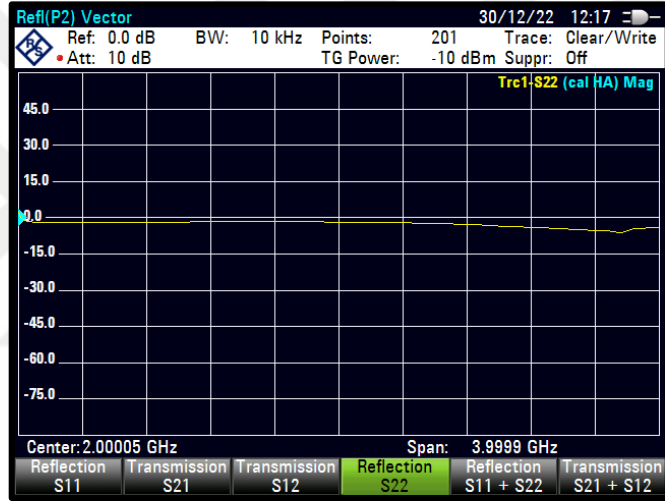
Şekil 4.6 PWM=20 için S22 karakteristiği
