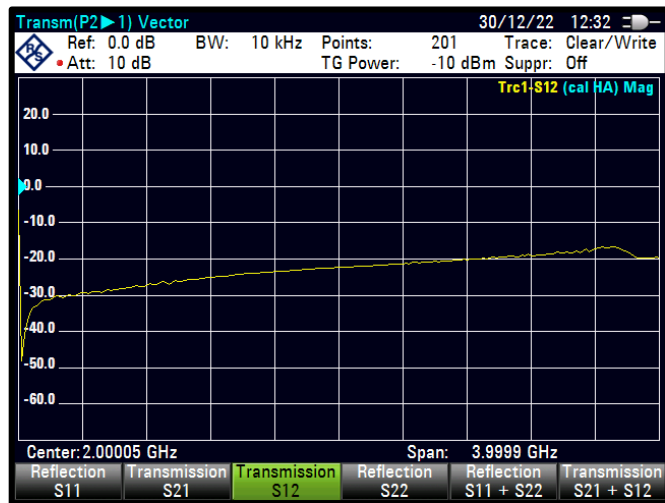
Şekil 4.42 PWM=34 için S12 karakteristiği
