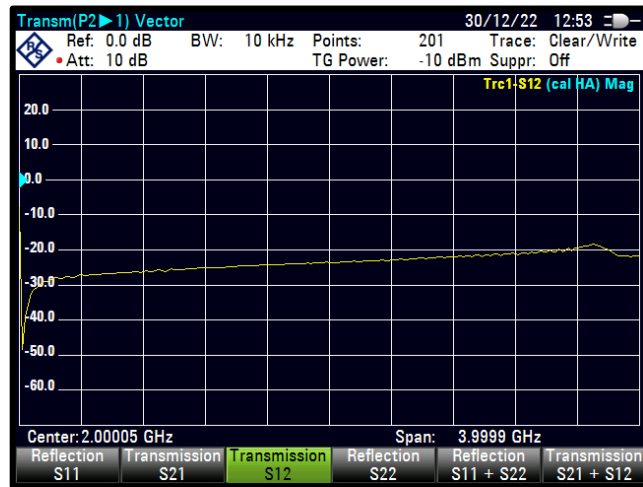
Şekil 4.107 PWM=60 için S12 karakteristiği
