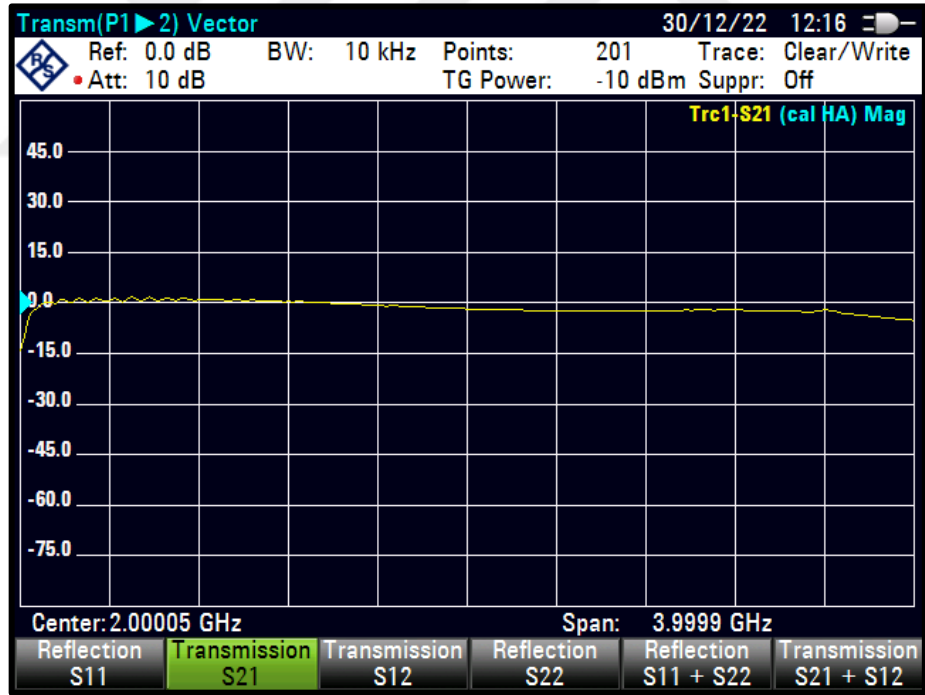
Şekil 4.4 PWM=20 için S21 karakteristiği
