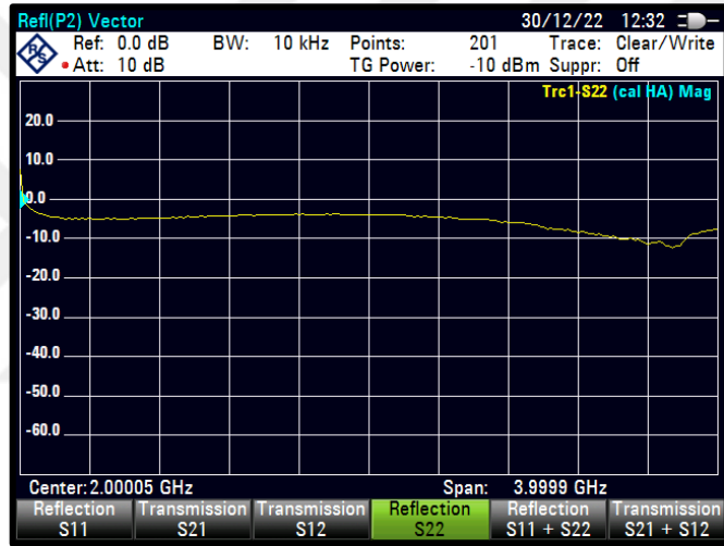
Şekil 4.41 PWM=34 için S22 karakteristiği
