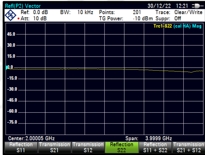
Şekil 4.16 PWM=24 için S22 karakteristiği
