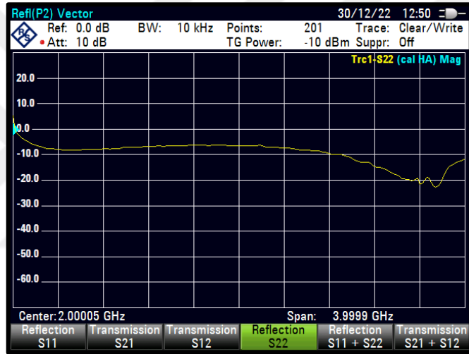
Şekil 4.96 PWM=56 için S22 karakteristiği
