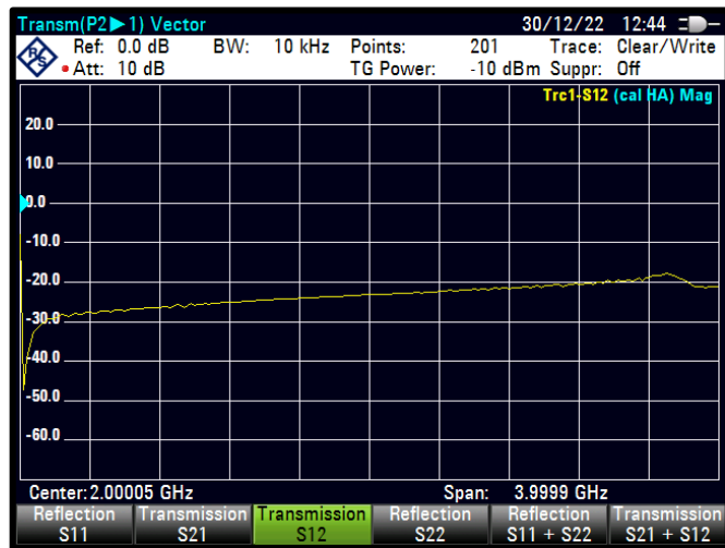
Şekil 4.77 PWM=48 için S12 karakteristiği
