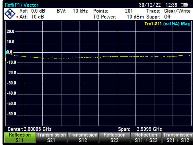
Şekil 4.60 PWM=42 için S11 karakteristiği
