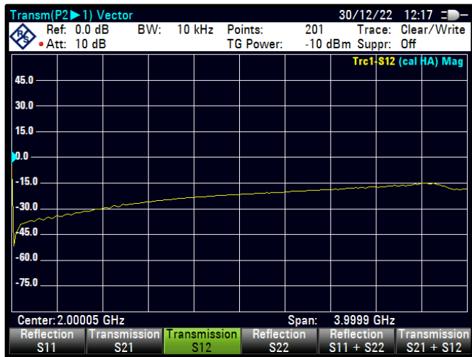
Şekil 4.7 PWM=20 için S12 karakteristiği
