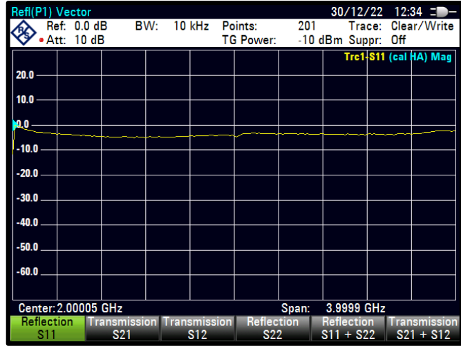
Şekil 4.45 PWM=36 için S11 karakteristiği
