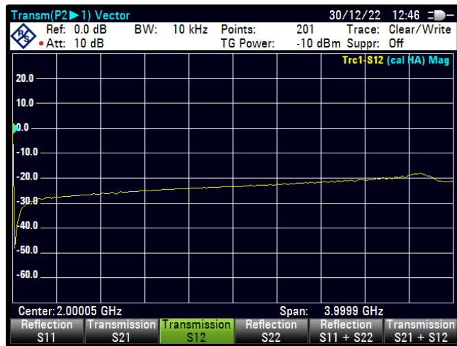
Şekil 4.82 PWM=50 için S12 karakteristiği
