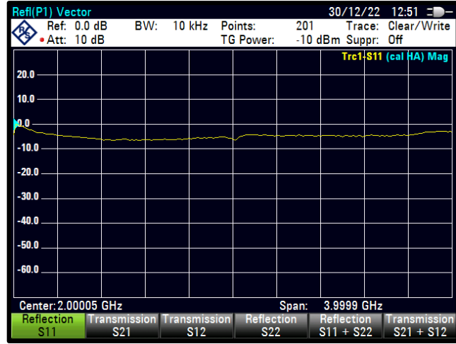
Şekil 4.100 PWM=58 için S11 karakteristiği
