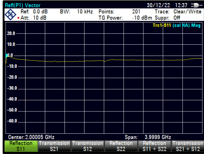
Şekil 4.55 PWM=40 için S11 karakteristiği
