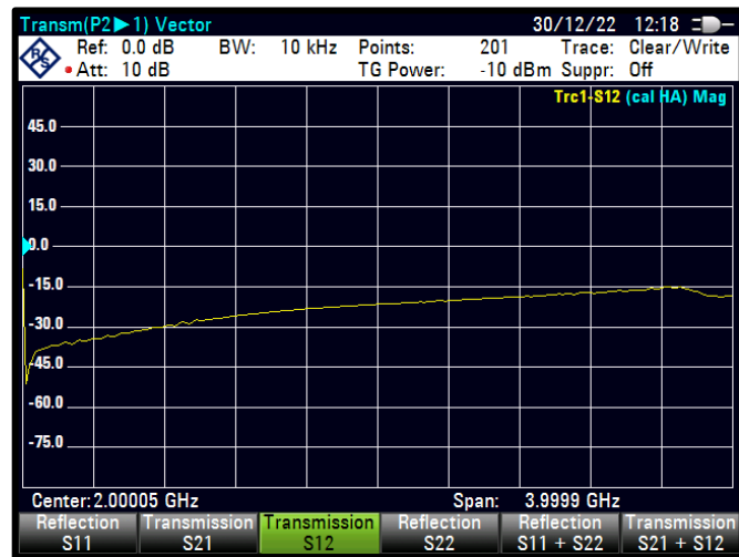
Şekil 4.12 PWM=22 için S12 karakteristiği
