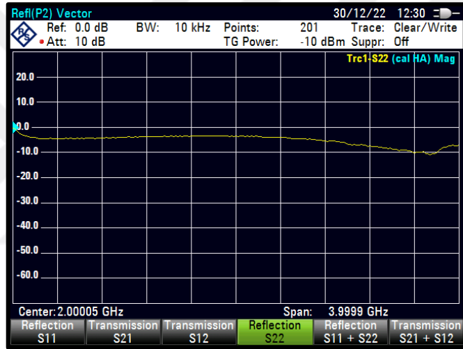
Şekil 4.36 PWM=32 için S22 karakteristiği
