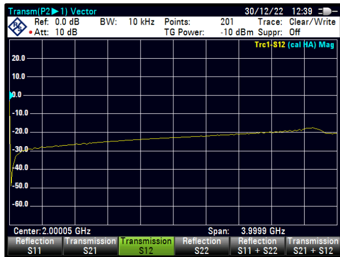
Şekil 4.62 PWM=42 için S12 karakteristiği
