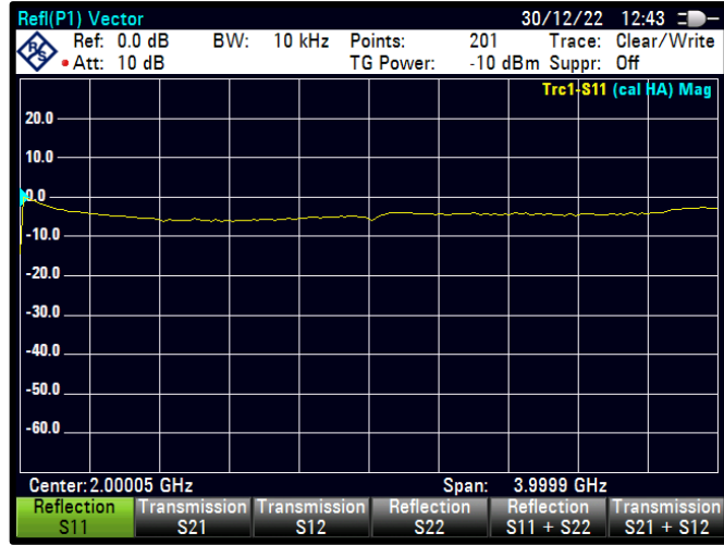
Şekil 4.75 PWM=48 için S11 karakteristiği
