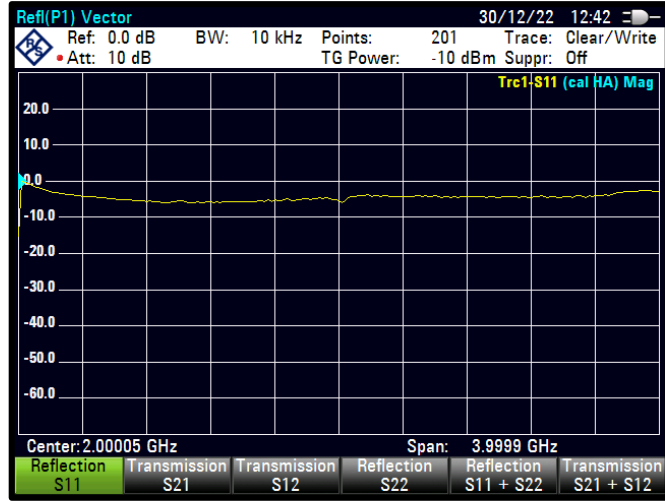
Şekil 4.70 PWM=46 için S11 karakteristiği
