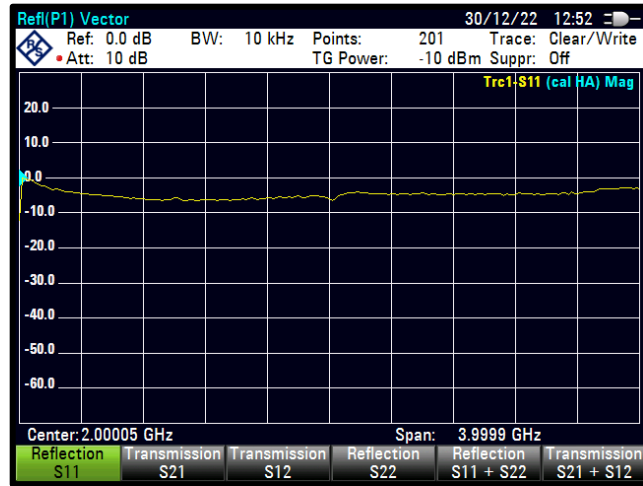
Şekil 4.105 PWM=60 için S11 karakteristiği
