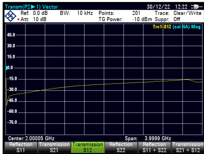
Şekil 4.27 PWM=28 için S12 karakteristiği
