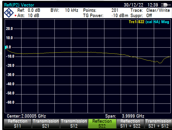
Şekil 4.61 PWM=42 için S22 karakteristiği
