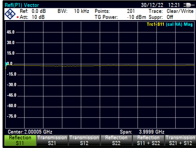
Şekil 4.15 PWM=24 için S11 karakteristiği
