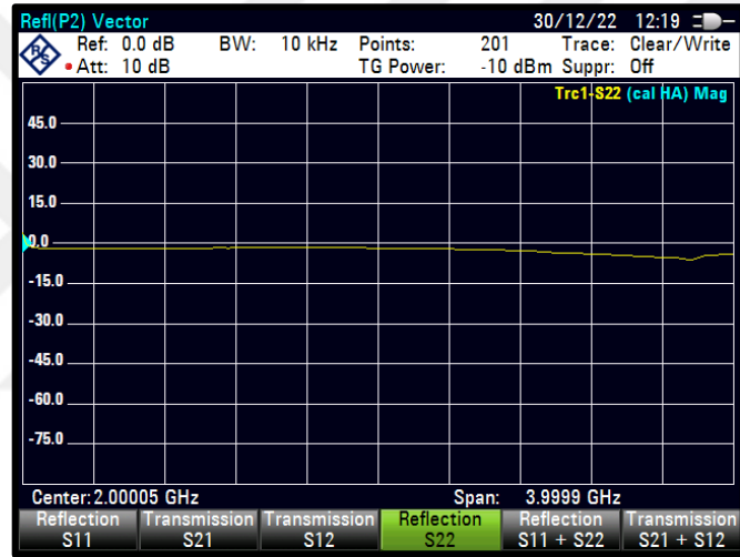
Şekil 4.11 PWM=22 için S22 karakteristiği
