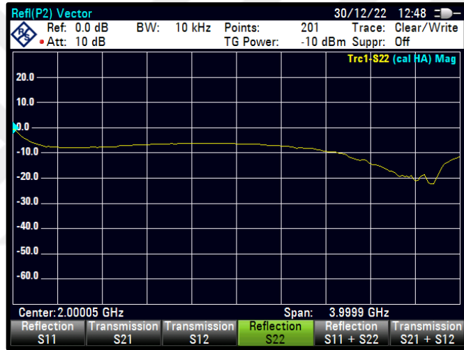
Şekil 4.91 PWM=54 için S22 karakteristiği
