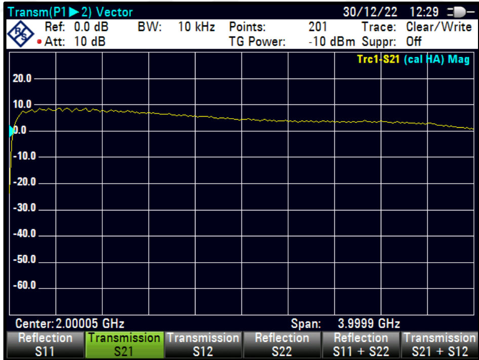
Şekil 4.29 PWM=30 için S21 karakteristiği
