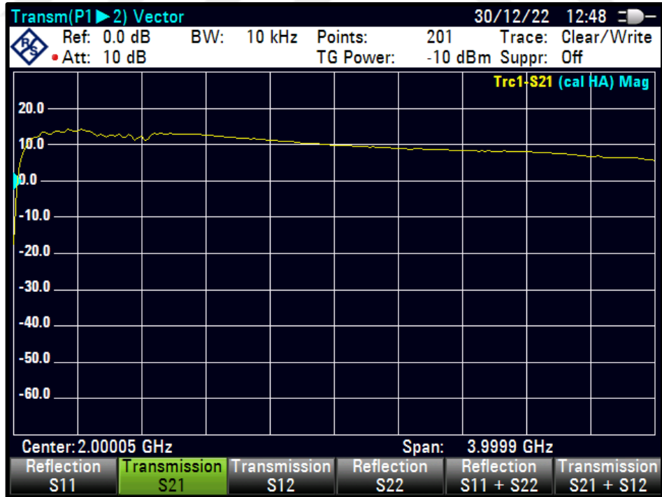
Şekil 4.89 PWM=54 için S21 karakteristiği.
