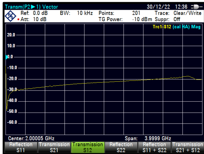
Şekil 4.52 PWM=38 için S12 karakteristiği
