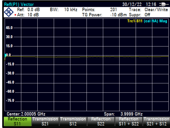
Şekil 4.5 PWM=20 için S11 karakteristiği
