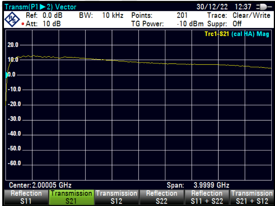
Şekil 4.54 PWM=40 için S21 karakteristiği
