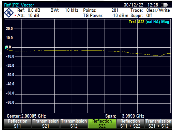
Şekil 4.31 PWM=30 için S22 karakteristiği
