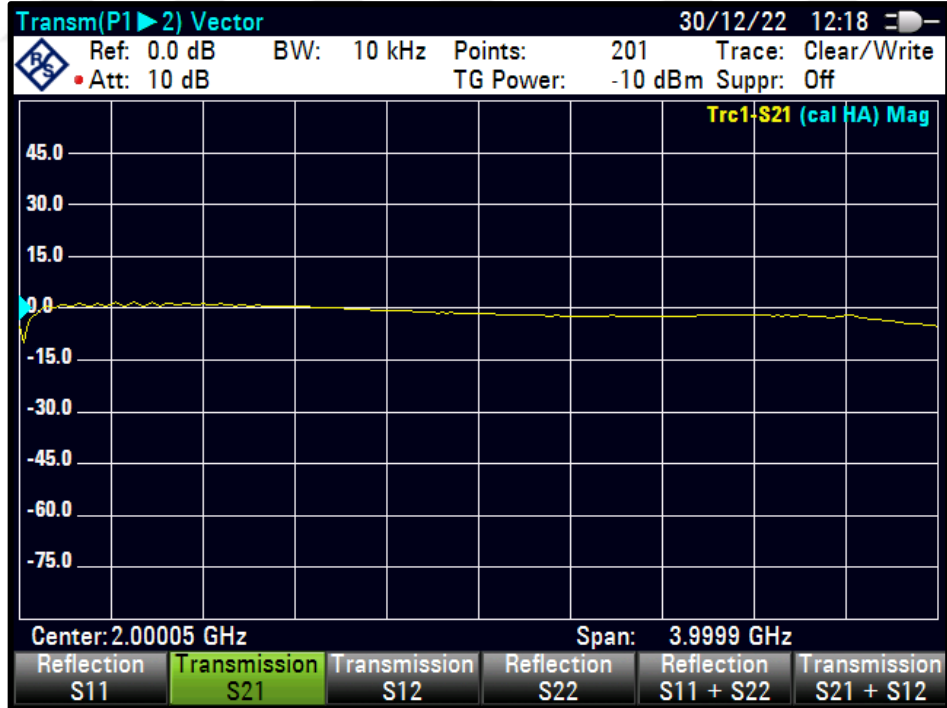
Şekil 4.9 PWM=22 için S21 karakteristiği
