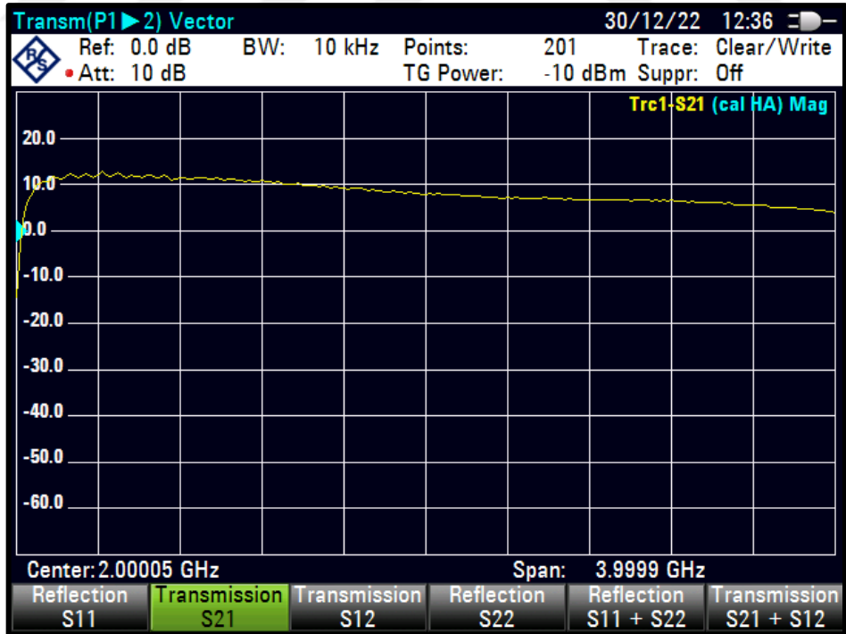
Şekil 4.49 PWM=38 için S21 karakteristiği
