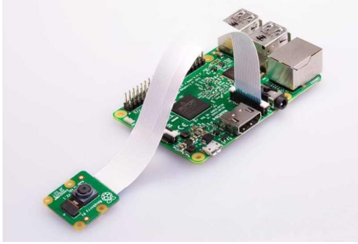
Şekil 3.4: Raspberry Pi ve kamera bağlantısı ( Raspberry Pi Organization, 2018).
