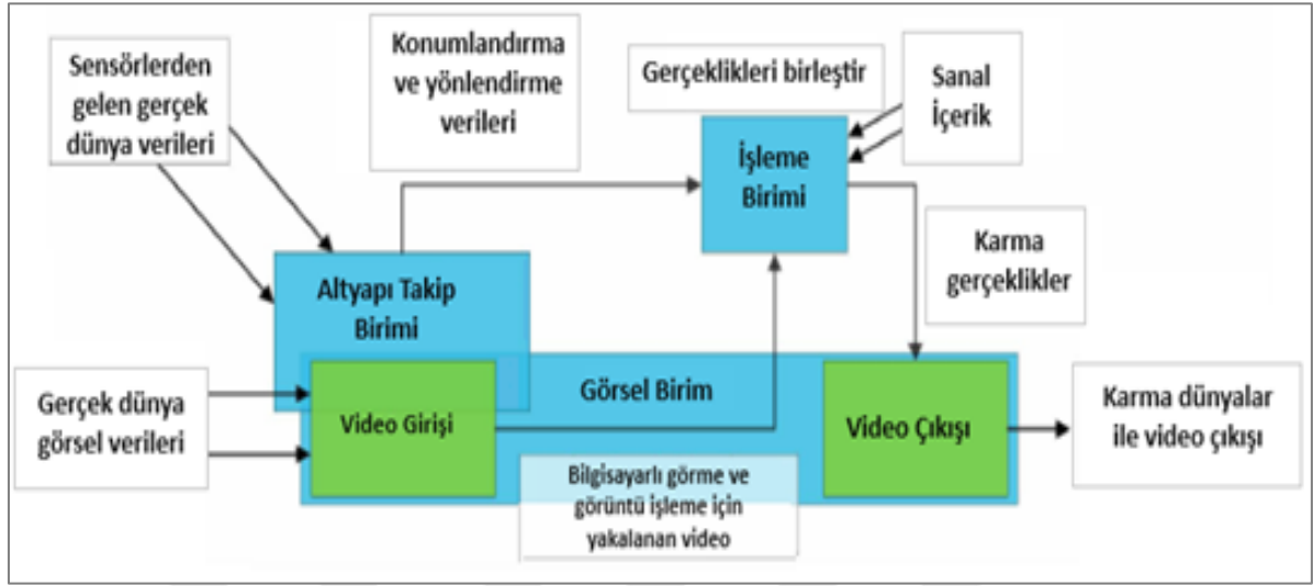
Şekil 5. AG Teknolojisinin Çalışma Şeması (Kirner vd., 2012, s. 247)
